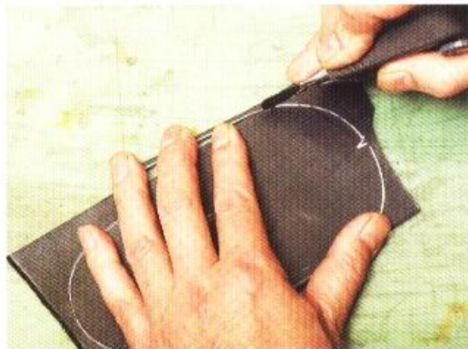
開始剪裁工作，可以依照自己的喜好與使用的容易度來選擇刀具。LEATHER CRAFT MACK的萩原老師對於有R線的部分選擇使用的是美工刀。
