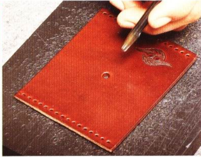
主體與皮帶的固定釦孔、皮帶孔、袋身的飾釦孔都用丸斬來進行鑽孔工作。
