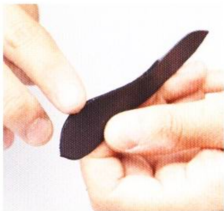
15 在毛邊上塗抹CMC。請注意，不要讓CMC超出毛邊跑到光滑面上。
