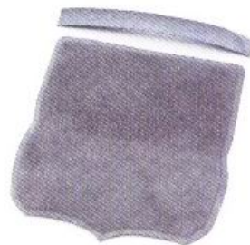
3 這是削薄工作已經完成的配件。如果不進行削薄工作的話，重疊部分就會變得太厚。
