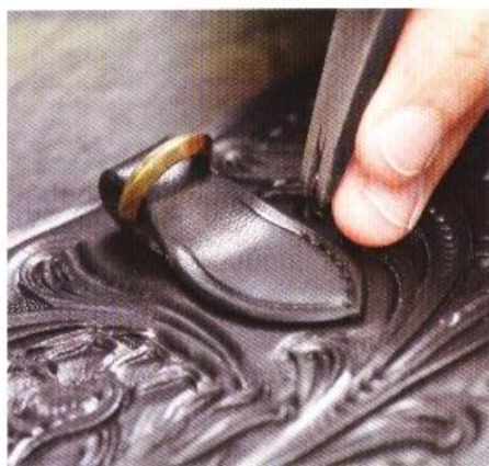
42 在邊線器拉出來的縫線上，非常輕地敲打菱斬。
