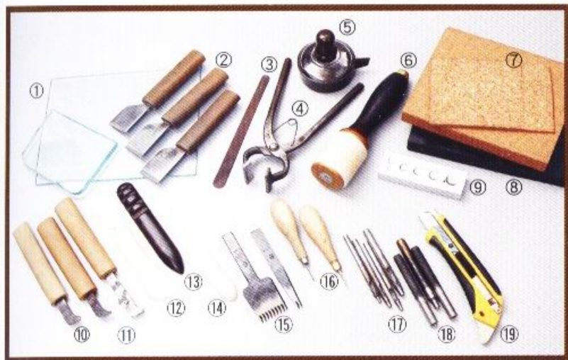
①玻璃板②皮革裁刀③磨砂棒④酒精燈⑤口金鉗⑥Pu頭木槌⑦軟木板⑧橡膠板⑨萬用環狀台⑩裝飾邊線器⑪邊線器⑫牛骨上膠片⑬木製修邊器⑭三用磨緣器⑮菱形錐⑯圓錐・菱形錐⑰丸斬⑱四合鉗工具・牛仔鉗工具⑲美工刀
