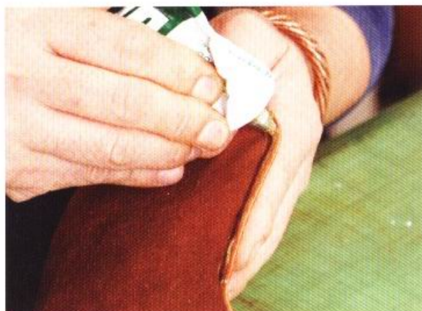
8 在主體A塗抹接著劑(在這裡要使用快乾膠)，蓋口的部分不要塗。
