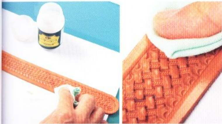
21 牛腳油充分浸透之後，為了防染，請確實塗上皮革亮光乳液。
