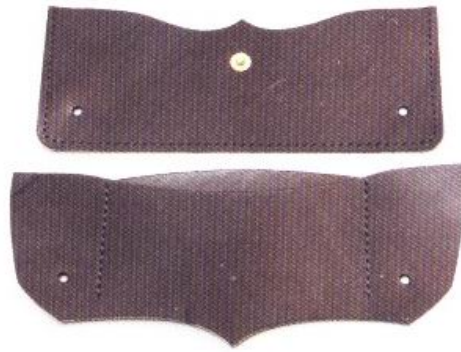
48 在卡片夾E與零錢包B上鑽出要安裝牛仔釦的孔。
