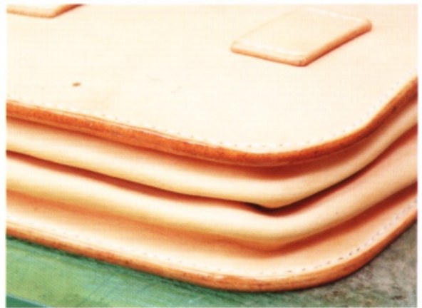
21 將主體A與邊皮已經縫合起來的毛邊，用到目前為止的相同方法去處理。邊油要重複塗抹三次以上。
