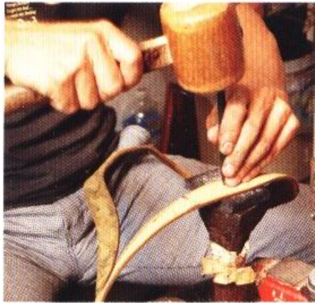
22 用丸斬鑽出鉚釘孔，鉚釘孔的大小要確實配合預備使用的鉚釘尺寸。如果鉚釘孔有所偏差的話，在安裝鉚釘時皮革就會彎曲，所以請注意。
