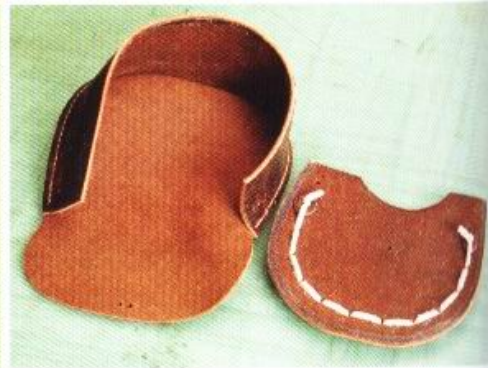
1 在主體B與邊皮上塗抹接著劑。在這裡使用的是橡膠類的快乾膠，所以要等著劑呈現半乾燥的狀態。
