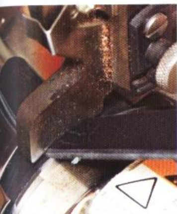
7 安裝帶釦的部分要削薄來減低厚度。
