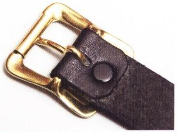
17 這是製作完成的帶釦部分。全部的帶釦都用固定釦來固定。
