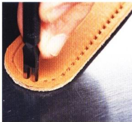
7 用菱斬在拉出縫線的表皮上進行敲打工作。尖端呈現曲線的地方要使用雙菱斬來敲打。接近結尾的地方也要使用雙菱斬來調整間隔。
