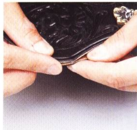
12 如果有好好地剪裁的話，稜角應該也會對齊才對。如果無法對齊的話，請進行切割工作來修正皮革。
