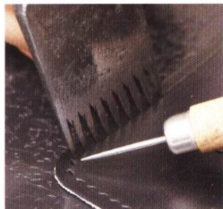
20 敲打兩端之後，正中央部分的縫線孔就會一點一點地挪動，最後要調整成間隔可以剛好相稱的距離。
