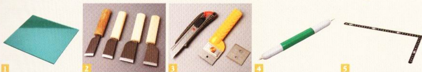
1 塑膠板 2 皮革裁刀 3 美工刀或替刃式裁刀 4 描寫筆或圓錐 5 曲尺
