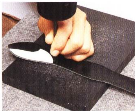
13 將皮革放置在橡膠板上，利用橡皮槌敲打雙菱斬，並配合記號來進行鑽孔工作。
