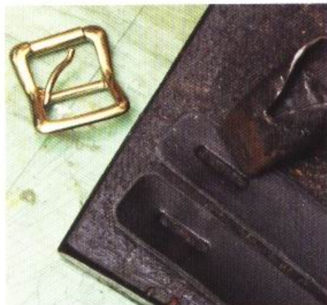
8 配合帶釦的大小，用帶釦斬來鑽出長型孔。
