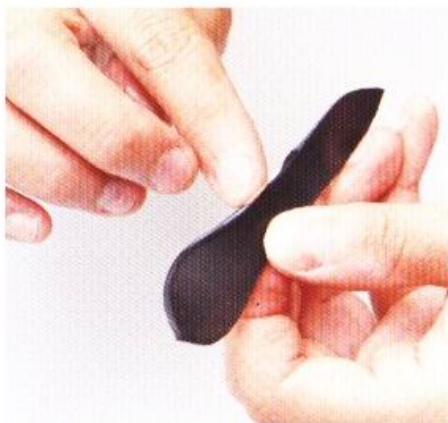
19 在已染色的毛邊上塗抹背面處理劑。請謹慎地塗抹，不要讓背面處理劑跑到光滑面。
