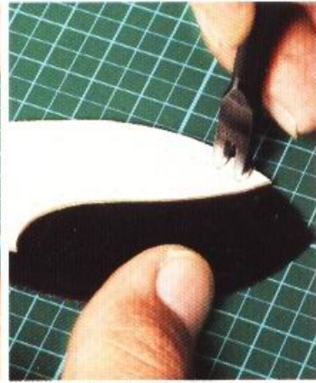
11 在要敲打菱斬的位置上做記號。在縫線孔集合點的地方做出基準點的記號的話，間隔會比較容易相稱。
