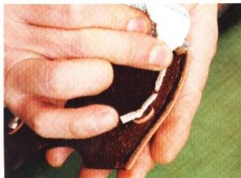
1 在主體B與邊皮上塗抹接著劑。在這裡使用的是橡膠類的快乾膠，所以要等著劑呈現半乾燥的狀態。
