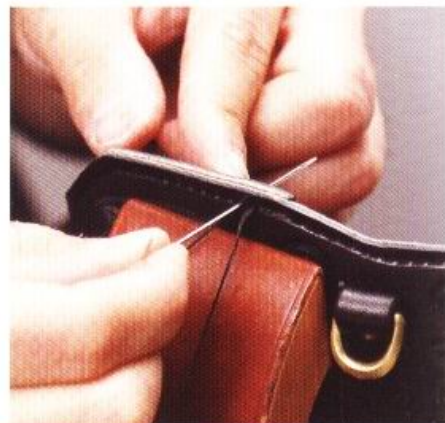
15 將主體與卡片夾縫合起來。零錢包部分也要進行相同的縫合工作。
