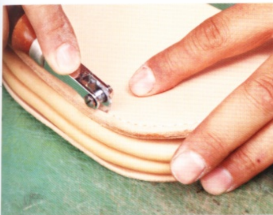
17 沿著接縫滾動間距輪來壓住縫線。
