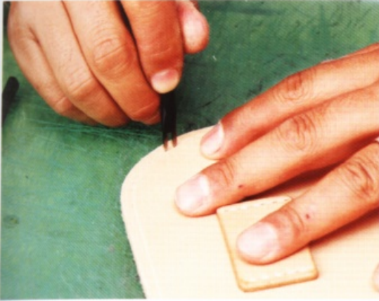
16 接下來在主體A的下部用菱斬來進行鑽孔工作。在敲打菱斬之前，可以先做記號來確認縫線孔的位置。
