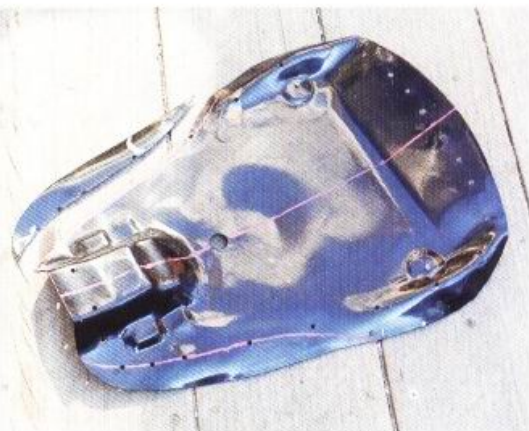
9 使用研磨機來切割鋼板，這裡請注意不要受傷了。如果不打算改變形狀，只是要更新皮革的話，就不需要進行這個工作。
