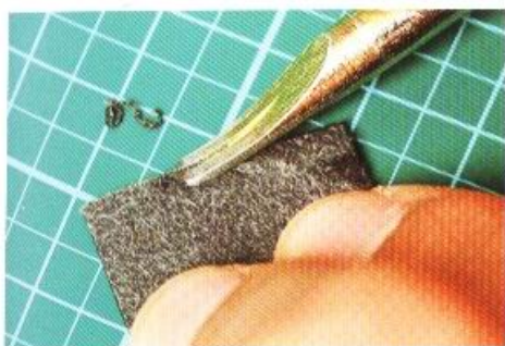
3 因為和主體A貼合之後就會無法處理，所以要先處理主體B短邊部分的毛邊。用削邊器削掉表面與背面的邊緣，並在毛邊上塗抹黑色染料，染料乾了之後，用磨緣器打磨來呈現出光澤。磨緣器可以靈活運用溝槽與平面，這樣打磨工作的進行會比較快速。
