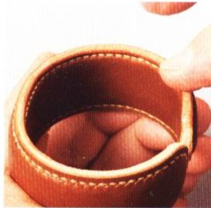
18 在削掉邊緣的毛邊上塗抹背面處理劑，再用帆布打磨。太用力磨擦的話，反而會起毛，所以請注意。
