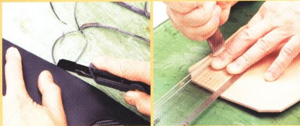
如果要讓重疊皮革均勻一致的話，在這裡使用美工刀，切割工作會比較簡單。並非一定都要使用皮革裁刀，能夠根據自己的程度或是製作的部位來靈活運用工具也是很重要的一件事。另外，剪裁直線的時候，刀鋒是朝向外側，沿著曲尺往自己的方向拉的話，就可以切割出漂亮的直線。
