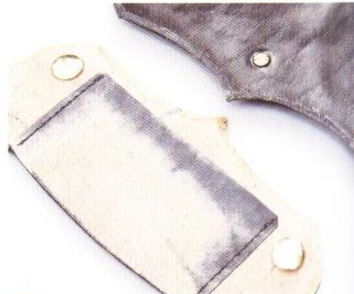
9 將卡片夾D與主體貼合起來，並在兩側的邊緣都塗上接合劑。
