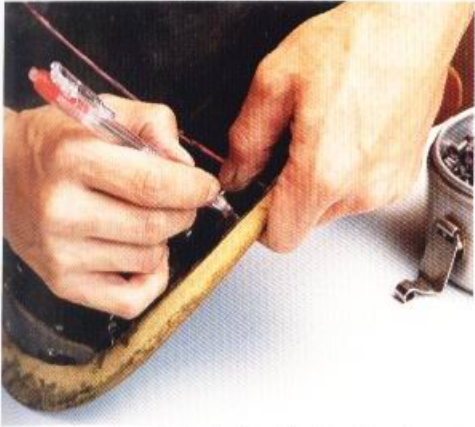
21 對齊鋼板的中心與墊圈的中心並壓住，在墊圈上描繪出鉚釘孔的位置。
