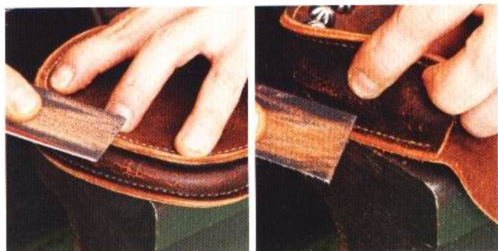
1 讓毛邊的稜角像脫落一般，用240號砂紙傾斜地打磨毛邊。請注意不要削到縫線與邊皮。
