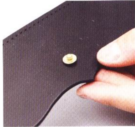
45 再從裡面安裝的母釦上面再安裝上母釦。
