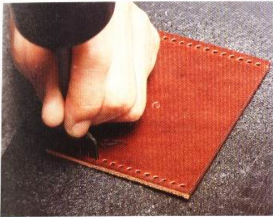
9 將配件放置在橡膠板上，沿著剛才做出來的縫線孔做記號，再用橡皮槌敲打菱斬。
