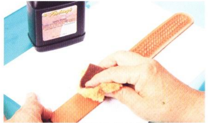
20 為了要補充和水分乾燥時所一起蒸發掉的油脂，需要塗抹牛腳油。如果塗抹太多的話，皮革就會變得太軟，所以請小心注意。
