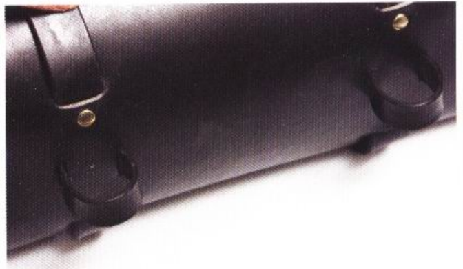
40 在這裡是製作要固定在縱向車體部分的皮帶，但是如果改變皮帶孔位置的話，就也能成為固定在橫向部分的皮帶。
