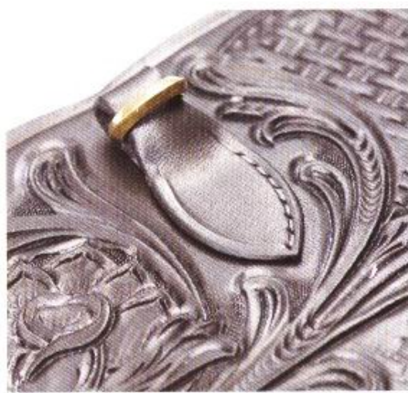
43 最後一個孔不要敲打，只要做記號即可。在這裡要用圓斬來鑽孔。
