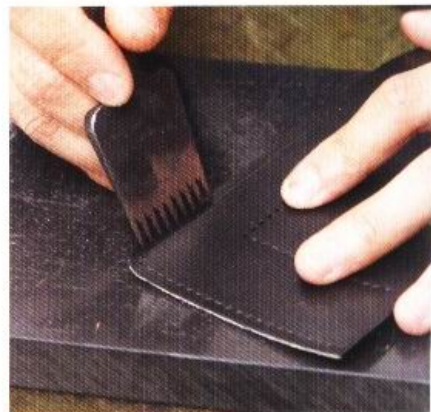
19 鑽孔工作進行到某種程度之後，最後要確認間隔之間是相稱的。
