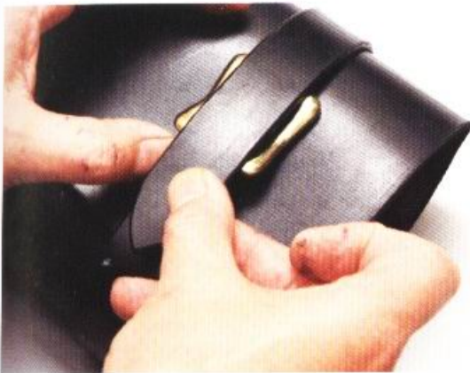
28 拉看看已安裝好的皮帶。在蓋子蓋得最緊的情況下，來對照看看帶釦的位置。
