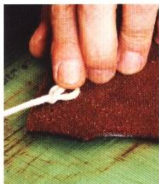
14 調整鹿皮線的狀態。在不讓鹿皮線鬆掉的情況下，在固定皮的根部打結。
