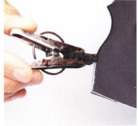
18 削掉邊緣之後，再用染料來染色。請以像是將染料放置在毛邊上的感覺來進行染色工作。
