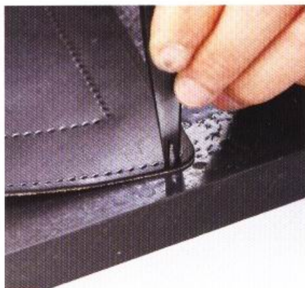
18 R線部分要使用雙菱斬來進行鑽孔工作。
