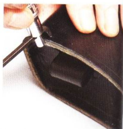
11 使用拉溝器來拉出縫線。
