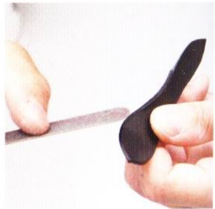
17 用細紋理的研磨片讓使用CMC打磨的毛邊變得粗糙。
