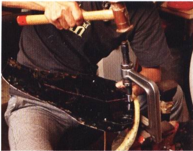
將鉚釘嵌入墊圈，在這裡可以用專用的工具來安裝在鋼圈上。我們在這裡是使用特殊的鉚釘，但是也可以使用皮革工藝用的固定釘。
