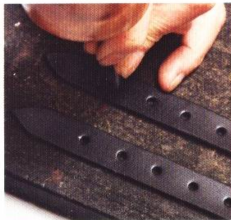
21 決定了基準孔之後，（要）再鑽出等間隔的孔。
