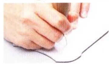
將紙型對齊零錢包A，並在要和卡片夾C縫合的位置上做記號。
