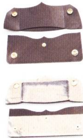
這是固定零錢包蓋口的四合釦與固定主體的牛仔釦都安裝完成的狀態。
