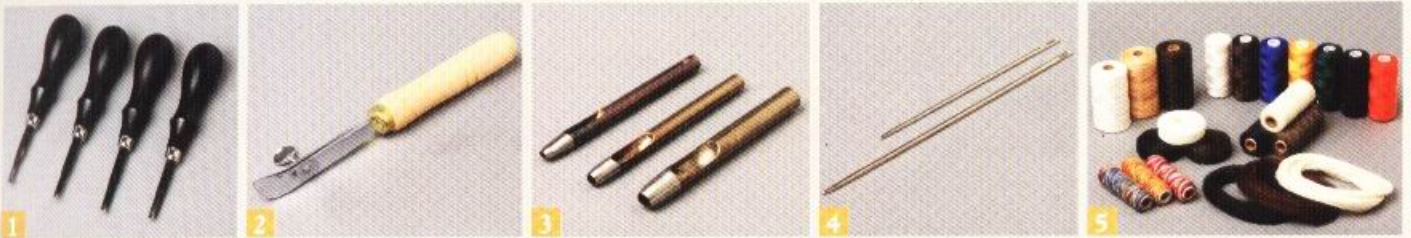
1 削邊器 2 邊線器 3 手環孔斬 4 手縫針 5 縫線
