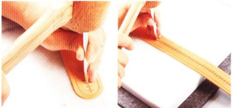
13 請一邊注意不要讓印花錯開，一邊進行打印工作直到最後。敲打印花工具的力道也請維持在固定。
