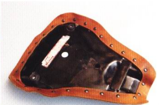
24 將鉚釘嵌入之後，再用榔頭敲打鉚釘，讓鉚釘的頂部平整。在這裡因為我們要用鉚釘來固定後面的緩衝部分，所以在這個時候先不要安裝鉚釘。
