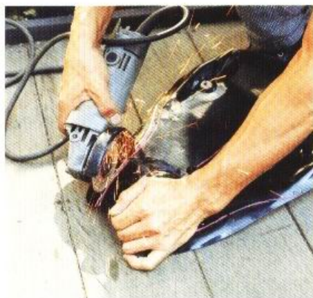
9 使用研磨機來切割鋼板，這裡請注意不要受傷了。如果不打算改變形狀，只是要更新皮革的話，就不需要進行這個工作。
