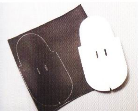
畫出來的剪裁線要比實際的尺寸稍微大一點，剪裁之後再來進行修正工作。
