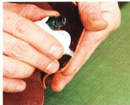
1 在主體B與邊皮上塗抹接著劑。在這裡使用的是橡膠類的快乾膠，所以要等著劑呈現半乾燥的狀態。
