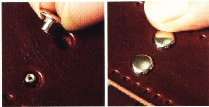
2 將兩面固定釦的公釦從皮帶背面插入，並從上面用手指壓固定釦的母釦來暫時固定。
