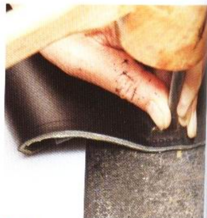
14 配合縫線來進行鑽孔工作，請注意，在這裏要不傾斜地敲打菱斬。
