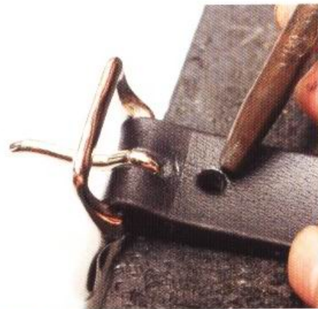
15 用丸斬鑽出要安裝固定釦的孔。請不要從背面的皮革跑掉位置。
