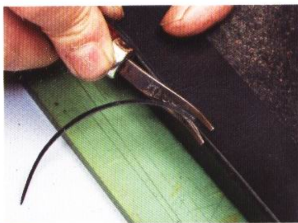
6 削掉皮帶部分的邊緣。直線部分要用削邊器，R線部分則是要用削皮器來削掉表面與背面的邊緣。
