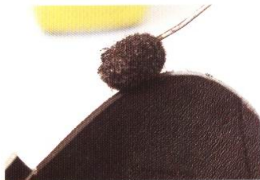
4 削掉邊緣之後，在毛邊上塗抹染料，請小心注意不要產生斑痕。
