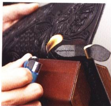
34 用打火機烤熔縫線並固定。請注意不要讓縫線熔化得太多。
