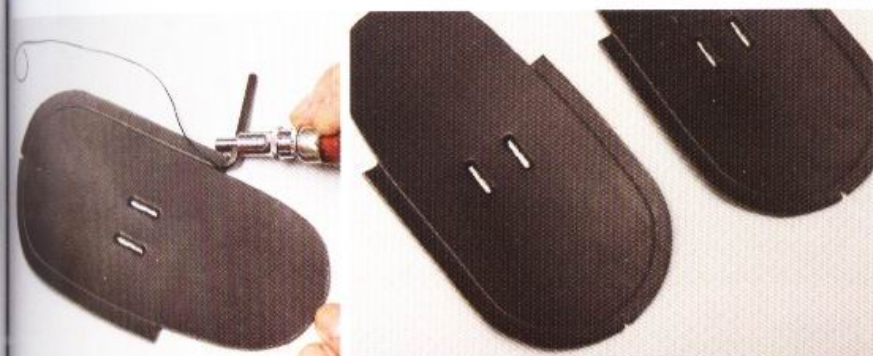
1 使用拉溝器來製作出要彎曲窩邊的雕刻線。請將拉溝器設定在5mm寬。
