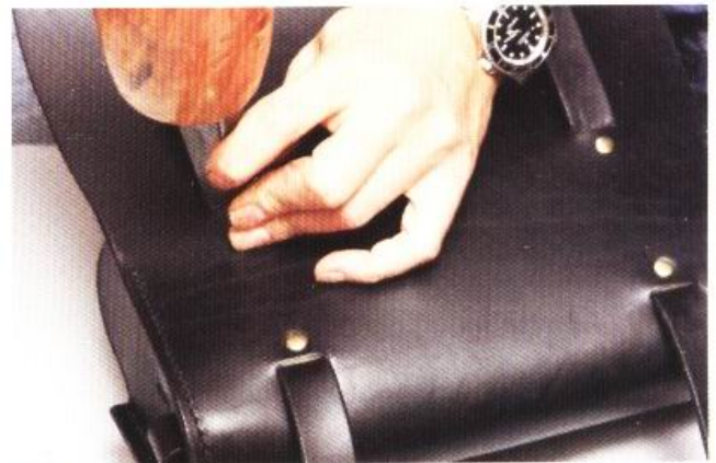
27 在台子上放置萬用環狀台，並敲打皮帶的固定釦。
