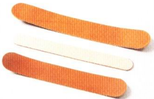
5 用皮革裁刀沿著畫出來的線條進行剪裁工作。曲線部分要同時移動皮革裁刀與皮革來切割才會漂亮。
