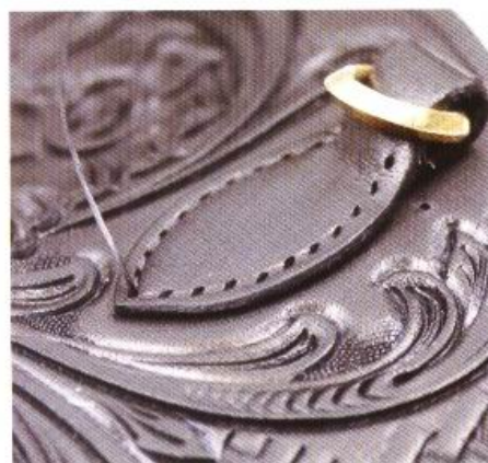
48 用平縫方法在蓋口的四周進行縫製工作。SINEW線的粗細則是要使用2/5縫線。
