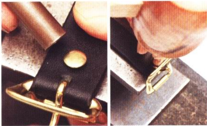
16 在帶釦部分打上固定釦。這個部分也可以用縫製的，但是這裡要用固定釦來固定。
