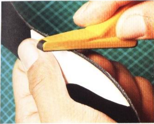
8 用三角研磨器打磨主體A與裝飾皮的接著面，讓主體A與裝飾皮的高度一致。如果接著劑跑出來的話就要去除接著劑。
