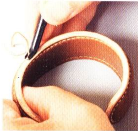
17 使用削邊器將表面與內側四周的邊緣削掉。
