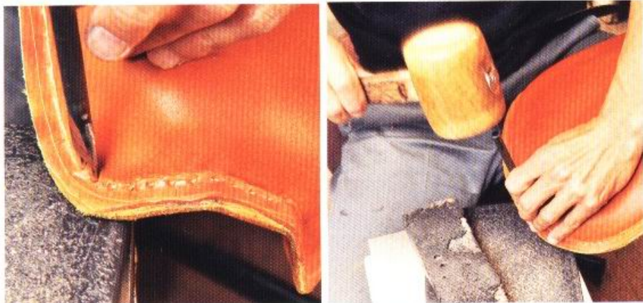
11 配合座面的邊緣來敲打菱斬。ATELIER CHERRY所使用的是特別間隔的訂製型菱斬，需要動腦筋利用橡膠板的稜角來垂直敲打。
