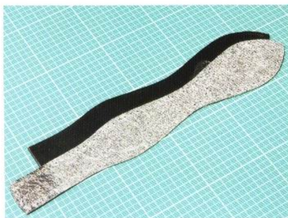
16 將翻過來的主體A放置在主體B上，並與主體B對齊，再用圓錐將主體A的縫線孔位置描繪在主體B上。這麼做的话，主體A與主體B的縫線孔就可以一致，配件也就不會錯開地縫合在一起。
