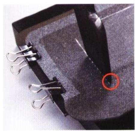
14 將菱斬貼在縫線上來做出記號，錯開最初一個縫線孔來進行鑽孔工作。
