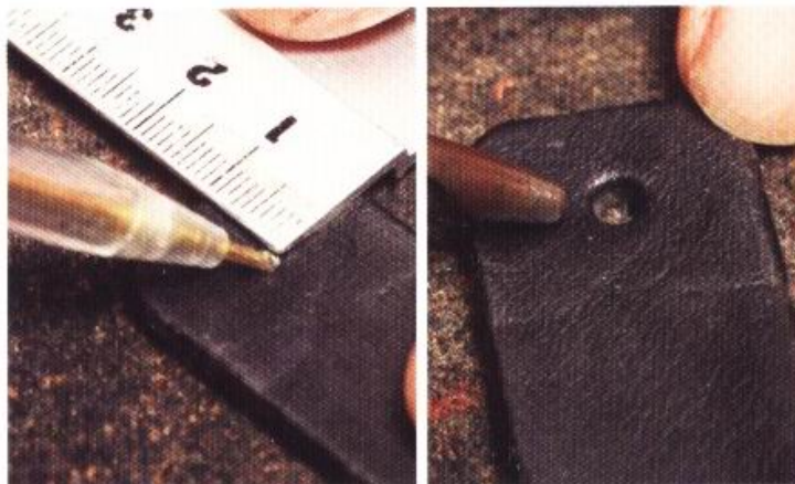
18 用固定釦來將皮帶固定在主體上。用丸斬配合固定釦的大小來進行鑽孔工作。
