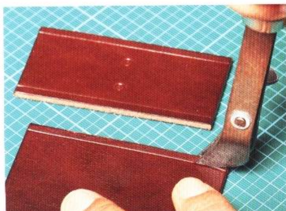
7 將邊線器設定在3.5mm，並在主體與袋身上拉出縫線。
