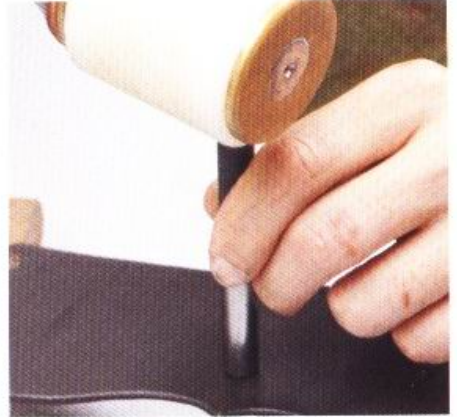
46 用四合釦工具來固定四合釦。如果敲得太輕，四合釦就會脫落，所以請確實地進行敲打的工作。
