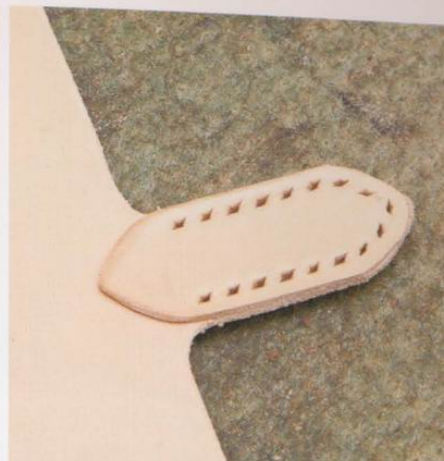
6 配合在 4、5 做的記號敲打菱斬，鑽出縫線孔。要調節到尖端也剛好有縫線孔是關鍵所在。
