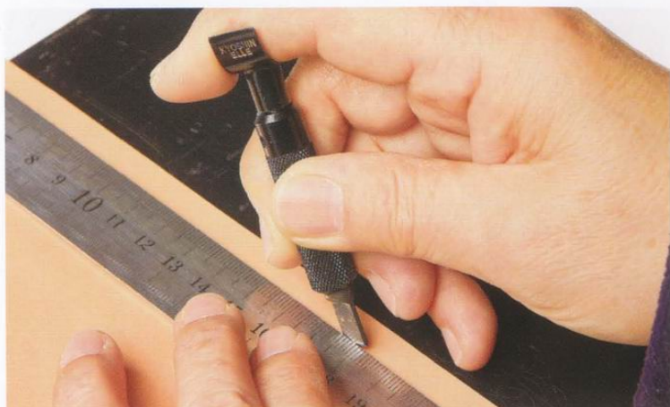
5 用旋轉雕刻刀沿著 4 畫的線切割。旋轉雕刻刀的使用方法請參考P56的「特製附帶飾釦的短皮夾」。
