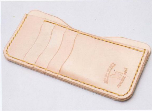
20 縫製工作的最後階段，在卡片夾和背皮之間打個不顯眼的結並將縫線燒烙固定。縫製完成之後，用槌子敲線條讓針腳安定。
