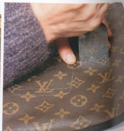
10 也將其他口袋配件或口袋台座的紙型描繪出來，用皮革裁刀將所有的配件切下來。五個口袋裡面只有兩個口袋是使用這個材料。
