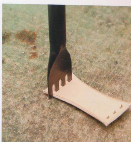
8 接下來在固定皮上也鑽出縫線孔。用邊線器在兩端畫線，並將菱斬的一根刀刀架在桌上敲打。
