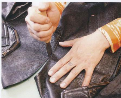
4 將襯布從手腕部分取下，剪掉肩膀部分之後再將手腕部分和衣身割開。沿著接縫割的話可以剪裁得很漂亮。
