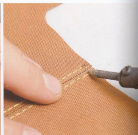
10 最後用槌子敲打線條讓針腳安定。縫製最後的縫線可以用電燒器等工具確實地燒烙。
