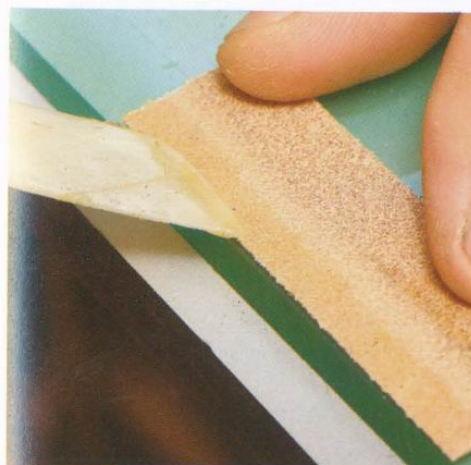
16 在打薄台座邊皮厚度的部分塗上橡皮膠，橡皮膠乾了之後，再打磨另一邊的邊緣。
