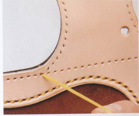
21 接下來將縫線從照片的位置開始，穿過袋身的蓋口並縫合起來。
