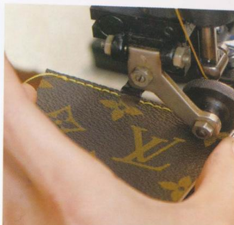
13 台座的上下兩邊用機器縫合，邊緣到針腳的寬度大約2mm。縫製完成之後用電燒器燒烙固定。
