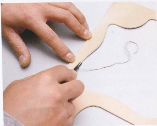
2 為了要打磨縫合後沒辦法打磨的毛邊部分，先用削邊器削掉邊緣。這次使用的紙型請看 4 的照片確認要打磨的地方。
