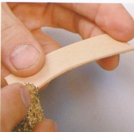
16 在打薄台座邊皮厚度的部分塗上橡皮膠，橡皮膠乾了之後，再打磨另一邊的邊緣。
