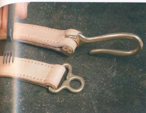
15 將皮帶各自縫合起來。縫線孔要鑽到反折皮革的分界線為止。
