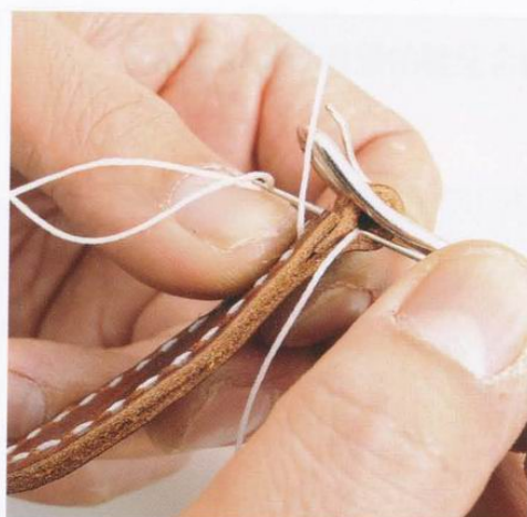
27 縫製的最後，將兩支針貼在一起，從兩片皮革中間穿出來。和尖端那邊用相同的方法固定雖然也沒問題，但是像這樣做的話則可以隱藏線結的痕跡。
