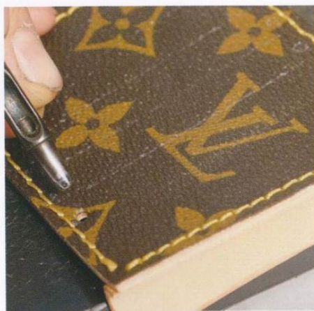
22 配合21的記號鑽孔。因為皮革有厚度，所以事先不要在台座上鑽孔，而是要配合原物。鑽了孔之後，從台座背面插入固定釦公的部分，再從口袋插入母的部分。
