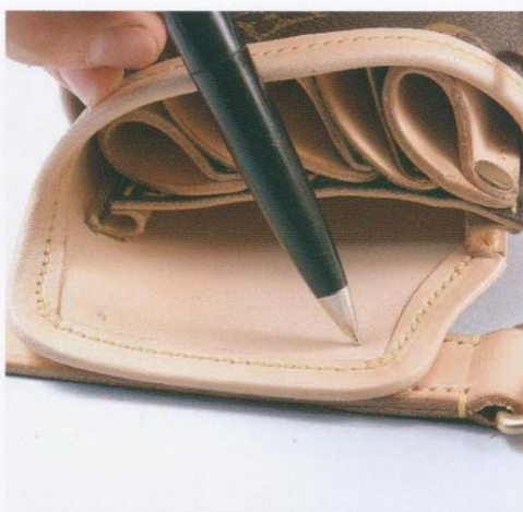
17 將短皮帶固定在袋身上。用原物來配合位置，並用銀筆在袋身裡面的兩個地方做記號。
