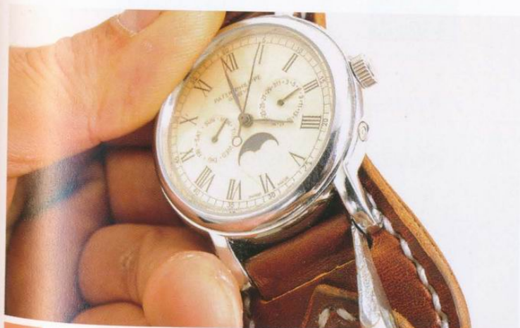
20 將彈簧棒插入彈簧棒的固定皮裡，再安裝回帶身。為了不要讓皮革有傷痕或留下皺褶，請慎重製作。
