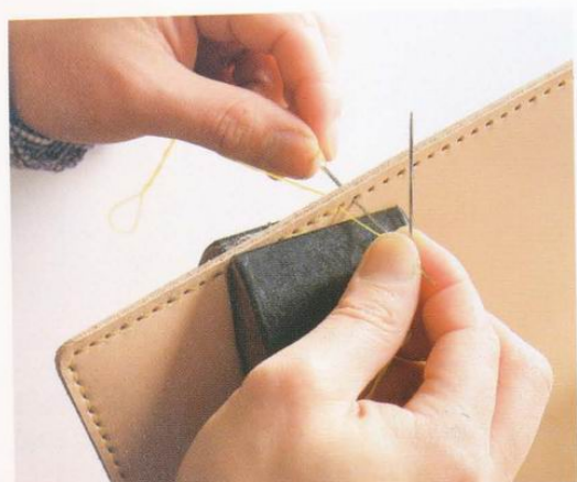
12 在第一個孔和最後一個孔都縫上雙重縫線再開始進行縫製的工作。
