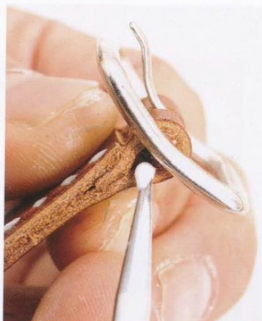
29 用錐子等工具將線結壓進裡面看不見的地方。為了不要讓線結鬆開，所以要塗上接合劑來固定。
