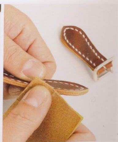
30 用槌子敲打來讓線條平整，再用200號的砂紙來調整兩條錶帶的毛邊。
