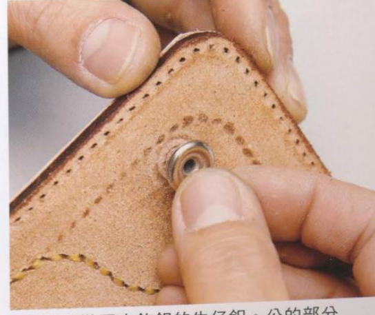
23 安裝固定飾釦的牛仔釦。公的部分的台座從粗糙面裝入。
