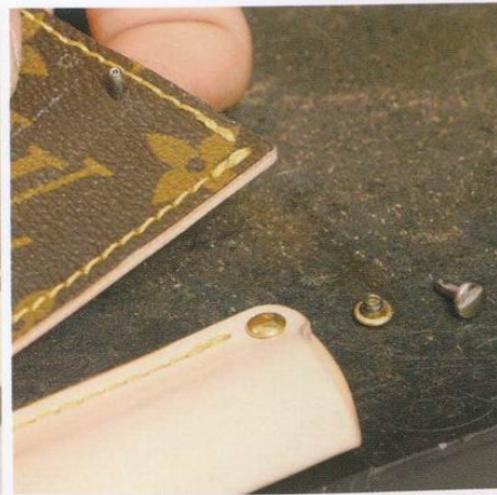
22 配合21的記號鑽孔。因為皮革有厚度，所以事先不要在台座上鑽孔，而是要配合原物。鑽了孔之後，從台座背面插入固定釦公的部分，再從口袋插入母的部分。
