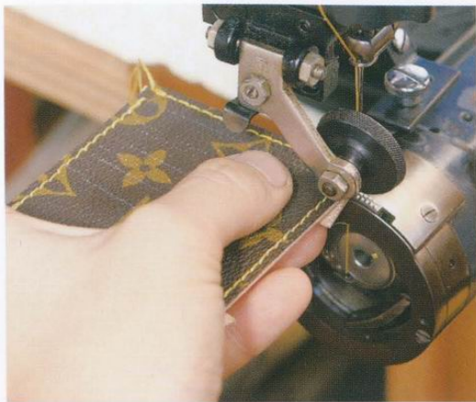
18 將台座和邊皮縫合起來。邊緣到針腳的寬度大約2mm。
