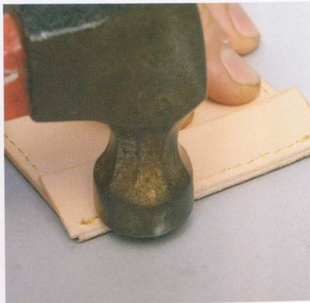
19 用鎚子敲打針腳讓針腳安定。如果邊皮和台座之間有高低差的話，用削邊器削掉讓邊緣平整。削掉邊緣之後記得要塗上磨邊蠟。
