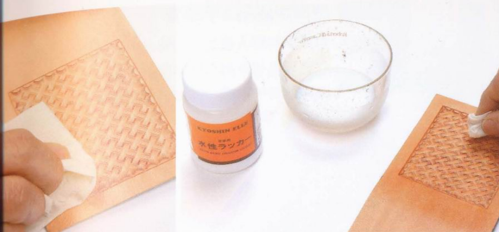
19 印花工具敲打完成之後，塗上油質染料來上色。輕輕地擦拭光滑面之後，將用水稀釋過的水性亮光漆薄薄地塗在全體面上。
