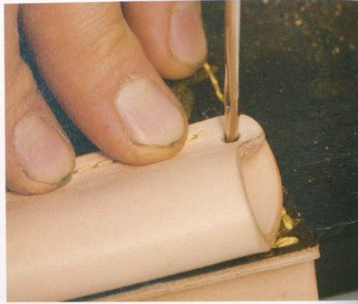
21 將口袋配合台座，用錐子刺入鑽出來的孔。在台座上還要做安裝固定釦位置的記號。
