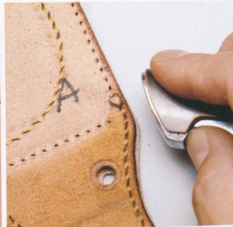
22 用平縫技巧縫製，將線結隱藏在袋身的零錢包裏面。這裡也是皮革很厚的部分，所以可以使用手縫固定夾具來幫助。
