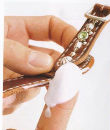
19 毛邊沾水濕潤之後塗上背面處理劑，在擦掉多餘的背面處理劑之後，用乾燥的菜瓜布和帆布打磨。
