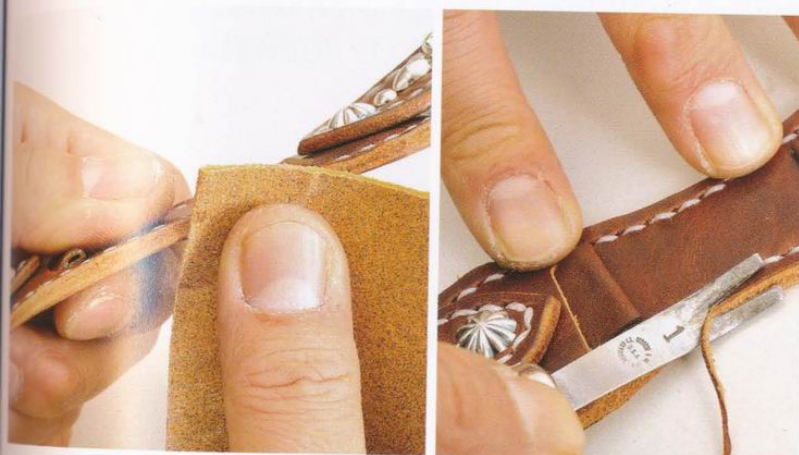
18 全部縫製工作都完成之後，用砂紙打磨毛邊並調整毛邊的高低差，再用削邊器削掉邊緣。
