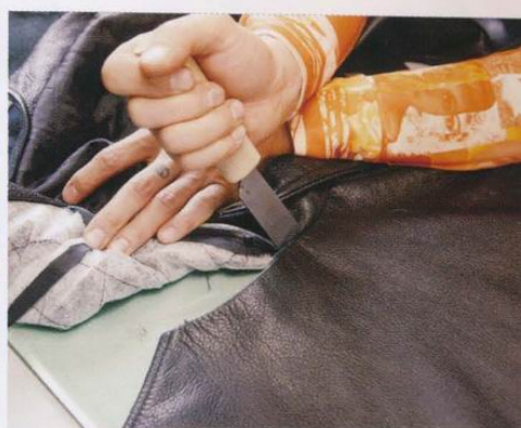
4 將襯布從手腕部分取下，剪掉肩膀部分之後再將手腕部分和衣身割開。沿著接縫割的話可以剪裁得很漂亮。
