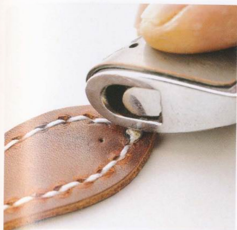
25 剪掉多餘的縫線之後，用打火機燒烙固定，並用打火機的機身去按壓線結。線條則是用槌子敲打，讓線條平整。
