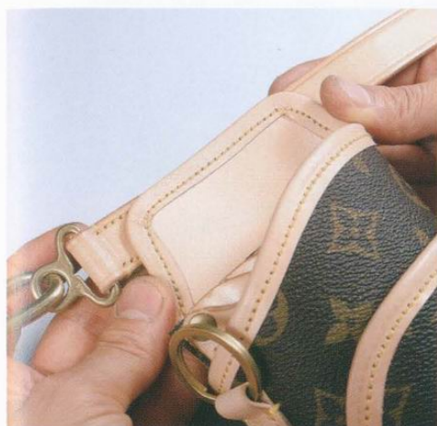
17 將短皮帶固定在袋身上。用原物來配合位置，並用銀筆在袋身裡面的兩個地方做記號。
