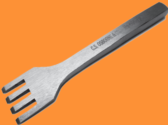
4-х и 1-зубый плоские пробойники 3 мм фирмы C.S. Osborne
