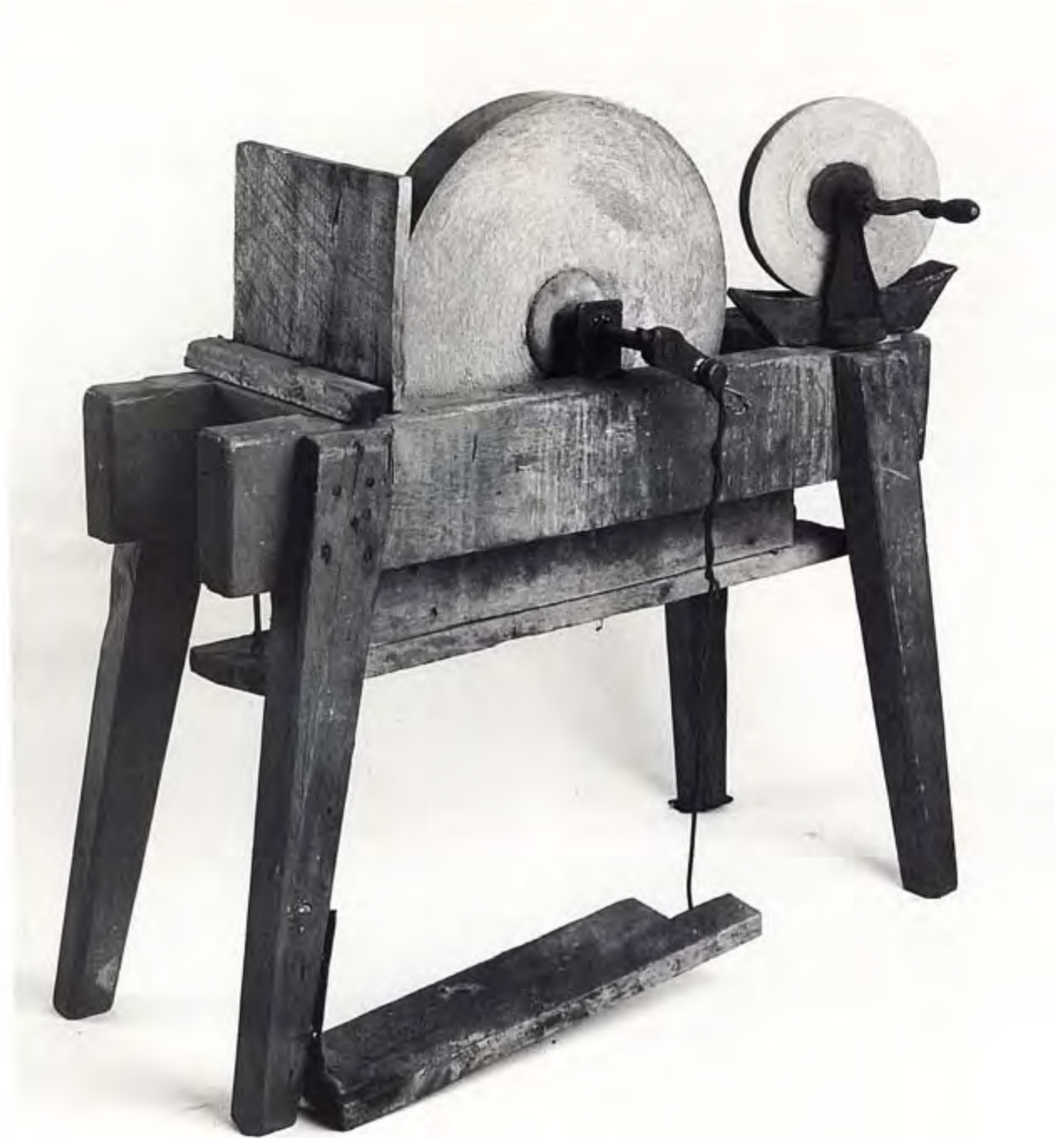
Два точильных круга из природного песчаника с водяными ваннами. Малый круг справа это обычный «крестьянский» точильный круг, второй фигурировал в ранних каталогах фирмы Sears. Точильный круг, работающий от педали, имеет хорошо спроектированную стойку с защитным щитком и соединением на крюках для водяного желоба, который можно было легко опорожнить после работы.
