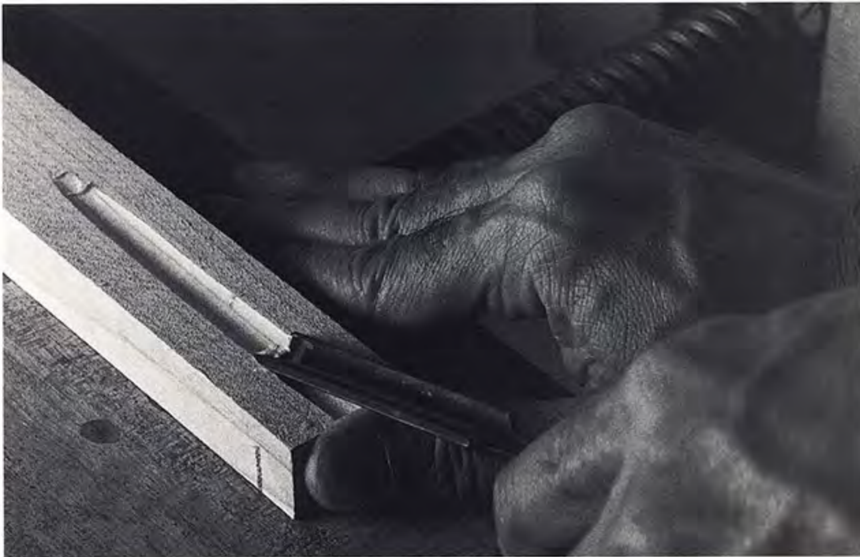
При вырезании желобка в верхней части мягкого куска дерева при помощи полукруглой стамески получается притир превосходной формы для доводки фаски той же самой стамески. (Фото Susan Kahn)
