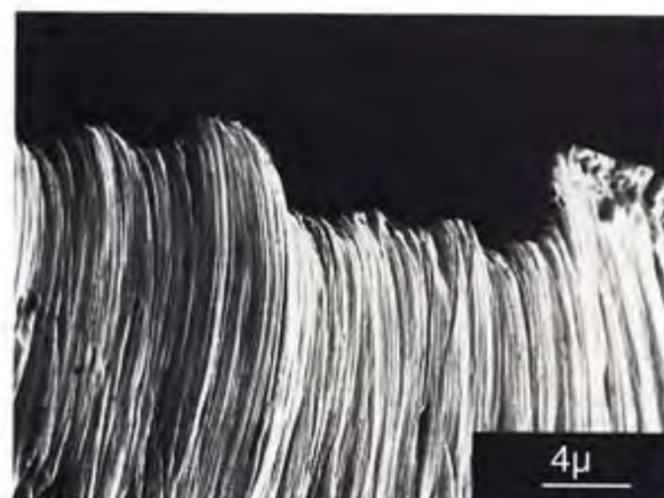
2. Фаска, заточенная на 400 масляном точильном камне на основе оксида алюминия
