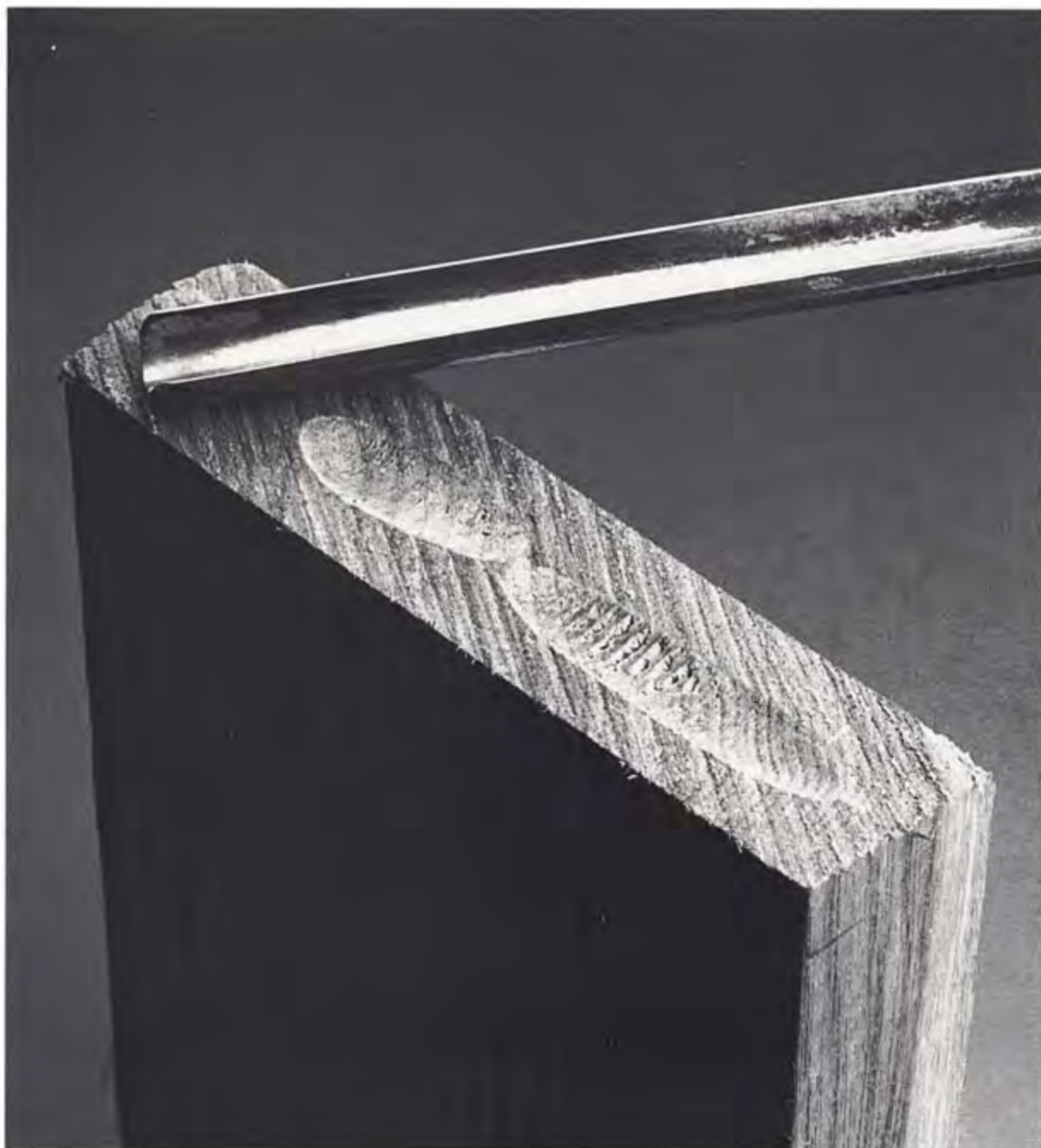
Радиусный рез (слева на торцевой поверхности) приводит к намного более гладкой финишной поверхности, чем прямой рез (справа).
