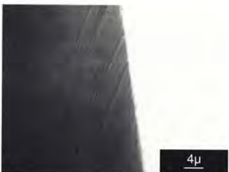
12. 8000 водный камень и правка на ремне с доводочной пастой на основе оксида хрома
