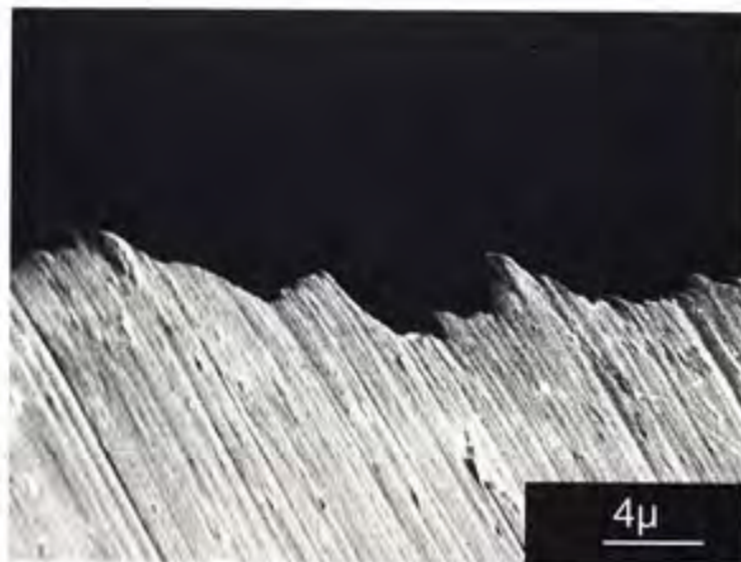
1. Фаска, заточенная и правленая на ремне, с доводочной пастой на основе оксида хрома (задняя плоскость стамески не притиралась)
