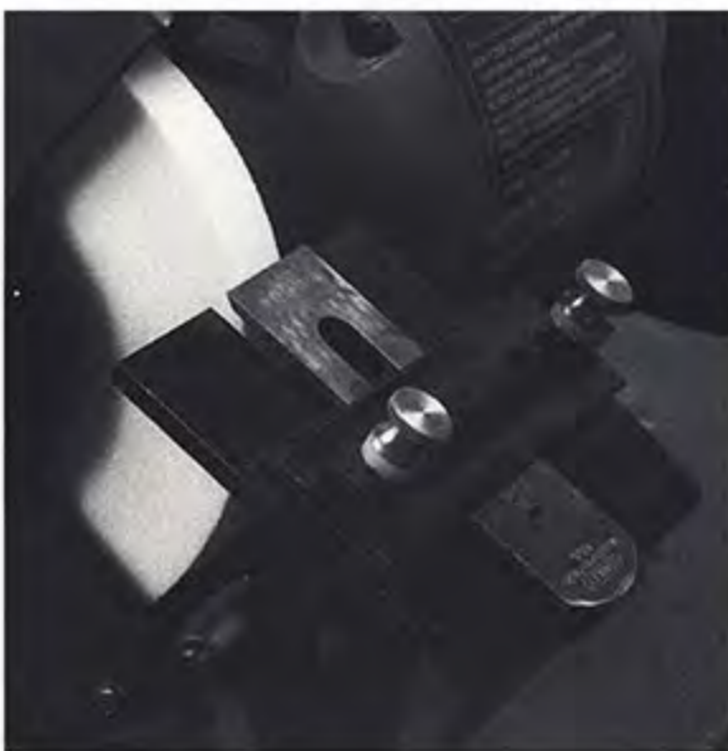
Приспособление, в котором зажимается инструмент, и которое может скользить поперек подручника очень важно для аккуратной заточки. Тут показано заводское приспособление (слева) и кустарное (справа). Фото слева сделано Susan Kahn.
