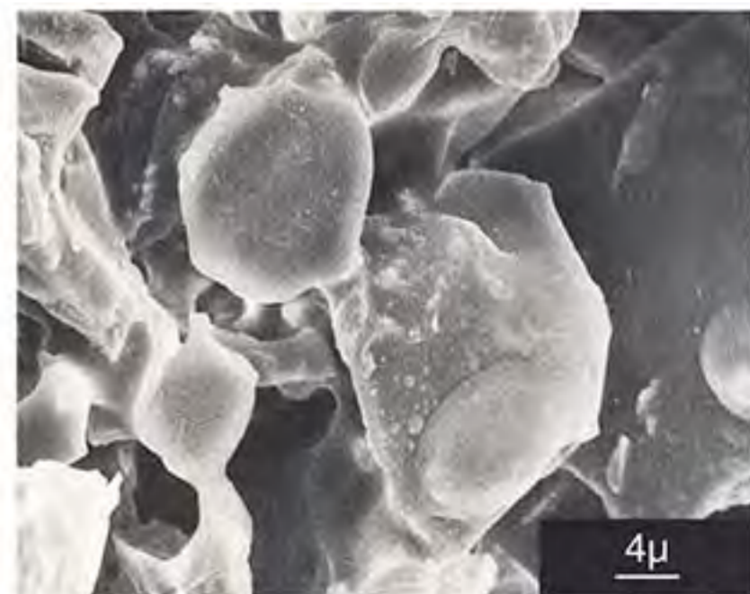
Керамическая связка на масляном камне на основе оксида алюминия (тонкозернистая индия) (слева) дает камень со структурой довольно отличающейся от японского водного камня с вулканитовой связкой (справа). Фото любезно предоставлены национальным научно-исследовательским советом Канады.
