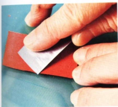
25 用斜削的方式，將袋口內裡的三個邊削薄5mm寬，以削薄袋口的厚度。
