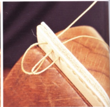
22 要進行縫合結束的處理時，使用後袋身的一支縫針縫合（暗縫或普通縫法）。用這支縫針穿往下一個孔之後拉線。
