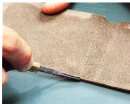
16 修整主體B肉面層側邊的毛邊。在此階段，還不用處理皮面層的側邊。
