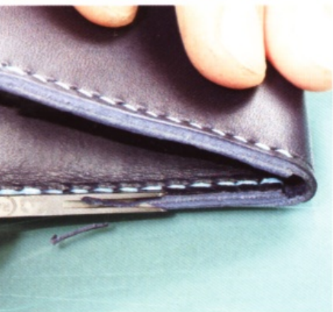
57 修平因三角研磨器而起毛的切口。
