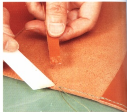
10 在書籤刮粗的部分和主體部分，塗上白膠之後，從上往下壓讓接合緊密。
