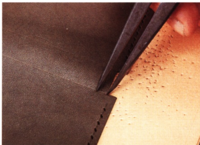
13 安裝金屬零件時，將間距規設定5mm，先在高低差的地方做記號，然後往反方向繼續進行。
