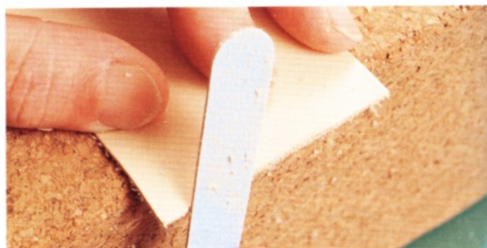
2 使用砂紙研磨切口，切口會產生毛邊的現象，這時請用研磨片，斜斜地將切口的毛邊修整乾淨（去除稜角）。
