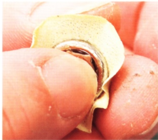
41 把皮革拿在手上，先讓扣子的正面部分緊密地黏合。
