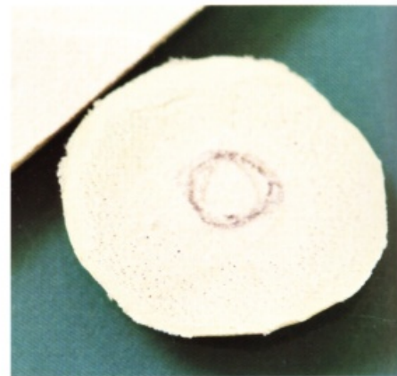
37 此為削薄後的狀態，皮革中心保留原來厚度，邊緣僅剩皮面層。
