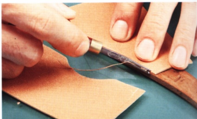
2 使用削邊器，裁切畫上裝飾線邊緣的毛邊。在這裡使用的是3號的削邊器。
