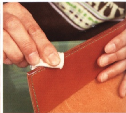
14 最後在切口的部分塗上床面處理劑，然後再小心地打磨就完成了。 介意切口有毛邊者，可以將毛邊修掉之後再打磨。
