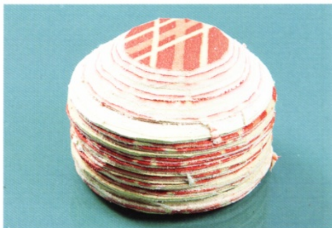
38 此為蓋革粗略削薄後的狀態。因之後還會一起修整剩下的高低差與側面的部分，所以在此階段不用再繼續修整。
