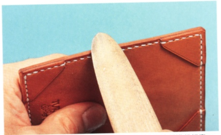
42 裁掉毛邊後，塗上床面處理劑，用木製修邊器進行打磨。打磨時請注意不要太過用力。
