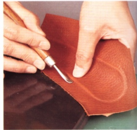
7 將鞋拔彎曲的內側朝外，使用壓叉器，利用高低差修出鞋拔側面的線條。
