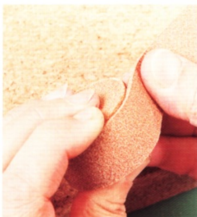
11 直到滲入雙方的黏膠都乾燥之後，用捲動的方式從削薄的那一端開始，將床革與鉛塊側面彼此緊密黏合。
