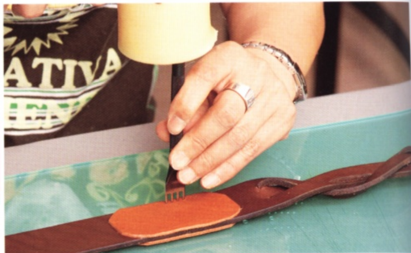
47 將全部拼接皮革都接著完成後，接下來進行縫製。首先使用雙菱斬，在各個拼接皮革外圍畫縫合線，然後打菱形孔。使用邊線器作業時，設定的寬度為3mm。
