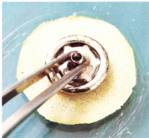
40 接著劑乾燥之後，把扣子夾起來，放在接著面的中央與皮革接著。操作時可用夾子等來輔助。
