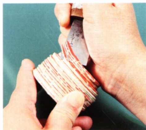
35 皮革成形作業從使用裁皮刀全面粗略削薄皮革開始。作業時請小心，不要傷到手。
