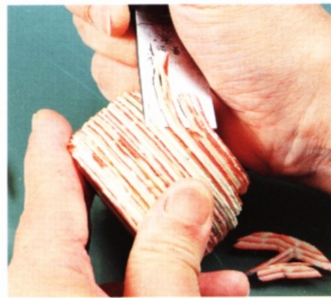
36 從最上層的蓋革開始斜斜地下刀，一邊修整形狀，一邊粗略地削薄。此時使用裁皮刀最為有效（可確認削薄處，而且可避免削得太薄）。
