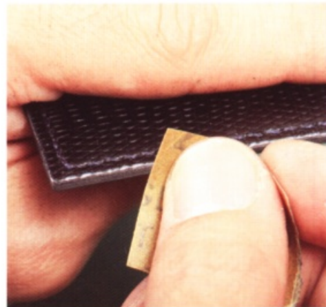
28 使用240號的砂紙，輕輕地研磨切口和毛邊的部分。
