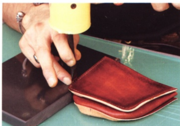
26 將菱斬放在前袋身，循著前袋身的菱形孔進行打孔，將菱形孔打入袋襠的部分。
