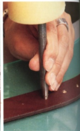
46 以最初做出的記號為中心，在左右各打2個孔，再以每孔間隔25mm，打出皮帶孔。
