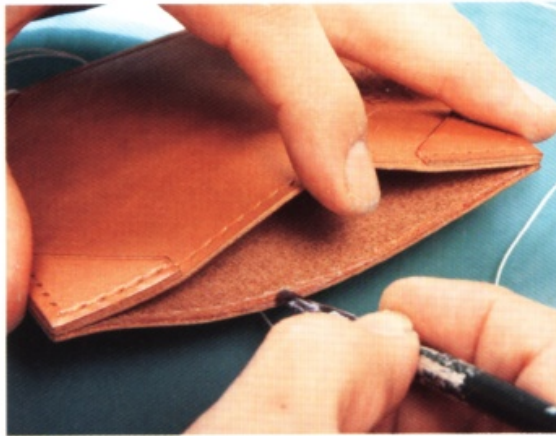
29 等上下部分都確實固定後，在口袋另一側也塗上白膠，並確實黏合。白膠若有溢出的情形，請用布等擦拭乾淨。
