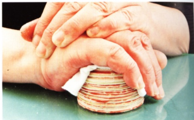
32 當全部的蓋革都疊好之後，用濕棉布從上面蓋住，讓每一片皮革黏合的更緊密。
