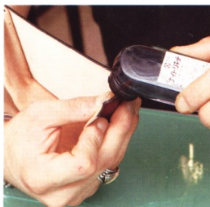
27 與步驟 25 打磨切口的方式一樣，將液體鞋油塗在袋襠的上緣，打磨切口。
