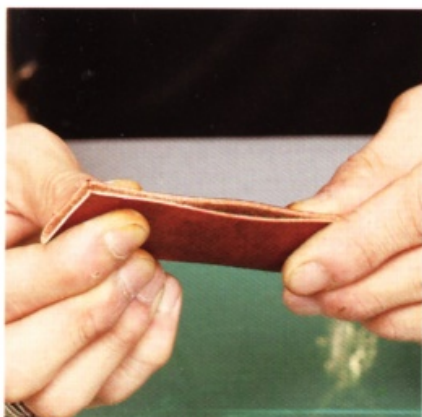
13 在皮革還濕潤柔軟時，將袋襠對折並固定對折處。作業時要確實將對折處固定好。
