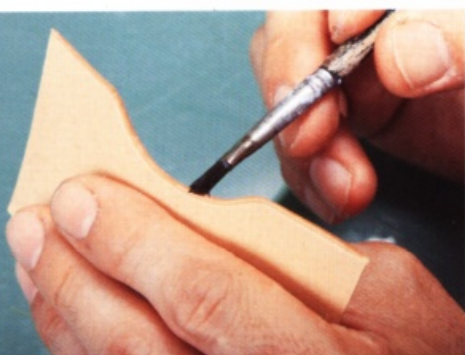
3 毛邊裁切完成後，在切口處均勻地塗上床面處理劑，再使用布等來打磨。塗處理劑的時候請小心，不要溢到皮面層的地方。
