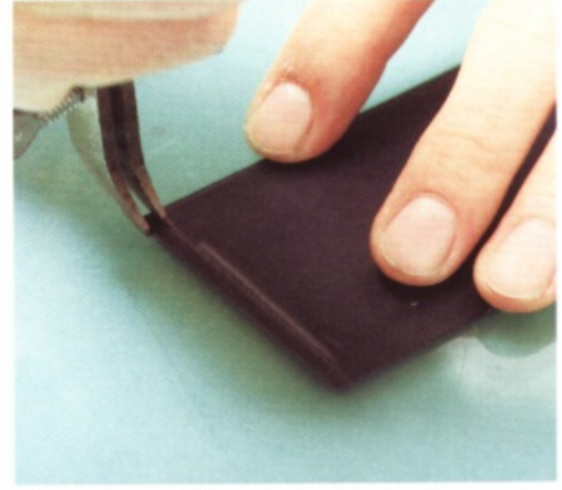
30 與卡片夾層裝飾線呈左右垂直的側邊，用工具畫上縫合線（3mm寬）。
