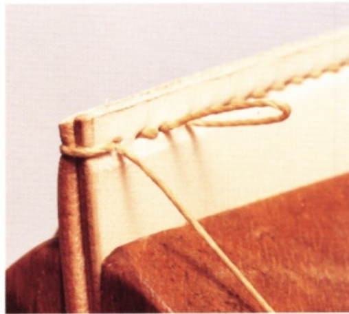
26 抽出縫針、拉引縫線，在袋口確實 將縫目拉緊。
