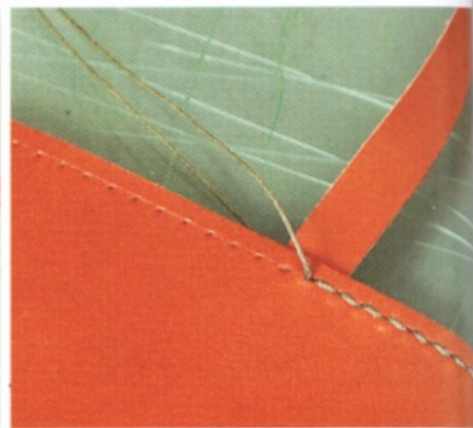
12 待皮革黏合的部分乾燥後，以主體的菱形孔為基準，用菱形錐打通皮革。 菱形孔打通之後，用相同的方式繼續往前縫合。
