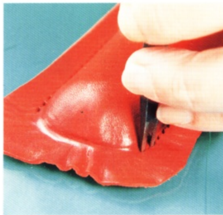
44 使用雙菱斬進行底部的打孔作業。用刀尖邊做記號邊調整，讓兩側的菱形孔可在中間連結。
