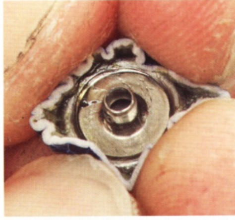
28 等到半乾之後，將扣子放在皮革中央固定。扣子固定後，請在扣子周圍也塗上強力接著劑，然後用上膠片將扣子包起來。
