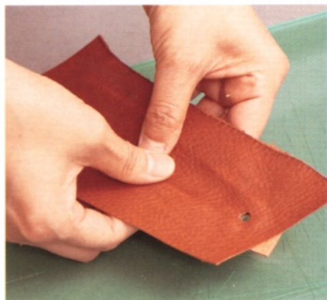
6 沿著鞋拔的曲面緊壓皮革，壓出鞋拔的形狀。壓的時候，用像是要把裡面的氣泡擠出來的力道，由內向外壓出空氣，讓材料之間緊密結合。
