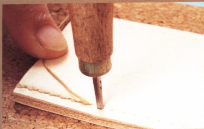
15 用菱形椎逐個鑽孔有困難時，可以先順著菱形孔，將全部的孔打妥備用。
