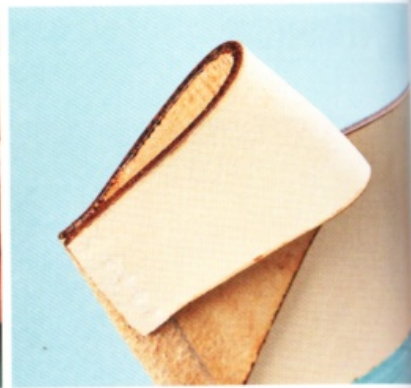
10 在把手邊緣和對折處側邊的接著面（刮粗的部分）塗上白膠之後， 平行對齊上緣黏合，再用槌子輕敲，讓該處黏合緊密。
