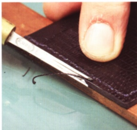
27 輕輕地修掉毛邊。將作品放在檯上等高處作業，比較容易操作。
