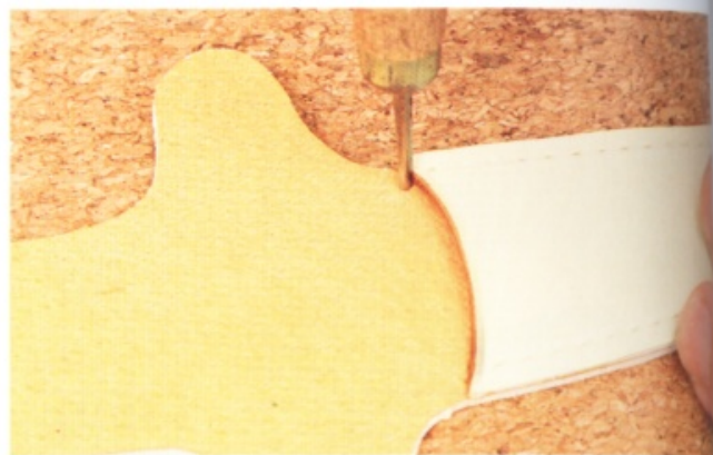
23 用菱形椎刺入記號處，打出與口袋菱形孔連結的縫合孔。 尖椎的角度需配合口袋的菱形孔。
