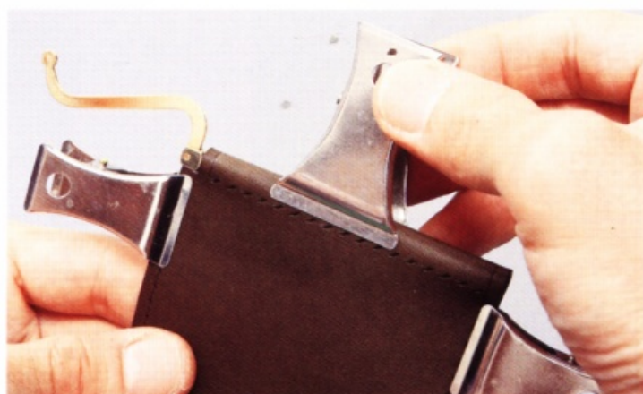
20 塗上接著劑，用夾子固定。請注意不要讓夾子超過內側的菱形孔。
