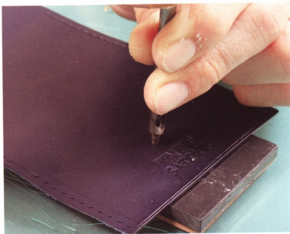
22 在皮革下面鋪一張膠板，以記號處為中心，將丸斬放在記號上面。將丸斬筆直固定後，用木槌進行打孔。這一次使用的是5號1.5mm的丸斬。
