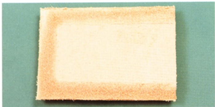
7 這個前袋身已將3邊斜削並做好切口的處理。與後袋身黏合之後，未削薄的部分會呈現膨脹的樣子。
