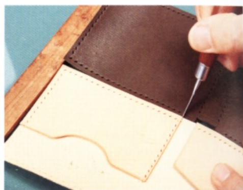
12 在主體A打好菱形孔之後，在主體B的相同位置，也打出一樣的孔數。
