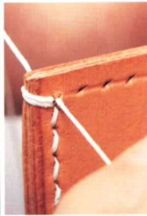
30 確認黏膠乾燥後，再次從①的位置進行縫合。在邊角再縫一次之後，穿到外側。
