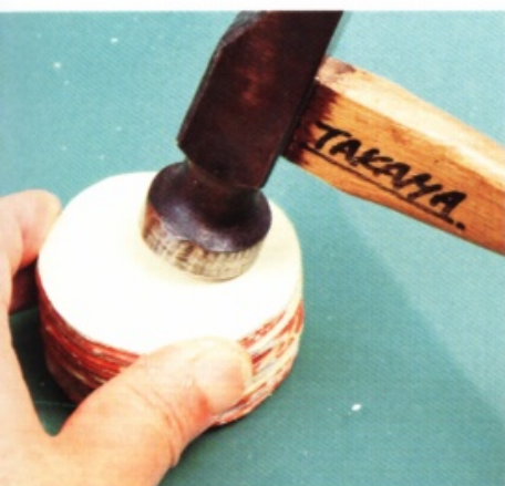
29 黏合第一片蓋革之後，用錘子敲打，讓彼此黏合的更加緊密，與之前黏合底革的步驟一樣。
