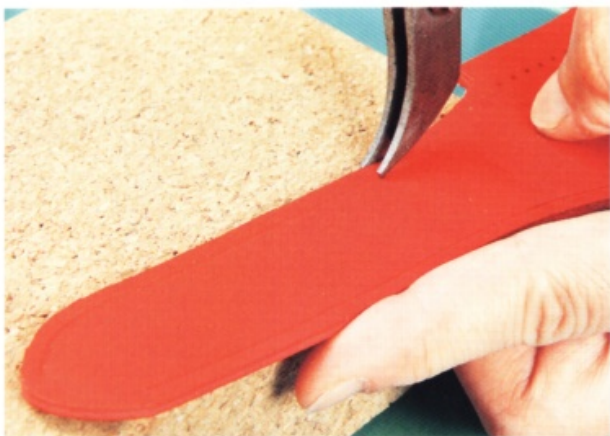
47 因為將筆套蓋反摺之後，就會成為正面，請將邊線器調到3mm寬，從主體反面畫縫合線。
