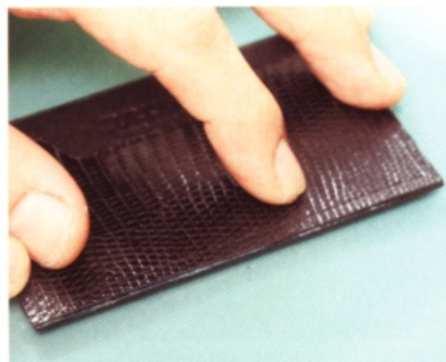
15 將主體和卡片夾層的部分黏合，黏合的時候要對齊不能滑動。用濕布將溢出的白膠擦拭乾淨，然後用滾輪壓合縫合線。白膠在半乾狀態下，黏合效果最佳。
