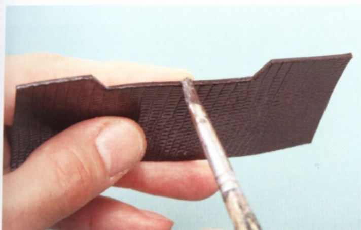
10 在切口塗上床面處理劑。用刮板持續打磨，直到表面顏色改變且變光滑後，用布做最後的打磨。
