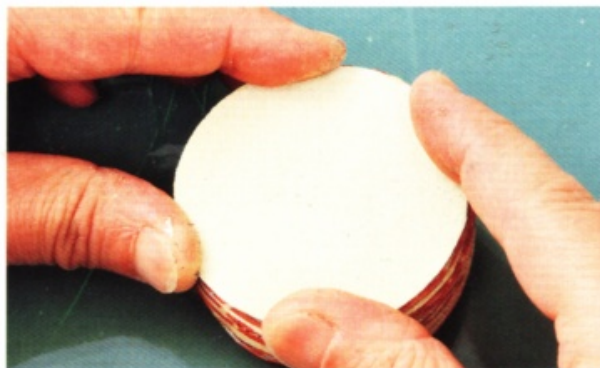
28 將蓋革往底座黏合。先對齊蓋革與層疊表革外圍的部分，然後將雙方緊密黏合。
