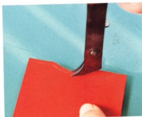
28 用邊線器畫出3mm寬的縫合線，以備進行袋口的縫合作業。
