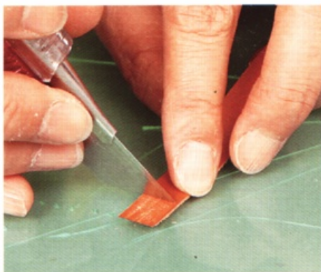
9 持續縫合到安裝書籤條位置之後，開始進行書籤條的前置作業。 將書籤條與主體重疊的部分削薄，然後刮粗皮面層，方便塗上接著劑。
