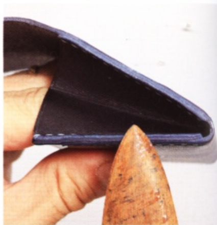
59 切口部分的處理完成後，再用布全面打磨就完成了。
