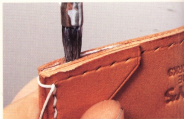
31 進行縫合作業時，若接合處的白膠有剝落現象，只要再將白膠塗到夾層中即可。
