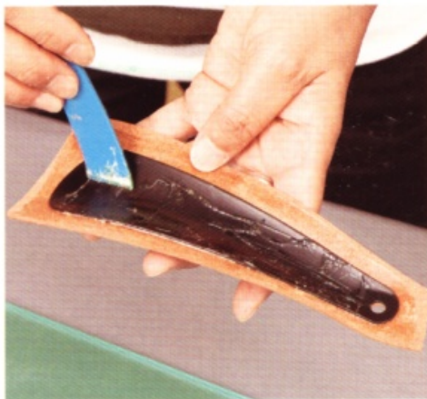
5 以同樣的方式黏合另外一片皮革。在鞋拔和第一片黏合皮革的周圍，以及另一片皮革的肉面層上，用刮板塗滿白膠，等材料乾燥後黏合。
