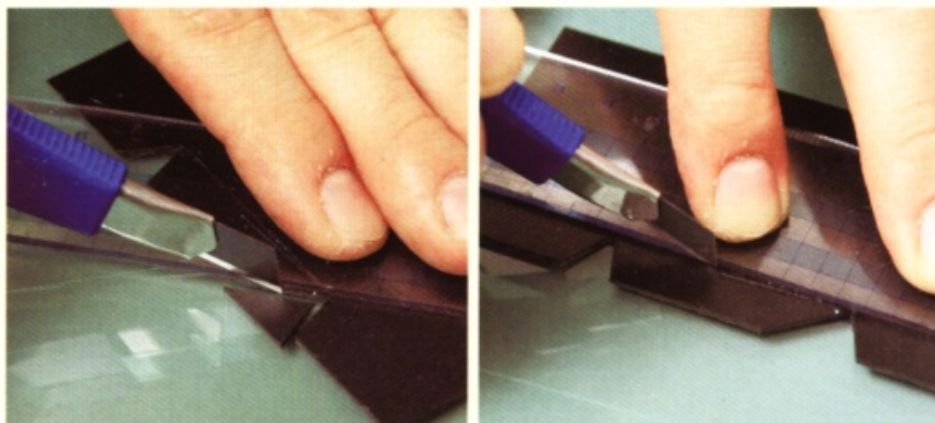
7 裁切直線的部分時，先將長邊畫成小塊之後再裁切。作業時如左圖先將開口兩端裁下之後，刀刃伸入切下長邊的部分會比較方便，裁斷面也會比較整齊美觀。
