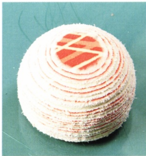
40 圖片為外圍的修整標準（側面全部、不含頂點和底革）。用裁皮刀修整時，可使用挫刀處理較不易修整之處。
