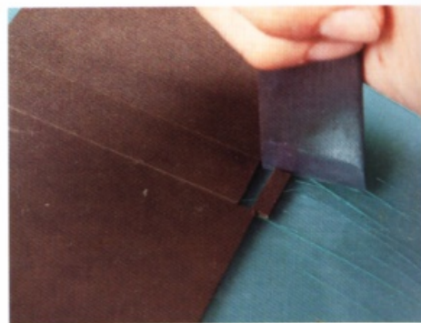
4 參考前頁所附的紙型，用壓叉器在主體B的中心畫線，裁掉5mm寬的皮革。
