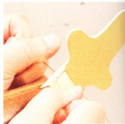
27 將左右縫針交互穿過菱形孔。一面將縫目一針針拉緊，一面進行縫合。 折回底部之後往前縫合，另一邊的袋口同樣也需要再縫一次。
