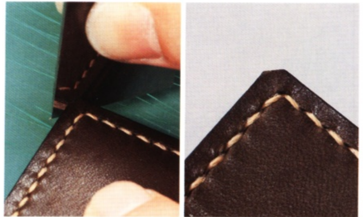
44 用裁皮刀將主體的四個邊角裁掉。作業的時候，一樣要注意不要切到縫線。
