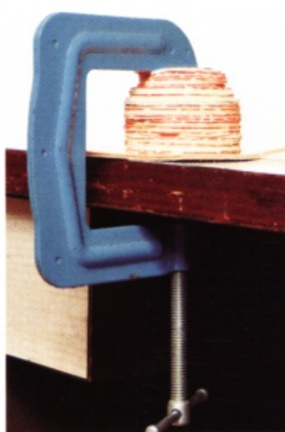
33 在底革下方和蓋革上方都墊上一片皮革，用夾板固定住約一天一夜，待黏膠完全乾燥。
