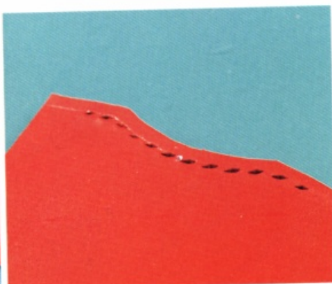
29 在縫合線中間做記號，將菱斬（雙菱斬）橫跨記號，打出第一個菱形孔。接下來一邊調整孔距，一邊進行打孔，從兩邊開始至13mm的記號處為止。
