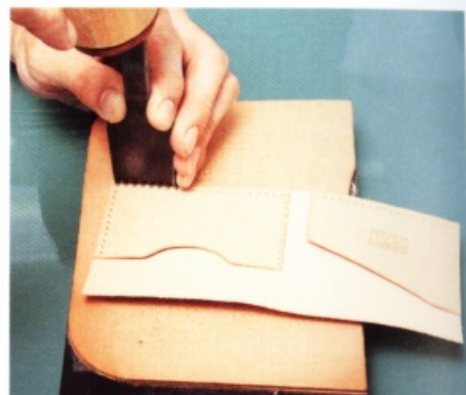
11 首先從主體A開始打孔。讓菱斬與皮革成垂直角度，用木槌敲打，進行打孔作業。
