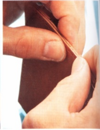
29 等上下部分都確實固定後，在口袋另一側也塗上白膠，並確實黏合。白膠若有溢出的情形，請用布等擦拭乾淨。
