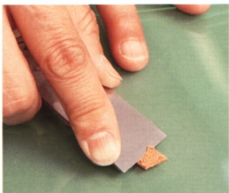
9 持續縫合到安裝書籤條位置之後，開始進行書籤條的前置作業。 將書籤條與主體重疊的部分削薄，然後刮粗皮面層，方便塗上接著劑。
