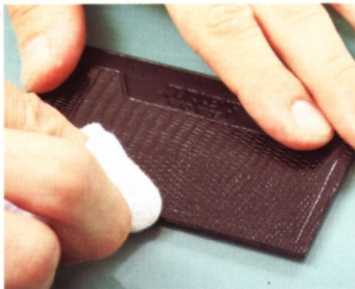
15 將主體和卡片夾層的部分黏合，黏合的時候要對齊不能滑動。用濕布將溢出的白膠擦拭乾淨，然後用滾輪壓合縫合線。白膠在半乾狀態下，黏合效果最佳。
