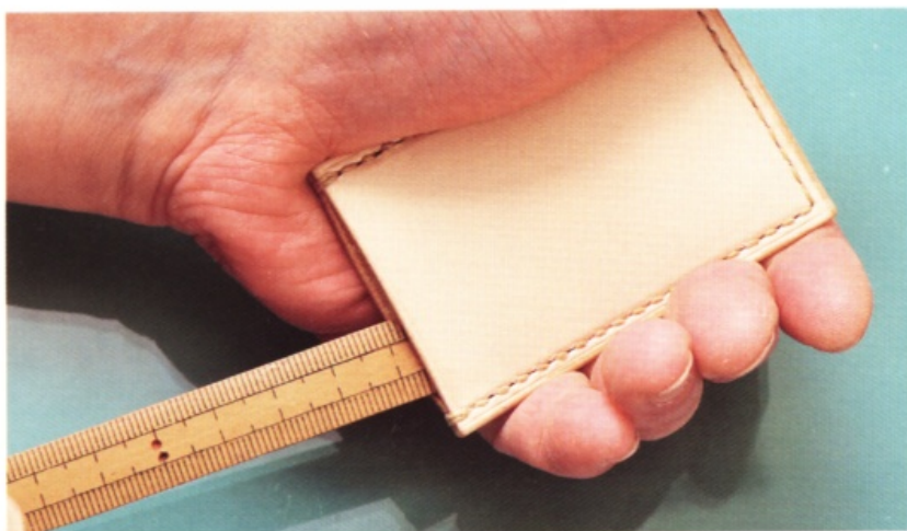
最後使用竹尺或竹製刮板等（竹製品的接觸面較為柔和），插入袋口修整縫目邊緣。這個步驟的目的在於將接著部分打開，以便順利取用，並讓刀套產生膨脹感。
