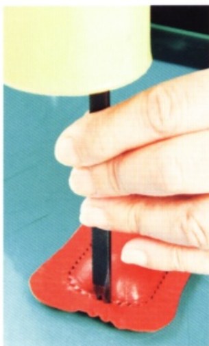
45 打孔作業分別從兩側交互進行到中間。請微調間距，讓菱形孔可以在底部中間連結。側面到底部全都要打孔。
