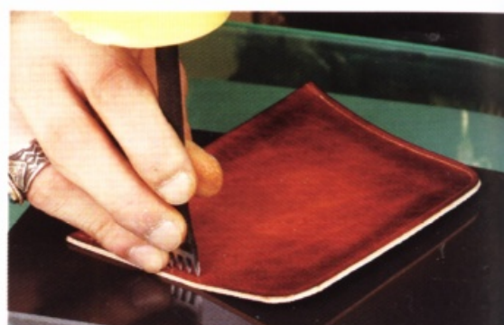
17 沿著縫合線將菱斬第一刀懸在各個邊緣處後開始打孔，連接菱形孔時要一邊調整，一邊打孔。
