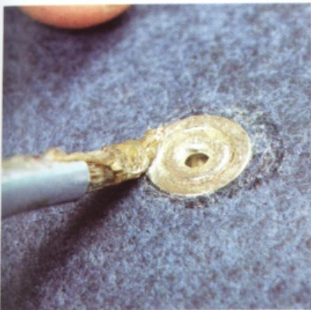
29 在已安裝好的公扣上，塗上強力接著劑之後，貼上隱形革。使用隱形革可以避免金屬零件直接接觸卡片或皮革。
