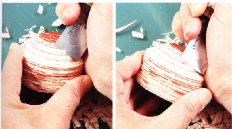
37 以步驟36中疊起來的記號為準，從上面的蓋革削到底座的高度，將皮革側面削成平滑連貫的狀態。
