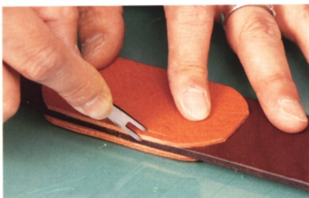
47 將全部拼接皮革都接著完成後，接下來進行縫製。首先使用雙菱斬，在各個拼接皮革外圍畫縫合線，然後打菱形孔。使用邊線器作業時，設定的寬度為3mm。
