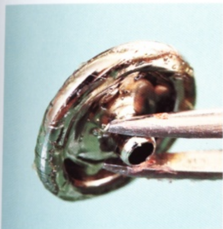
40 接著劑乾燥之後，把扣子夾起來，放在接著面的中央與皮革接著。操作時可用夾子等來輔助。
