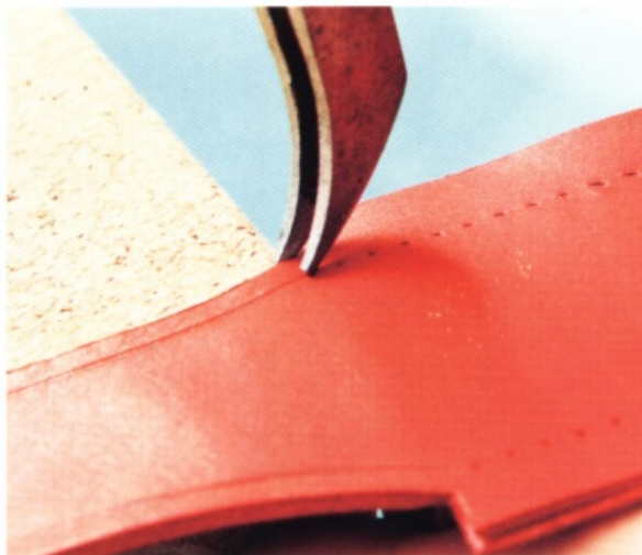
48 畫到袋口側邊時，將縫合線與清空的口袋側邊由裡側透出來的菱形孔連接。
