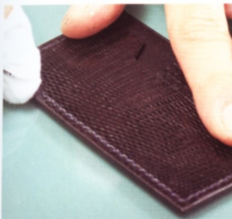
30 在切口部分塗上床面處理劑，用乾淨的布來回打磨直到滿意為止。
