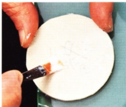
27 從這個步驟開始，把作為蓋子用的皮革堆疊起來。先在底座（將圓形的表革刮粗備用）和蓋革的肉面層塗抹白膠。
