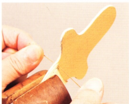
26 此為第一個拉緊的縫目處。從此 處開始用基本平縫法進行縫合。
