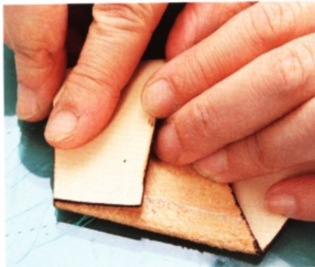
10 在把手邊緣和對折處側邊的接著面（刮粗的部分）塗上白膠之後， 平行對齊上緣黏合，再用槌子輕敲，讓該處黏合緊密。
