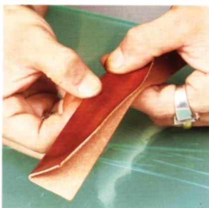
13 在皮革還濕潤柔軟時，將袋襠對折並固定對折處。作業時要確實將對折處固定好。
