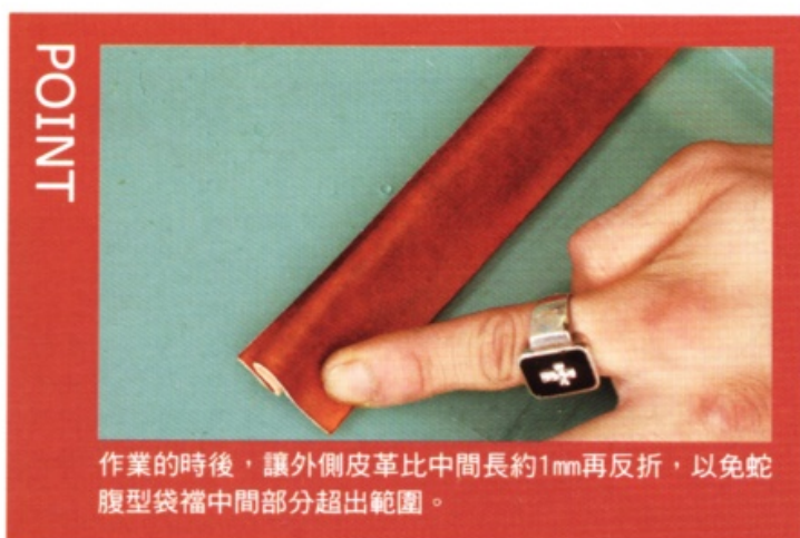
15 將皮革折成如左圖的狀態。把袋襠皮革放置在鐵砧上，用錘子輕捶（將手指折出的波浪壓平）。
