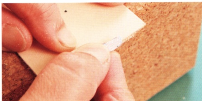
1 研磨前袋身和後袋身的口部。首先使用粗目（#150）的砂紙，將切口部分包覆起來打磨。
