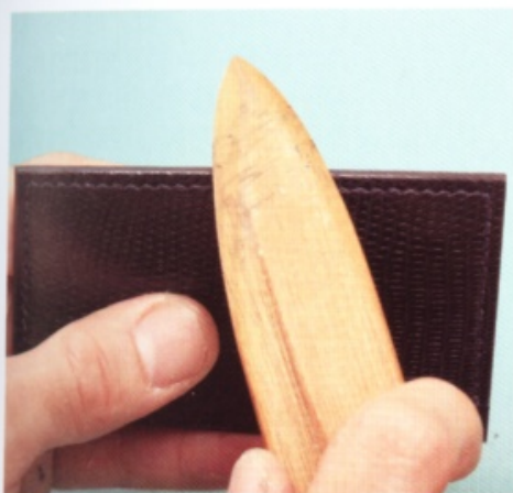
29 塗上同色的壓克力染料，等染料乾燥之後，用竹板打磨出光澤。
