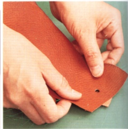
5 以同樣的方式黏合另外一片皮革。在鞋拔和第一片黏合皮革的周圍，以及另一片皮革的肉面層上，用刮板塗滿白膠，等材料乾燥後黏合。
