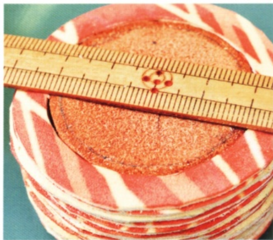
26 直到底座表面（上面）與層疊的表革高低一致時，堆積表革的作業就完成了。
