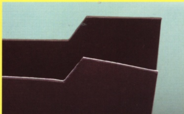
這張圖片是切口經過打磨和未經打磨的對照圖，其中差異相當明顯。只要多下點工夫，品質立刻提升。
