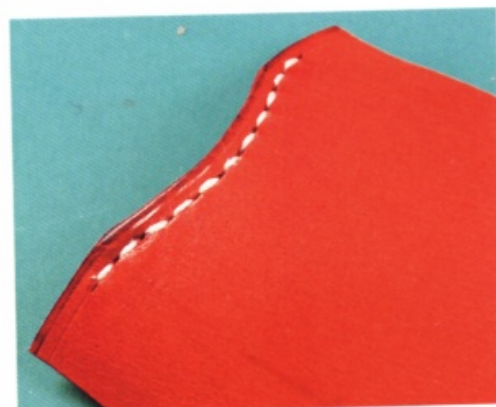
30 用平縫法縫合打孔處，縫合之後進行打磨切口以及袋口的加工。
