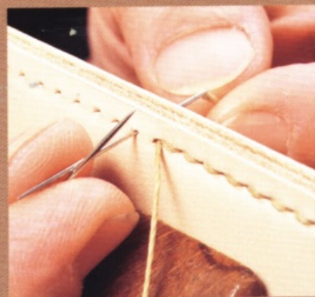
18 拔出前袋身旁的針之後（退回），將後袋身的針穿過縫孔，同之前的操作方式。
