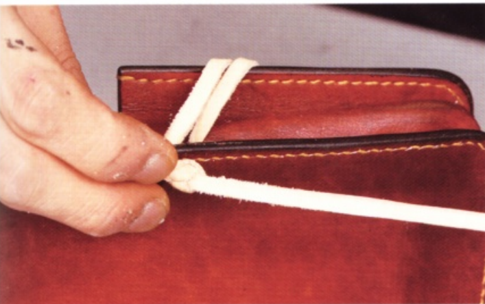
69 將編織好的皮繩前端，盡量地拉往後袋身側邊，接下來可以隨自己喜好，將編織分成兩股的皮繩。
