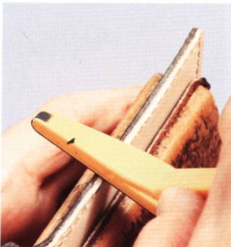
側面的高低差整平之後，繼用三角研磨器續打磨，將側邊修整精緻。四個已裁切的邊角也要一併處理。
