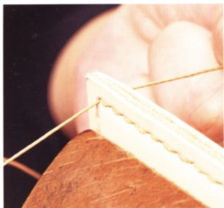
19 用平縫法縫合完成之後（縫到邊角的位置），將夾在固定夾具的主體轉個方向，用相同的步驟繼續進行。
