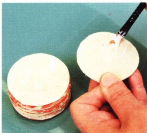
30 進行成形作業時，將第2片蓋革的皮面層，與下方的皮面層相互黏合，然後做出削薄截止處的記號，以確認位置。
