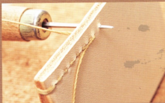
16 用菱形椎鑽孔時，請將菱形椎對齊菱形孔的角度。鑽孔的程度如圖片的狀態。
