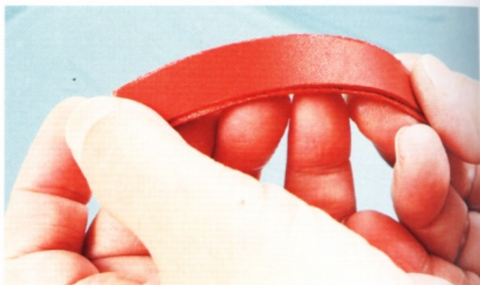
55 在皮帶（正反面）的肉面層塗膠，將皮帶正面朝上，一邊折彎皮帶，一邊將正反兩面黏合。
