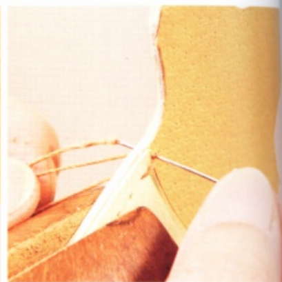
25 將第一針穿過菱形椎孔後，再穿過口袋的菱形孔，從反面穿回到 第一針的縫合孔後，將第一個縫目拉緊。
