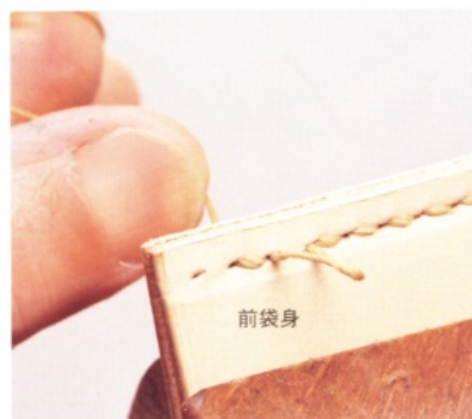
23 完全拉引穿過的縫線之後，請保留前袋身的線不要拉緊（輪狀）。
