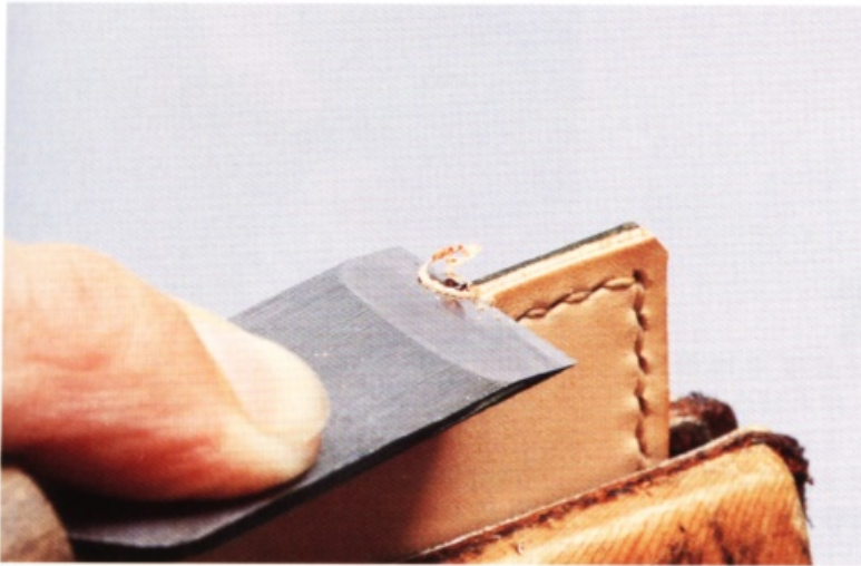
確認黏合後的主體A與B的側面是否平整，如果該部分還有高低差，可用裁皮刀整平，或是用削皮器等來作業。
