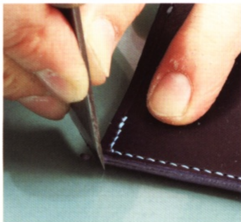
56 使用裁皮刀將邊角裁掉。放置在膠板之類的高處作業會比較穩定，而且裁邊的時候也比較方便。
