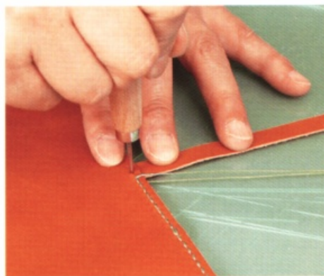
12 待皮革黏合的部分乾燥後，以主體的菱形孔為基準，用菱形錐打通皮革。 菱形孔打通之後，用相同的方式繼續往前縫合。
