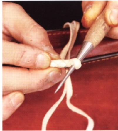
68 用菱椎在編織好的皮繩前端（兩條皮繩交差的空隙）打孔，然後把孔弄寬一點，將後袋身的兩條皮繩穿過此孔。
