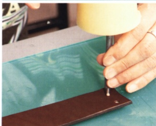
21 作業途中把兩個部分稍微分開一下。用丸斬在圓錐記號處打孔，記得要讓拼貼皮革C以重疊的狀態來進行。
