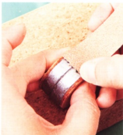
11 直到滲入雙方的黏膠都乾燥之後，用捲動的方式從削薄的那一端開始，將床革與鉛塊側面彼此緊密黏合。
