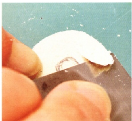
36 使用工具將皮革從中心到邊緣的部分，斜削約0.8~1mm厚，讓扣子反面的接著部分不會太厚。
