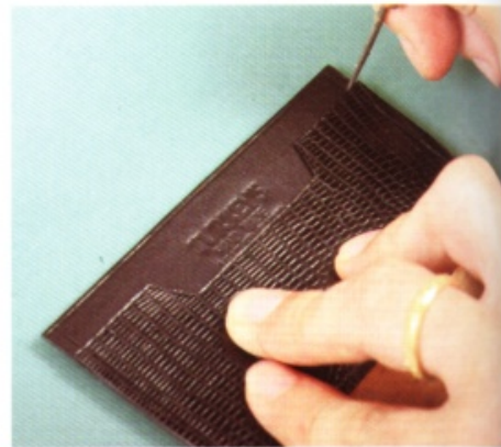
12 在黏合卡片夾層處，使用圓錐做記號確定接著的位置。
