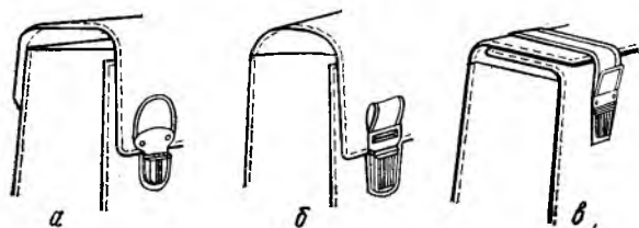
Рис. 1.55. Способы закрывания портфелей клапаном
