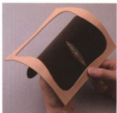
08 以90度左右的角度為基準，一邊彎曲皮革一邊進行貼合工作。
