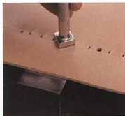
14 將皮革放在萬用環狀台上，敲打固定釦來進行安裝工作。
