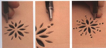
14 用丸新來進行花紋的打孔工作時，也一樣要配合描繪線先做出輪廓，然後在均等的位置上進行打孔工作。
