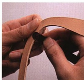
17 用磨砂棒削掉並處理切斷面的毛邊部分。
