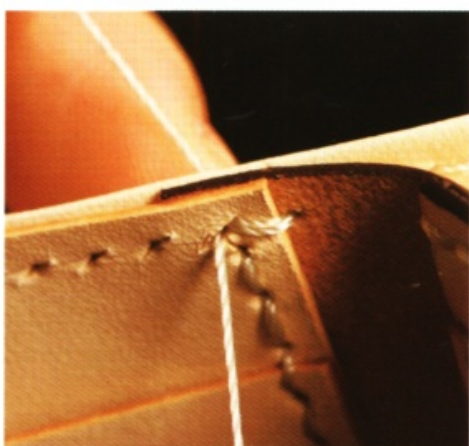
24 邊緣處以雙線繞縫的狀態，拉緊縫線時，力道不能大到使皮革起皺。
