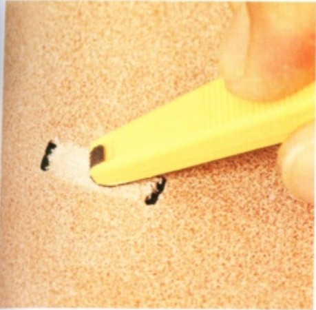
27 把皮繩孔的床面磨粗，再將皮繩穿過孔洞。
