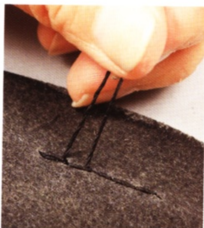
35 在等待零錢夾層乾燥的時候，製作卡片夾層的部分。縫製剛才鑿出的縫孔。最後從床面穿出就完成了。
