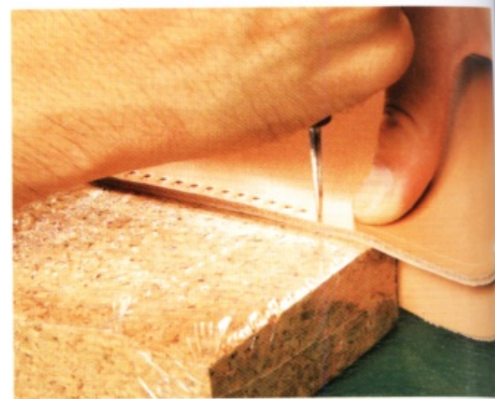
8 用手開間距規拉出縫線溝槽，再以 5.5mm 寬的孔距壓出印記。最後用菱斬鑿出縫線孔。
