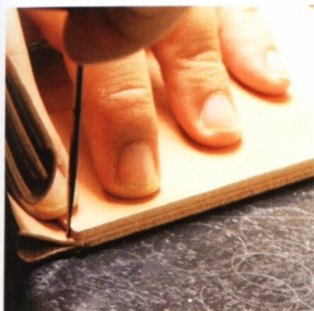
45 拉出縫線溝槽，用菱錐在兩端鑿出孔洞，並在銀面留下印記。
