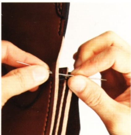
9 進入縫合。準備長度充裕的縫線，從第二個縫線孔縫起，重複縫製兩次。
