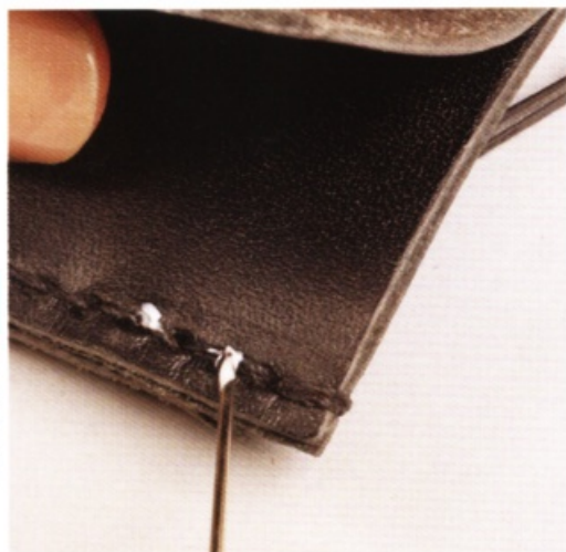
44 把白膠抹在剪掉的縫線上，固定線頭。進行至此，零錢夾層的部分就完成了。
