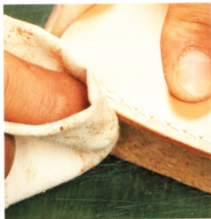
5 結束縫合以後，削掉已縫合部分的皮革邊緣。接著抹上背面處理劑，用布打磨毛邊。
