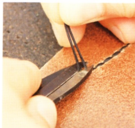
10 從尾端剪掉從床面穿出的縫線。
