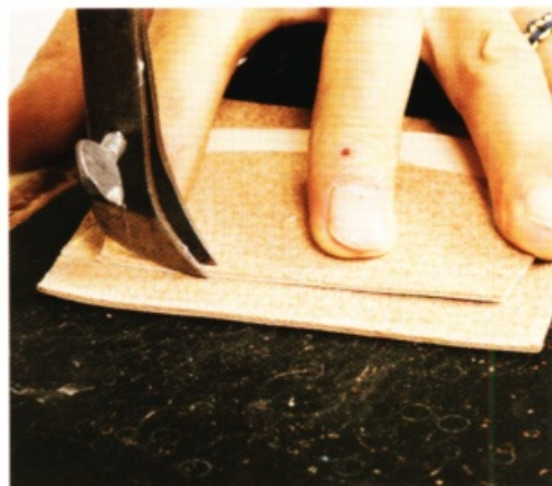
16 皮革重疊之處已經削掉一部分了，所以厚度不會太厚。貼合後，把邊緣器的寬度調為 3mm 寬，在下端拉出縫線溝槽。接著用菱斬壓出縫線孔的印子，再以菱斬鑿出縫線孔。
