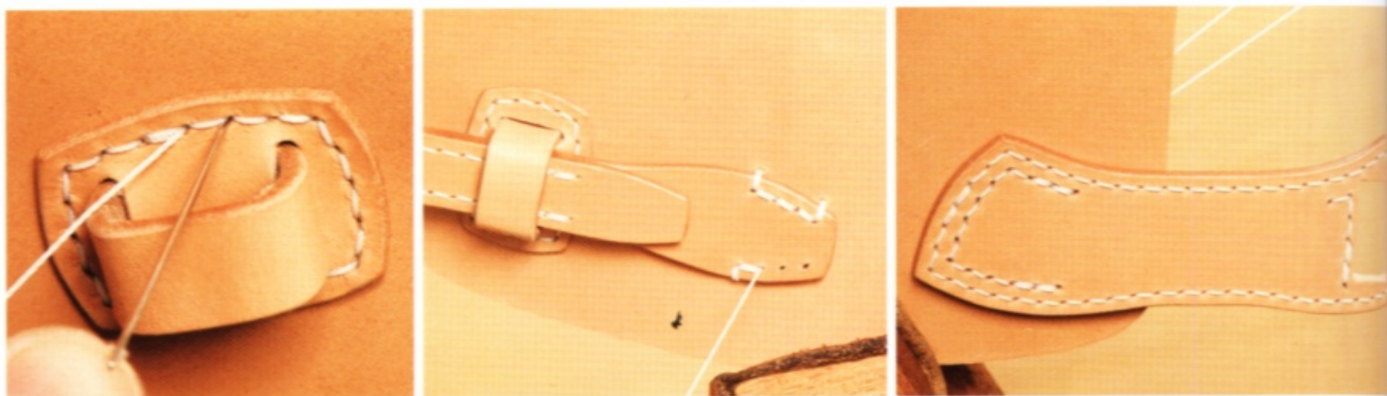
28 首先縫合皮環。用平針縫縫合外圍，只有最後兩針重複縫合兩次，再把針從床面穿出就結束了。再把插銷式皮帶插入皮環，繼續縫合。最後縫合馬鞍片。剪掉多餘的縫線後，燒融。
