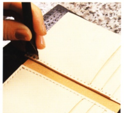
36 沿著重疊的基準線，用菱斬鑿出縫線孔。
