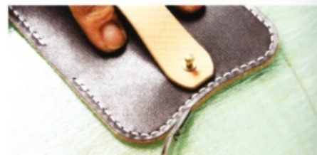
17 縫合。縫合完畢後，固定針腳，單獨削 除銀面的皮革邊緣。
