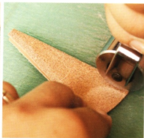
8 壓出摺痕後，修整毛邊。也將邊皮對折，折出印痕。
