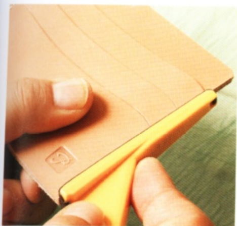
28 切掉不齊的部分後，用三角研磨器再次打磨毛邊。如果改用裁皮刀，可以將毛邊修整得更加漂亮。
