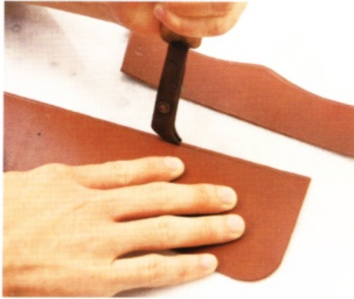
1 以邊線器在各部分的皮革上拉出縫線溝槽。包括各卡片夾的上端、零錢夾袋蓋部分的銀面上端。
