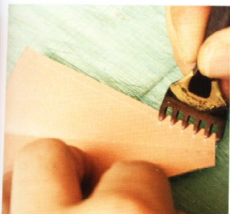
9 在邊皮拉出縫線溝槽，用菱斬壓出印記。接著在摺疊的狀態下，把下端的直角稍微削尖。
