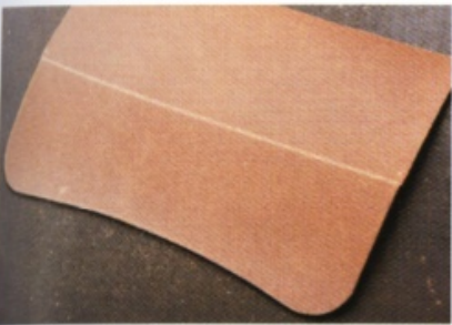
11 毛邊處理完畢後，為了折出零錢夾層的蓋子部分，用橫線將印記相連。
