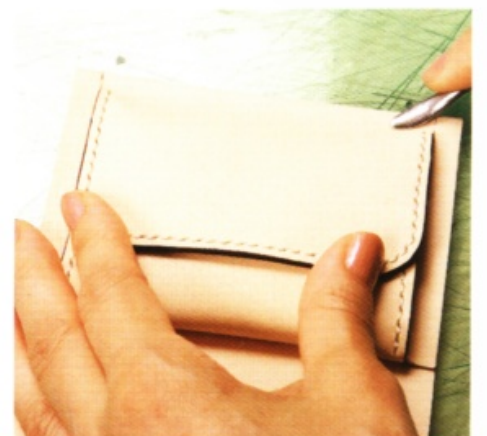
12 使用壓插器，按壓接著面。小心不要使皮革受損。
