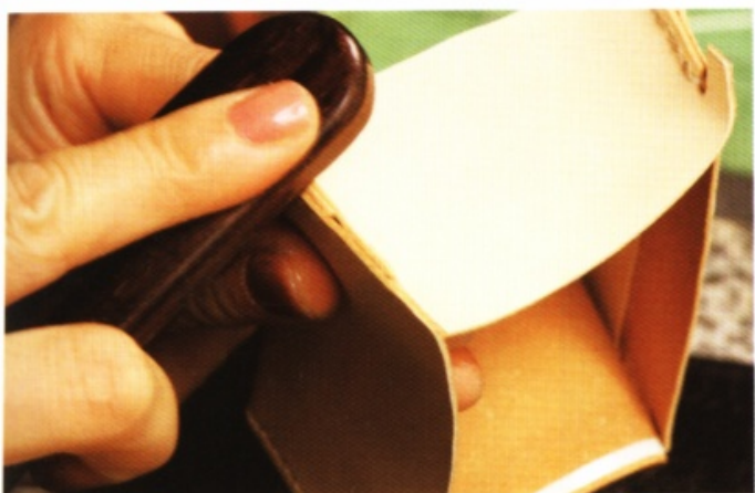
23 先用少量的水分沾濕皮革再打磨毛邊。
