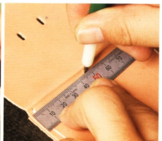
21 削去皮革邊緣後，打磨毛邊。為了能筆直地安裝好皮帶，先在正中央標出記號。
