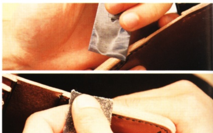
12 下一步是修整毛邊。先用裁皮刀大略修整，再用砂紙仔細打磨。
