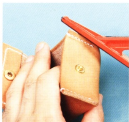
1 以三用研磨器或美工刀切掉毛邊多餘的部分。三用研磨器用起來較容易上手，不過用美工刀也能切得很平整。
