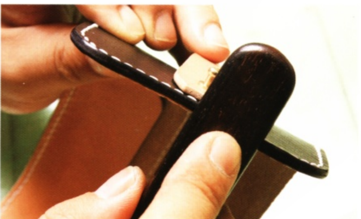
28 接著使用木製修邊器，打磨主體上半部和袋蓋的部分。
