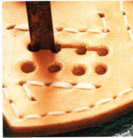
8 將雕刻刀的丸刀伸入圓孔，一路割開。如照片右所示，很輕易地便能將整塊皮革割下來。
