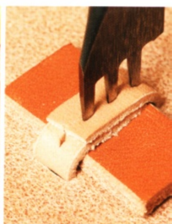
30 把做好記號的內側磨粗。抹上橡皮黏膠，黏合。在中央拉出縫線溝槽，再以菱斬鑿出縫線孔。
