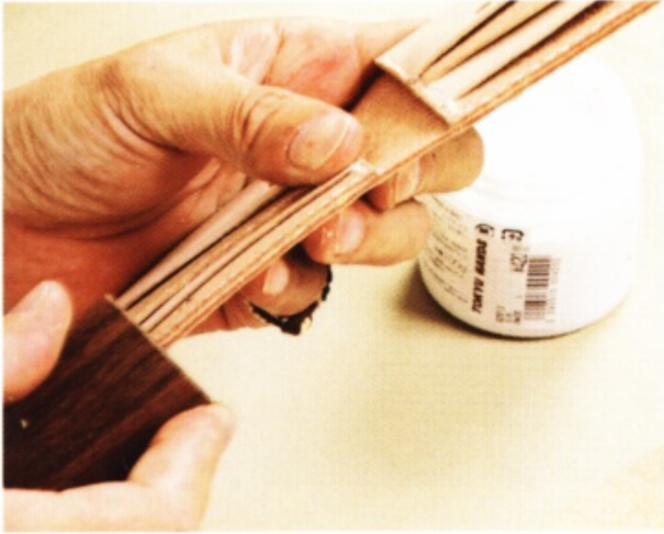
15 左右兩邊的卡片夾層和主體②的上端都縫合完畢以後，把毛邊打磨得光滑平整。
