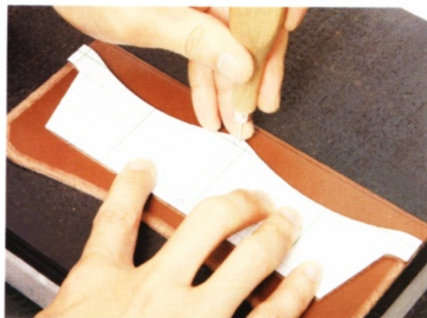
6 把紙型置於卡片夾層F，用圓錐在上下的中央位置作出記號。
