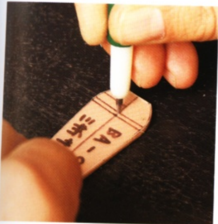
5 接著把紙型放在皮帶上，標示出打洞的位置。
