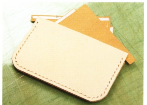
12 剪掉從邊皮穿出的多餘縫線，再處理線頭。圖中為縫合完畢的狀態。
