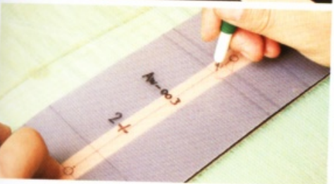
7 把皮帶的位置調整到正中央，用力壓牢。接著放上紙型，標示出縫線孔的位置。
