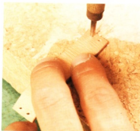
22 在兩端拉出 4mm 的縫線溝槽，再用菱斬鑿出縫線孔。
