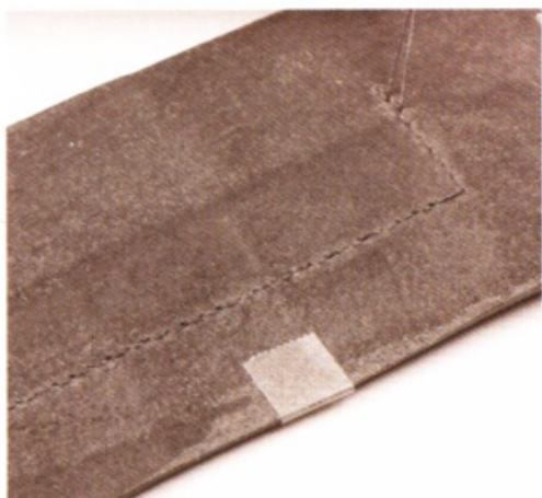
21 最後往後回縫一針，等於重複縫製兩次。最後從零錢夾層⑩回縫一針就完成了。
