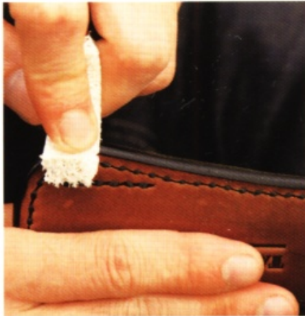
15 抹上背面處理劑後，先用毛巾打磨毛邊，再以菜瓜布輕輕打磨。
