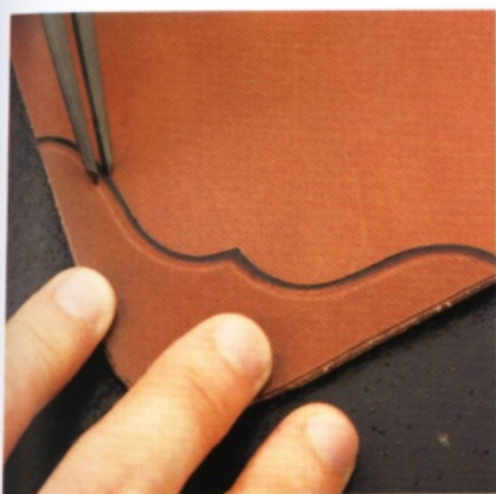
7 用手開間距規拉出縫線溝槽以便縫合。
