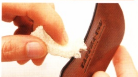
5 接著用毛巾打磨兩面的皮革邊緣。最後用絲瓜菜瓜布輕輕打磨。
