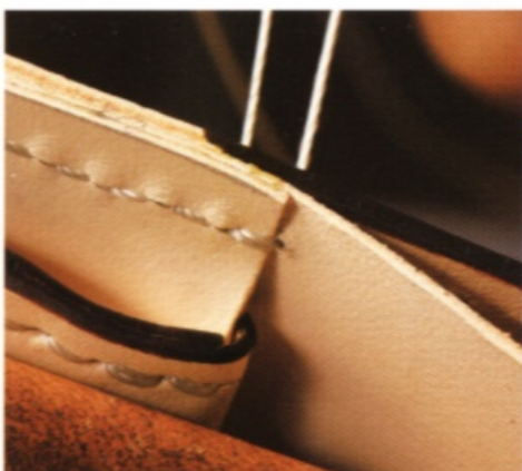
50 繼續縫合皮夾的下端，縫製到零錢夾層的邊緣後，把線單獨穿過外側。
