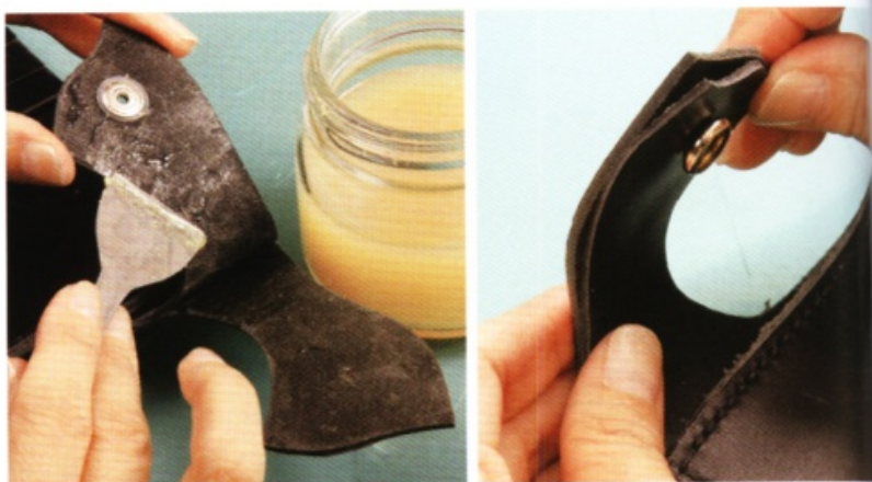
14 貼合帶狀部分。在兩面抹上橡皮黏膠，等到半乾再貼合。
