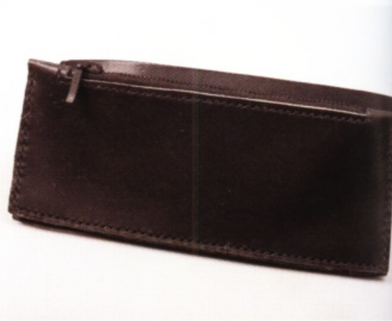
33 縫合完畢的狀態。接著要和零錢夾層和紙鈔夾層貼合。
