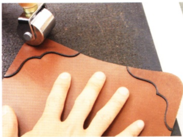
6 對齊邊緣，貼合。黏好後，用推輪滾壓，確保皮革已經黏牢。
