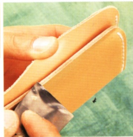
7 鑿開側邊的縫線孔後，貼合下側。抹上橡皮黏膠，修整黏合面的毛邊。
