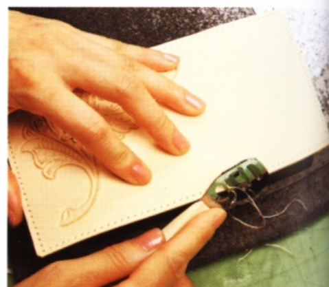
19 削掉4邊的皮革邊緣。內外兩面都用削邊器處理。
