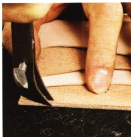
11 毛邊修整完畢後，用邊線器在上端拉出縫線溝槽，以菱斬壓下縫孔印。
