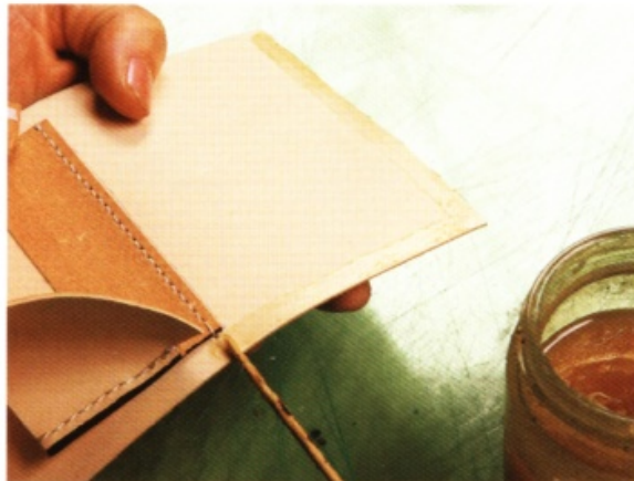
9 塗抹白膠，以便縫合。塗抹白膠的部分，剛好形成倒L型。
