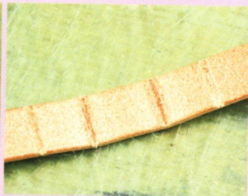
20 翻面，在皮環側邊拉出直線。像剛才一樣，先將直線削薄，再用水沾濕。最後折出摺痕。
