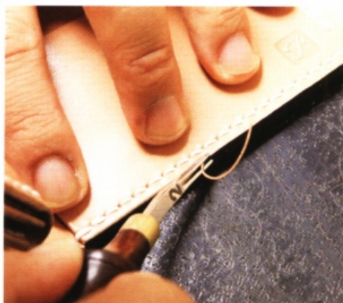
49 將毛邊染色。用蘸滿染料的棉花棒，均勻地塗抹在毛邊上。等到染料充分乾燥，再削掉背面的皮革邊緣。削掉皮革邊緣後，打磨毛邊。先抹上 CMC，再以木製磨邊器打磨。
