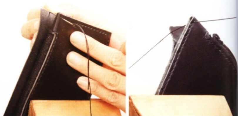
31 鑿出孔洞後，縫合。用兩支針交叉的方式從開始縫合到最後。
