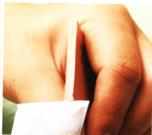
28 切掉不齊的部分後，用三角研磨器再次打磨毛邊。如果改用裁皮刀，可以將毛邊修整得更加漂亮。
