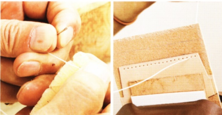
11 準備長度超過 1 倍的麻線，用線蠟打磨。把針穿過第二個縫線孔後，對齊左右縫線的長度。
