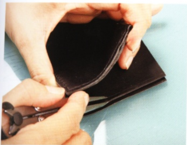
39 利用等待卡片夾層乾燥的時間，回頭製作零錢夾層。首先用手開間距規在3個邊拉出縫線溝槽。
