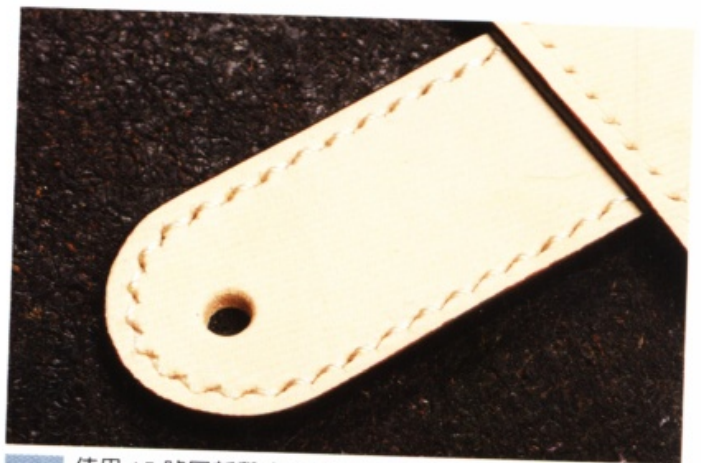
33 使用 15 號圓斬鑿出安裝四合釦的孔位。
