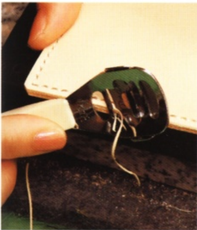
31 削掉皮革邊緣，打磨毛邊。
