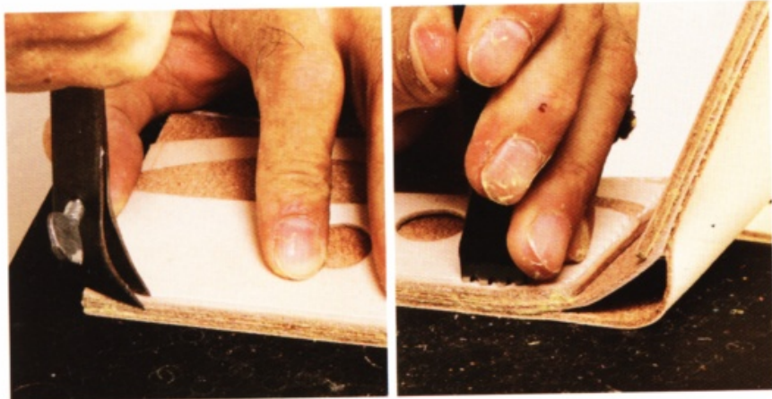
24 拉出縫線溝槽後，用菱斬壓出印痕，再以菱斬鑿出縫孔。
