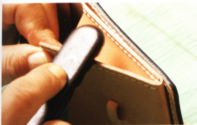
43 另一邊也縫合完畢後，將線頭敲扁，在毛邊抹上 CMC，再以木製修邊器打磨。至此，零錢夾層的部分就完成了。
