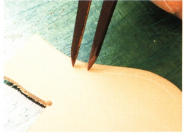
15 把手開間距調整為 5.5mm 寬，在線上壓出印記。
