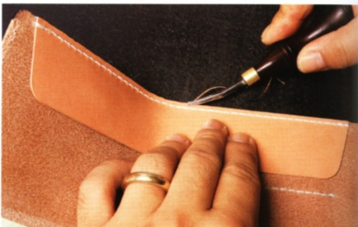
27 等到染料變乾，用削邊器削掉皮革邊緣。
