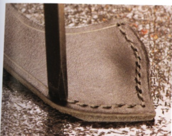
19 以邊角的鑽孔為起點，沿著以拉溝器拉出的縫線溝槽，用菱斬鑿出縫線孔。
