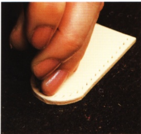
12 拉出縫線溝槽後，用菱斬鑿孔。曲線部分使用雙孔菱斬。
