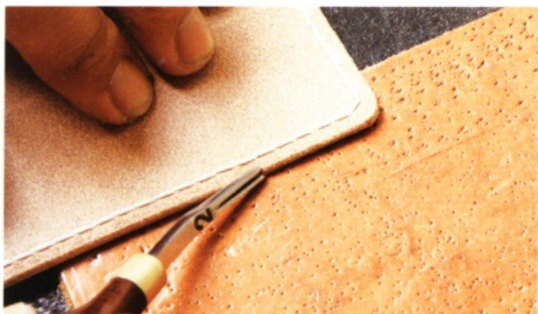
33 固定線尾，壓平針腳。接著削掉兩面的皮革邊緣。
