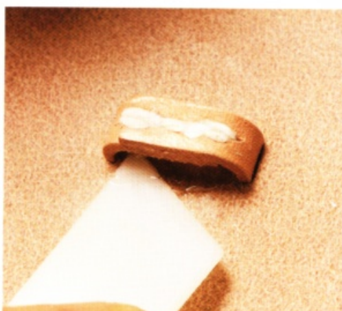
31 為了避免針腳變得太厚，使用麻線作為縫線。以重複縫製兩次的方式縫合。在內側（床面）抹上橡皮黏膠。
