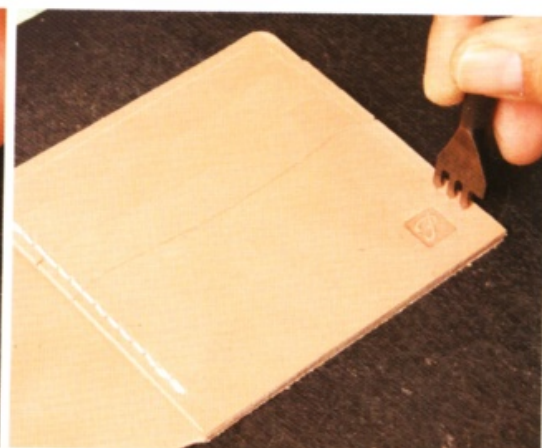
30 用菱斬在縫線溝槽壓出印記。和左側已經縫合的部分一樣，菱斬的印記要橫跨皮革的交會處。
