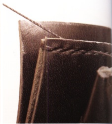
42 將針從邊緣穿出，再將左右縫線調整為等長。起針以雙線繞縫的方式組合，之後恢復普通的平線縫。
