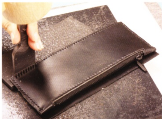
30 下面墊張橡膠板，沿著縫線溝槽，用菱斬鑿出ㄇ字型的縫線孔。
