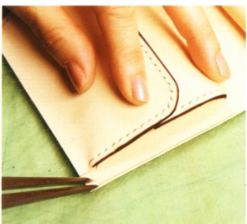
17 以調整為3mm寬的手開間距規，在內側的上端拉出縫線溝槽。再以菱斬鑿出縫線孔。
