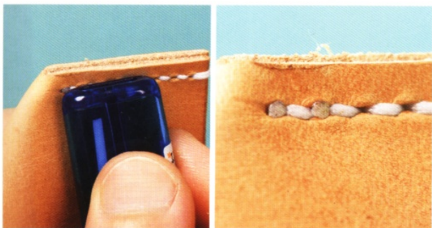
13 利用打火機的底部，將縫線壓扁。
