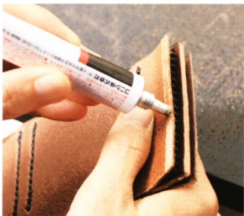
26 卡片夾層的兩側也抹上白膠，黏合。對齊邊緣貼合後，將皮革壓牢。
