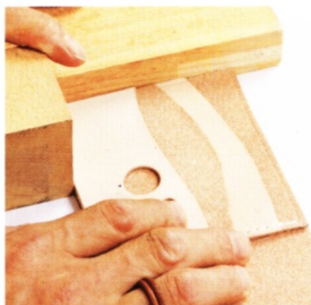
5 把卡片夾層黏合於②。黏合時，可利用木塊當作輔助工具。要領和使用三角板相同。另外，另一邊卡片夾層的銀面也要磨粗。
