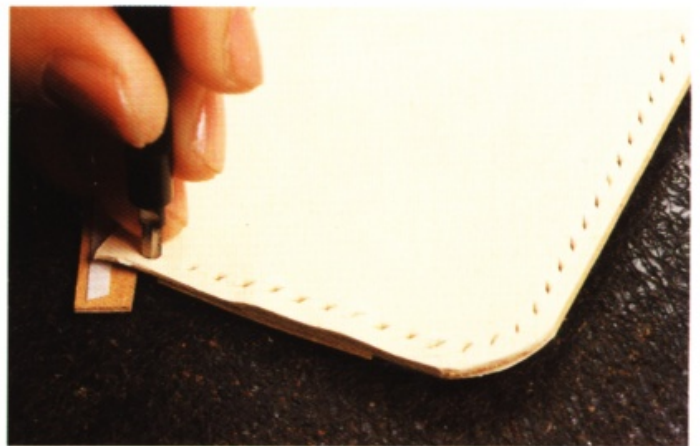
10 使用單孔菱斬，調整菱斬之間的間隔。
