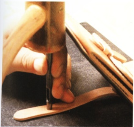
55 也用圓斬從床面鑽出孔洞。使用細棒，把孔內的毛邊打磨平整。
