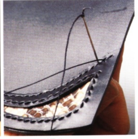
13 接著以內外兩支針保持交叉的方式縫合。縫到最後一個縫線孔後，往後回縫一針。再從銀面回縫 1 針。
