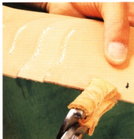
7 縫合好卡片夾層後，抹上橡皮黏膠，貼合。仔細將皮革壓牢。
