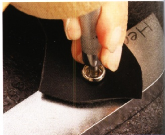
12 在皮革下放塊鐵片，用四合釦工具敲打。
