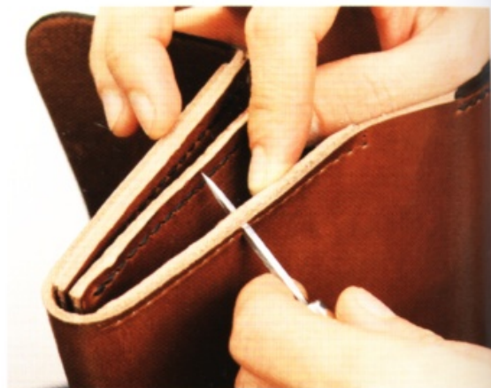
8 貼合後，用菱斬確實將縫線孔鑿開。
