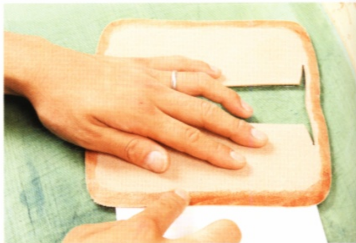
30 在主體裡面②的床面塗抹橡皮黏膠。
