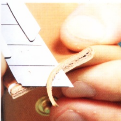
1 以三用研磨器或美工刀切掉毛邊多餘的部分。三用研磨器用起來較容易上手，不過用美工刀也能切得很平整。
