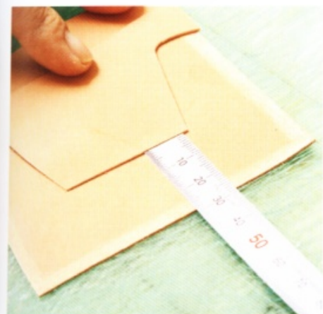
7 因為要用拉溝器拉出縫線溝槽，所以要量出距離溝槽的長度。
