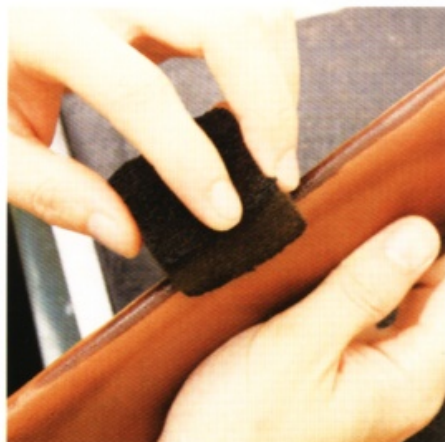
13 折出一定深度的摺痕後，將皮革往正面折。折出摺痕的同時，一樣用沾水的海綿擦拭。
