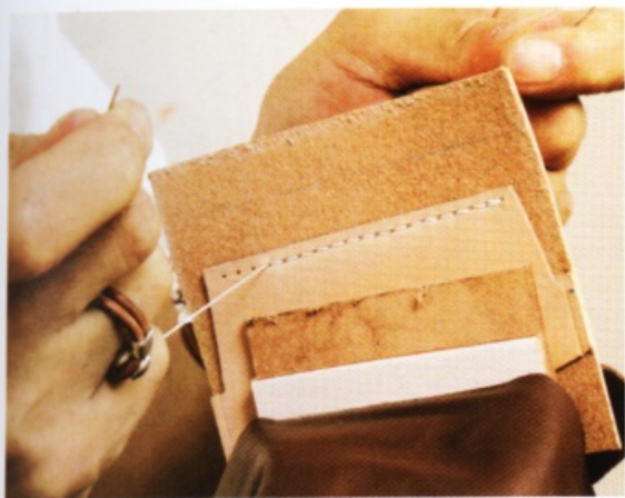
13 只有起針縫合，接下來就以 2 支針保持交叉的方式縫合交叉縫。一直縫到最後一個孔洞。
