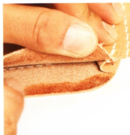
7 鑿開側邊的縫線孔後，貼合下側。抹上橡皮黏膠，修整黏合面的毛邊。
