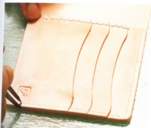
29 在上端和右側拉出縫線溝槽。跳過 R 部分。
