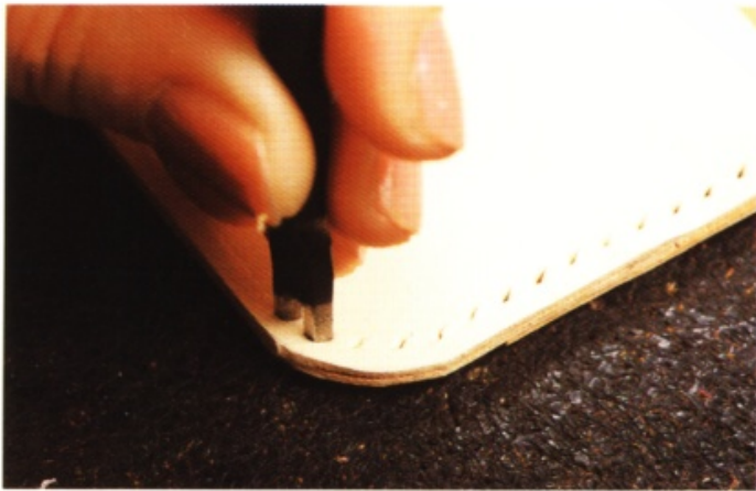
9 邊角的曲線部分，使用 2 孔菱斬鑿孔。
