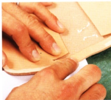
2 塗抹橡皮黏膠。從零錢夾層貼起。
