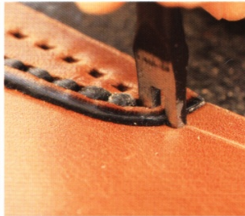
5 以皮革重疊處的記號為起點，在拉好的縫線溝槽上壓出印記。接著用菱斬鑿出縫線孔。
