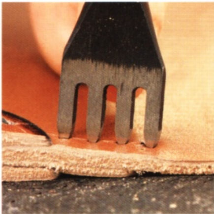
5 以皮革重疊處的記號為起點，在拉好的縫線溝槽上壓出印記。接著用菱斬鑿出縫線孔。
