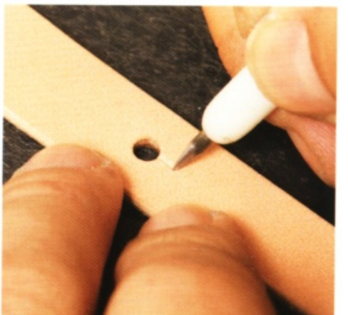
56 用鐵筆從打好的孔洞畫下5~6mm長的線條。
