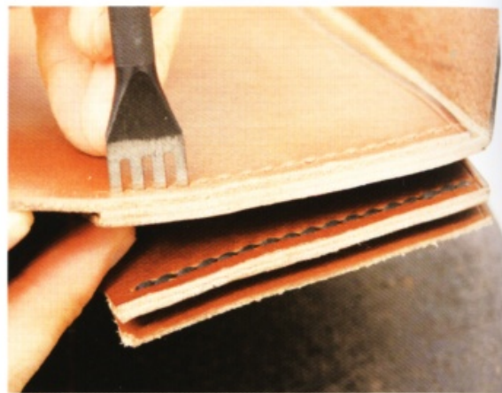
31 用菱斬在印記上鑿出縫線孔。也同樣鑿出另一邊的縫線孔。
