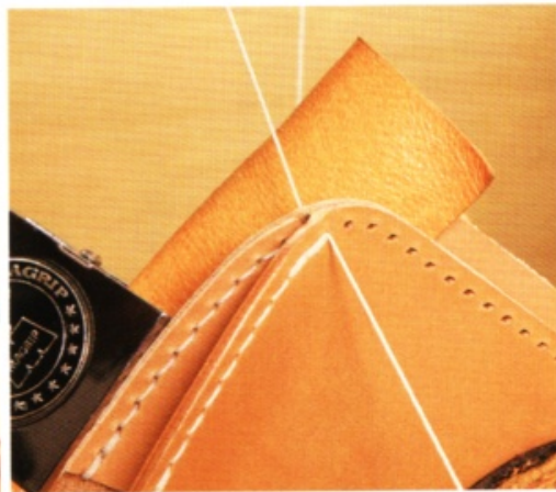
9 縫合前先墊張保護用皮革，以免損傷到其他部位。前兩針重複縫合兩次，之後恢復一般的平針縫。和剛才縫好的邊皮的重疊部分用雙線繞縫，另一邊的邊皮也是。縫到最後再往後回縫 1 針半，另一邊的邊皮也比照辦理。
