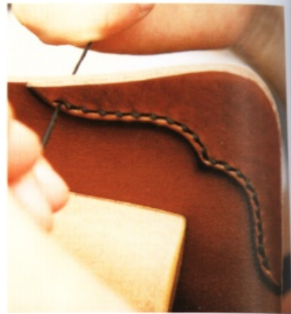
10 縫合。前兩針重複縫製兩次，縫到最後再往後回縫 2 針半就算結束。
