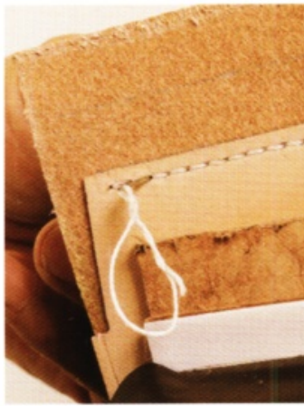
14 縫完最後一個孔洞，再往後回縫兩針就完成了。這時，線會從兩側穿出。剪掉多餘的線，用皮革滾輪壓平針腳痕跡。
