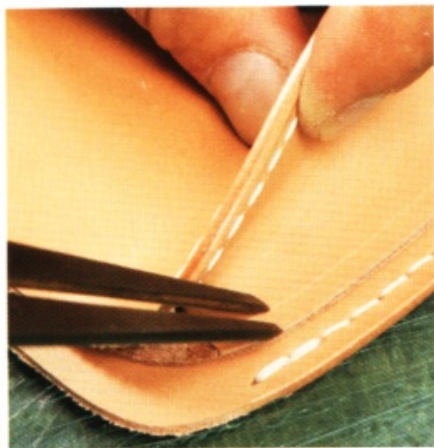
5 用裁皮刀修整皮革邊緣。左右兩邊都修整完畢後，用手開間距規拉出縫線溝槽。
