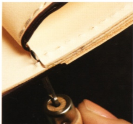
46 用菱錐鑿開縫線孔，連零錢袋的底層也鑿通。
