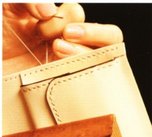
22 從零錢夾層開始縫合，一直縫製到線穿過卡片夾層。
