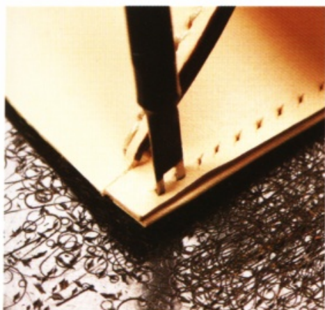
21 使用雙孔菱斬調整間距。要先預留最旁邊的縫孔與邊緣的位置。
