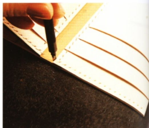
18 對折的部分必須以雙線繞縫，所以用單孔菱斬鑿出縫線孔。
