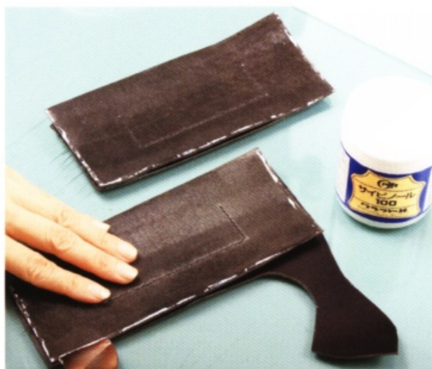
34 把零錢夾層和紙鈔夾層分別抹上白膠。除了上端，其他3邊都要上膠。貼好後，和剛才一樣，用夾子夾住邊緣，使其乾燥。
