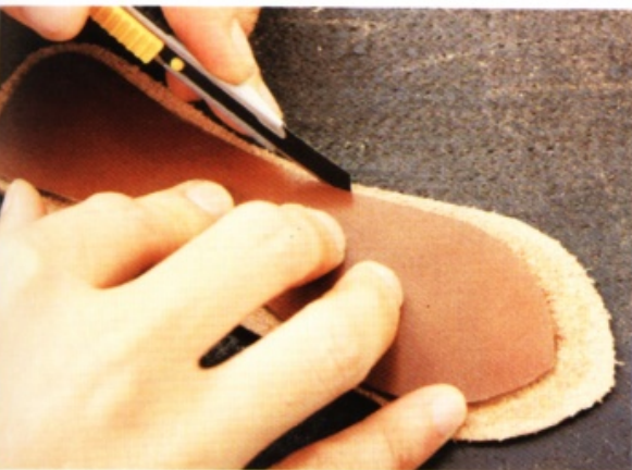
4 確實貼牢後，用美工刀裁掉多餘的部分。
