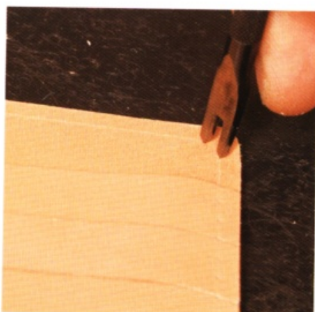
30 用菱斬在縫線溝槽壓出印記。和左側已經縫合的部分一樣，菱斬的印記要橫跨皮革的交會處。
