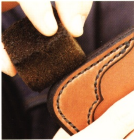
14 用沾水的海綿擦拭毛邊，再以敲打的方式抹上背面處理劑。
