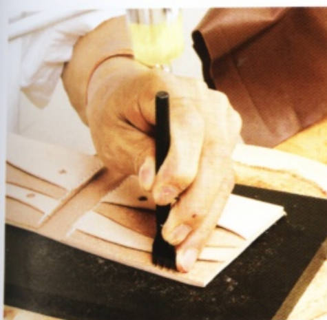
12 接著用菱斬鑿出縫線孔。接著，縫合上端。首先把針穿過右邊的第一個縫孔，以內側和外側的針交叉成十字的方式縫合。
