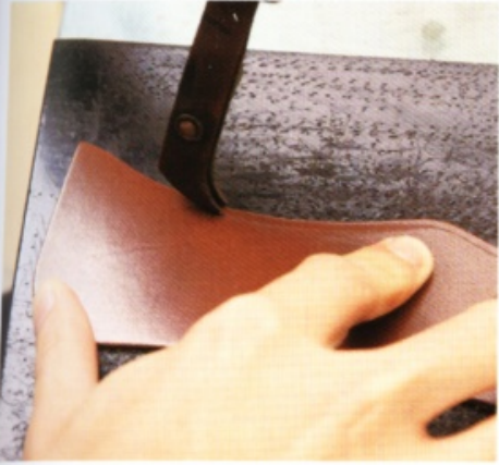
1 以邊線器在各部分的皮革上拉出縫線溝槽。包括各卡片夾的上端、零錢夾袋蓋部分的銀面上端。
