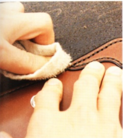
15 抹上背面處理劑後，先用毛巾打磨毛邊，再以菜瓜布輕輕打磨。
