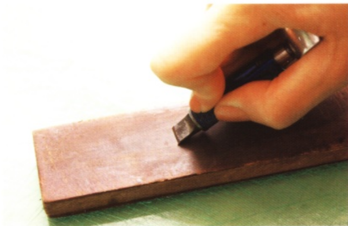
8 用旋轉刀研磨。如果要磨刀，可用含有青棒或赤棒的磨刀石。
