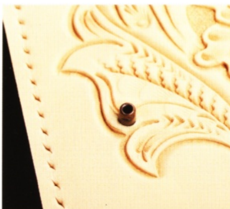
37 從內側將底座片穿出皮面，再把上片放於底座片上方。
