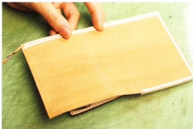
41 為了讓外側①和內部⑫結合，在兩者塗抹白膠和貼上雙面膠帶。
