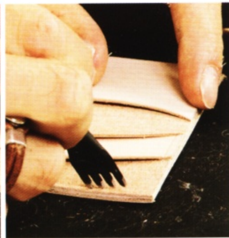
11 毛邊修整完畢後，用邊線器在上端拉出縫線溝槽，以菱斬壓下縫孔印。
