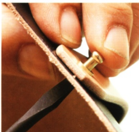
14 用一字螺絲起子旋上原子釦。暫時保 持鎖上的狀態。
