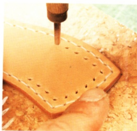
24 接著在馬鞍片拉出 8mm 寬的縫線溝槽，呈 U 字型。用菱斬鑿出縫線孔。
