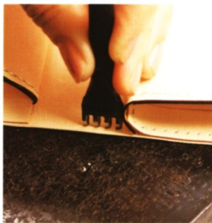
20 用4孔菱斬再次在主體已鑿出縫孔的位置鑿孔。
