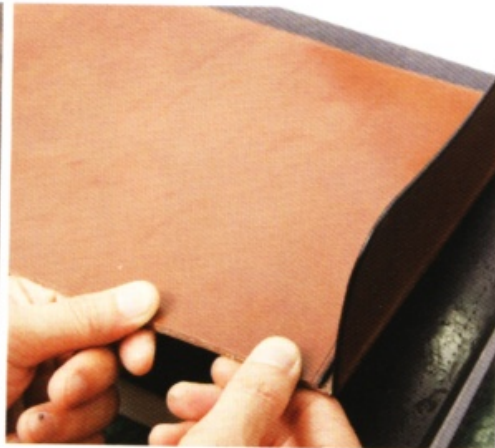
24 將零錢夾層貼合在主體。仔細對齊邊緣貼合後，將皮革壓牢。
