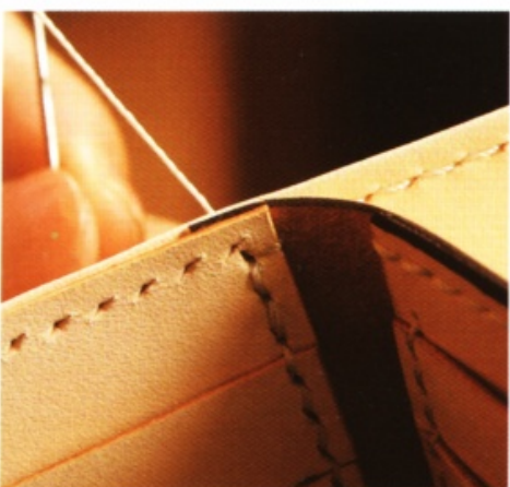
23 為了補強縫線的強度，縫線要繞過卡片夾層的邊緣。
