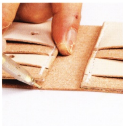
6 比照左側的處理，也在右邊標示出記號。把コ字型的區塊磨粗後，抹上白膠。
