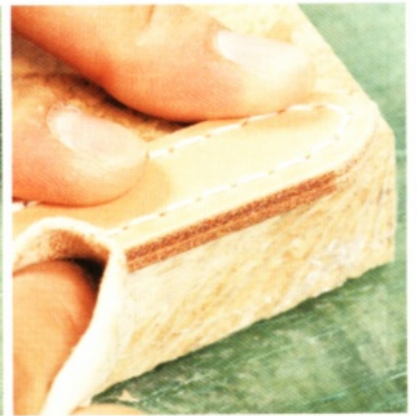
12 縫合完畢後，削除兩面的皮革邊緣，再將毛邊打磨得光滑平整。
