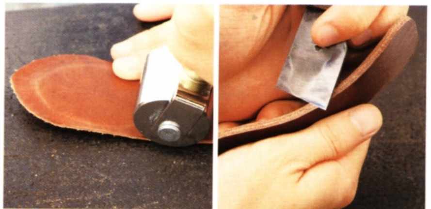
5 再以推輪滾壓。最後用裁皮刀修整毛邊。
