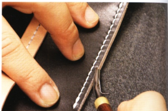
48 單獨削落染色那面的皮革邊緣。
