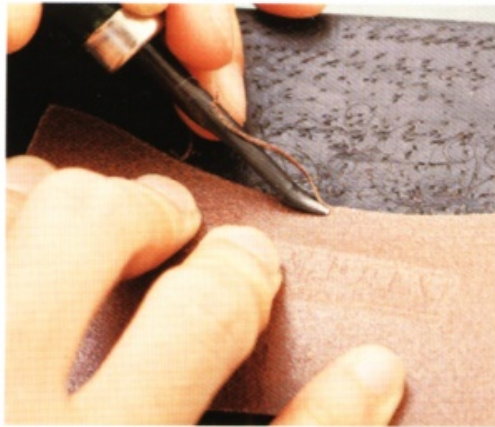
2 削掉卡片夾層等待會不易處理的部分的皮革邊緣。使用削邊器，削掉兩面的邊緣。
