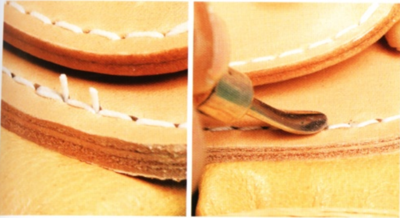
20 線尾用打火機燒融後壓平。
