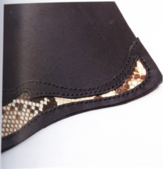
10 鑿出裝飾用皮革內側和上端的縫線孔後，縫合。
