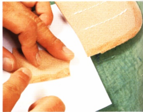
8 接著貼合卡片夾層的邊皮。抹上橡皮黏膠，貼得稍不整齊。
