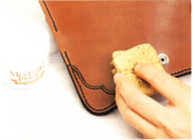
16 在銀面均勻地抹上野馬油 (Mustang Paste)。靜置約 1 小時使其乾燥，再擦掉多餘的油脂。
