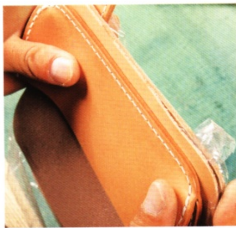
4 貼合。在兩塊皮革之間墊塊塑膠板，先對齊邊緣，從上端慢慢貼合。
