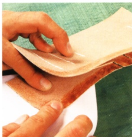
7 縫合好卡片夾層後，抹上橡皮黏膠，貼合。仔細將皮革壓牢。
