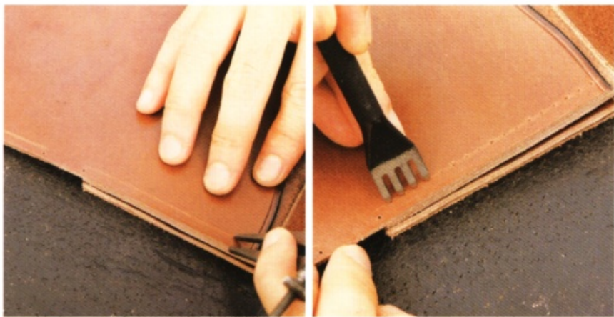
30 在零錢夾層的下端也拉出縫線溝槽，再用菱斬在上面壓出印記。
