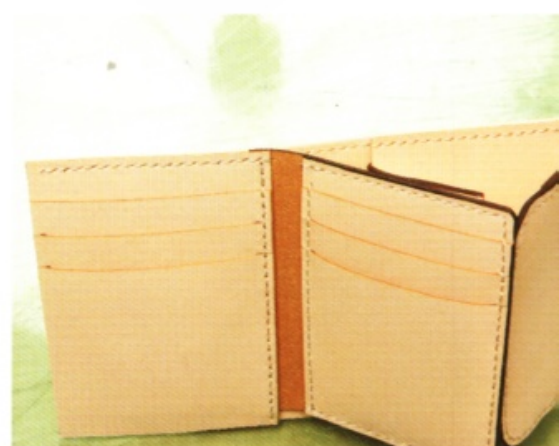
25 圖中是上端縫合完畢，卡片夾層和零錢夾層以固定於主體的狀態。
