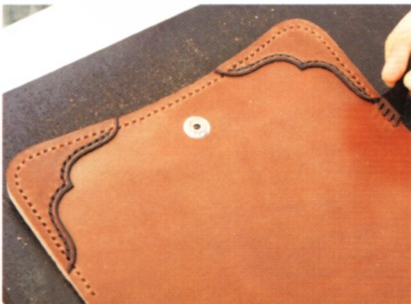
6 遇到重疊之處很多的部分時，先用菱斬鑿出大略的孔洞，再以菱錐確實將孔洞鑿開。
