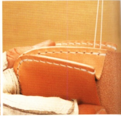
9 縫合前先墊張保護用皮革，以免損傷到其他部位。前兩針重複縫合兩次，之後恢復一般的平針縫。和剛才縫好的邊皮的重疊部分用雙線繞縫，另一邊的邊皮也是。縫到最後再往後回縫 1 針半，另一邊的邊皮也比照辦理。
