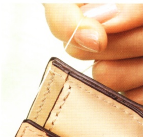
56 繼續縫合上端，縫到最後再往後回縫3針。剪掉多餘的縫線。
