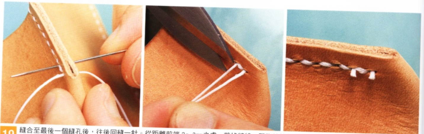
18 因為皮革的接縫處可以活動，所以縫線要拉得稍微緊一點。
