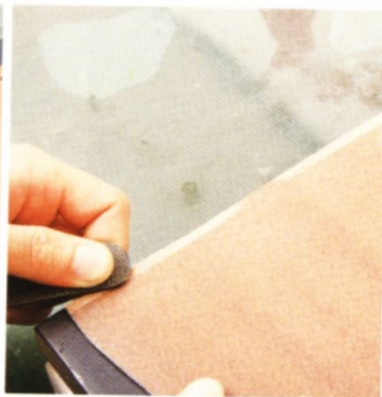
22 用圓錐鑿開本體銀面的記號，深度深及床面。再把記號下方的部分磨粗。
