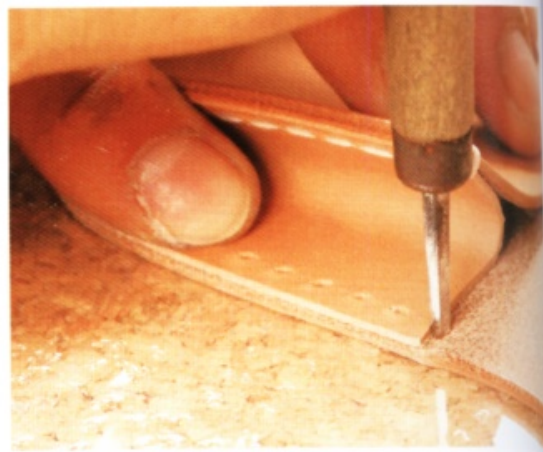
6 再把手開間距規調整為 5.5mm 寬，沿著溝槽壓出印記。再用菱斬鑿開孔洞。
