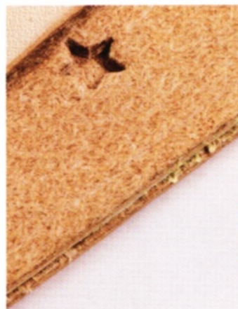
9 因為從下端對齊再黏，造成上端會有些不整齊。所以利用這個時候修整毛邊。
