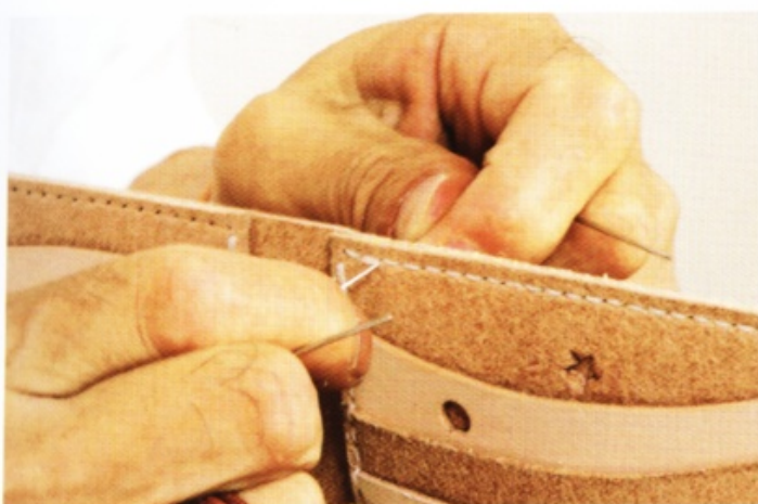
13 縫製到最後一個縫孔後，往後回縫兩針。從剪掉兩面多餘的縫線，壓平針腳。
