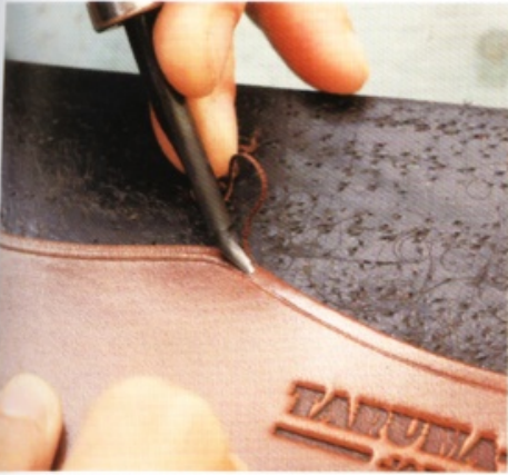
2 削掉卡片夾層等待會不易處理的部分的皮革邊緣。使用削邊器，削掉兩面的邊緣。
