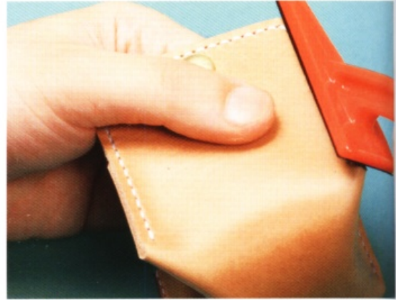
9 如果用美工刀不好切，改用三角研磨器分次削掉皮革。
