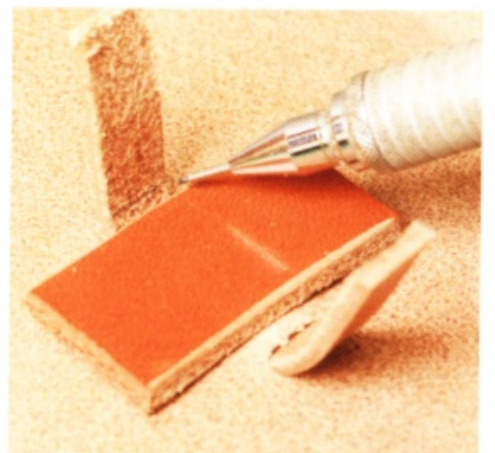
28 選塊厚度和皮帶相同的皮革替用，比對尺寸是否合適。在較厚的一面作記號。
