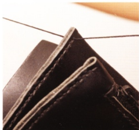
43 收尾和起針相同，以雙線繞縫後，往後回縫一針。再將表面的針穿過背面，輕輕拉緊縫線。最後剪掉多餘的縫線。
