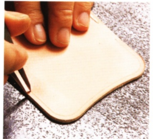
17 用手開間距規在深及銀面的標記之間拉出縫線溝槽。
