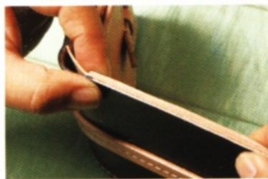
44 接著貼合卡片夾層。單獨在卡片夾層下方塗抹橡皮黏膠，再貼合於主體。因為是點對點的貼合，所以主體自然彎曲。貼好後，修整毛邊。
