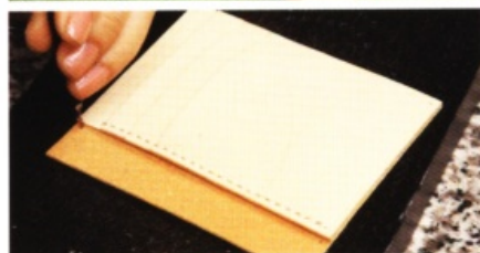
26 把手開距規調整為3mm寬，在上下的邊緣拉出縫線溝槽。
