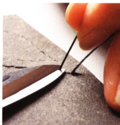
15 從尾端剪掉縫線。抹上背面處理劑，固定線頭。
