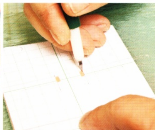
1 把蓋子③疊於零錢夾層②，用描寫筆在正面和床面的邊緣做記號。接著放上紙型，在床面邊皮的黏合部位標示出記號。安裝皮帶的皮環部分也要標示出來。再用皮帶斬鑿出皮環的孔洞。
