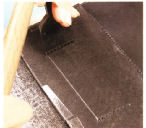
18 以拉成ㄩ字型的縫線溝槽為基準，用菱斬鑿出縫線孔。
