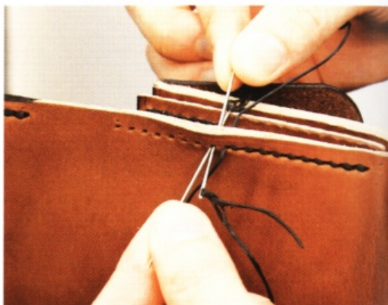
10 接著縫合另一邊。結束縫合以後，剪掉多餘的縫線，再用打火機燒融。
