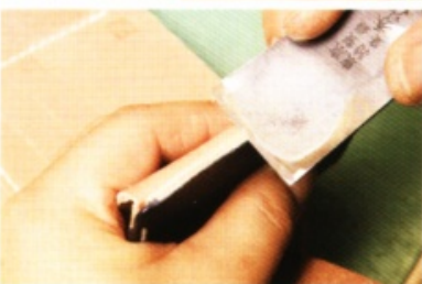
將主體與內裡貼合。把零錢夾層貼合在主體左側和下半部的L型部分。貼合後，修整毛邊。
