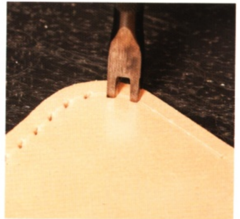
19 用菱斬在印記鑿出縫線孔。R部分用2孔菱斬。
