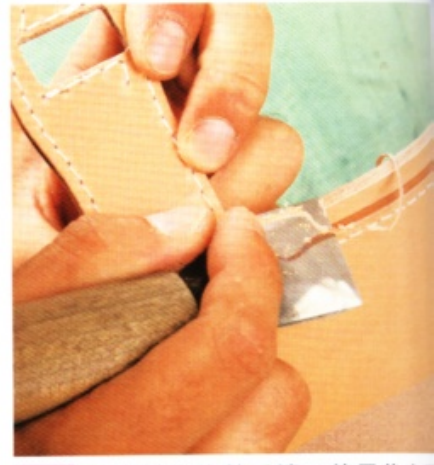
8 縫合前先修整毛邊。使用裁皮刀修整。
