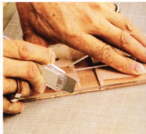
9 因為從下端對齊再黏，造成上端會有些不整齊。所以利用這個時候修整毛邊。
