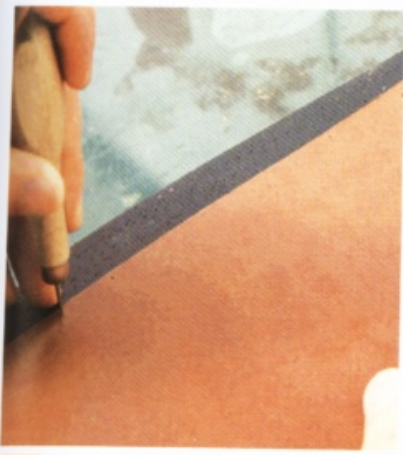
22 用圓錐鑿開本體銀面的記號，深度深及床面。再把記號下方的部分磨粗。
