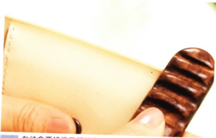
30 在待會要插進舌釦的零錢袋的毛邊抹上一點水，用磨緣器打磨。
