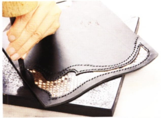
9 用菱斬在整張裝飾皮內側鑿出縫線孔。接著，也單獨在上端部分用菱斬鑿出縫線孔。
