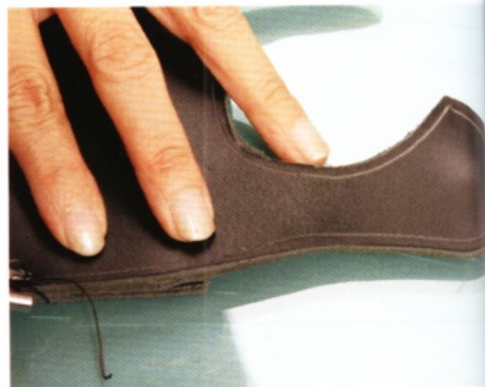
16 打磨完畢後，用拉溝器沿著皮革外圍拉出縫槽。
