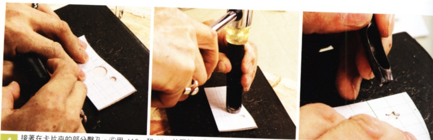
4 接著在卡片夾的部分鑿孔。⑥用 \phi 16\text{mm} 和 \phi 6\text{mm} 的圓斬，⑧用 \phi 4\text{mm} 的圓斬鑿洞。用花斬在⑦和⑩鑿出星形的孔洞。
