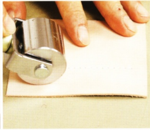
14 縫完最後一個孔洞，再往後回縫兩針就完成了。這時，線會從兩側穿出。剪掉多餘的線，用皮革滾輪壓平針腳痕跡。
