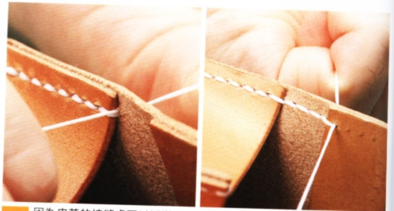
18 因為皮革的接縫處可以活動，所以縫線要拉得稍微緊一點。
