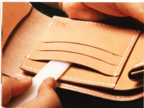
50 把上膠片伸進卡片夾層，剝除裡面的黏膠。
