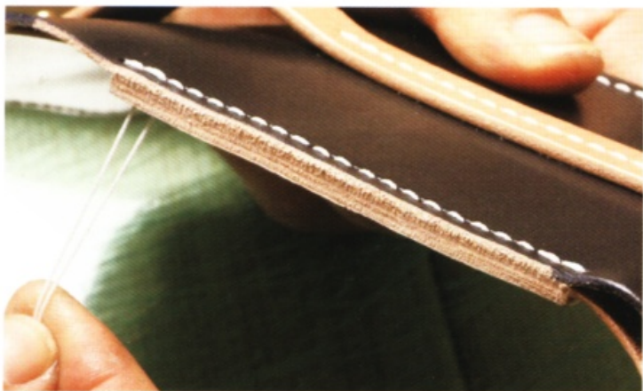
47 縫合。剪掉多餘的縫線。用打火機燒融線尾，再將針腳壓扁。
