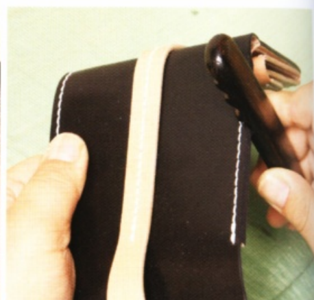
49 將毛邊染色。用蘸滿染料的棉花棒，均勻地塗抹在毛邊上。等到染料充分乾燥，再削掉背面的皮革邊緣。削掉皮革邊緣後，打磨毛邊。先抹上 CMC，再以木製磨邊器打磨。
