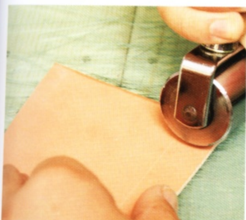
7 用推輪壓出摺痕。先將皮革沾濕，是為了防止裂開。
