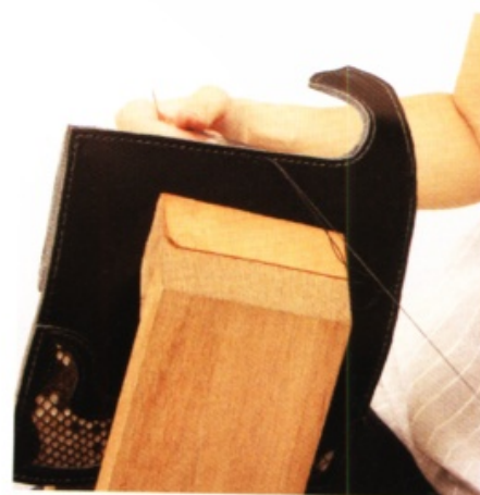
22 外圍以兩針交叉的方式縫合。因為縫合距離很長，記得先用線蠟打磨縫線。
