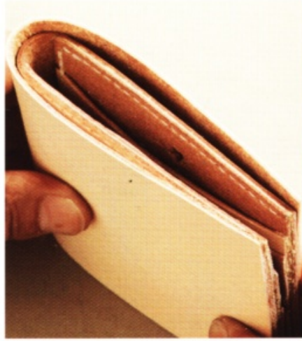
16 接著縫合主體①。首先用三角研磨器將卡片夾層的銀面磨粗。
