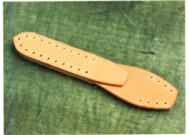
10 接著縫合插釦的配件。準備長度綽綽有餘的縫線。
