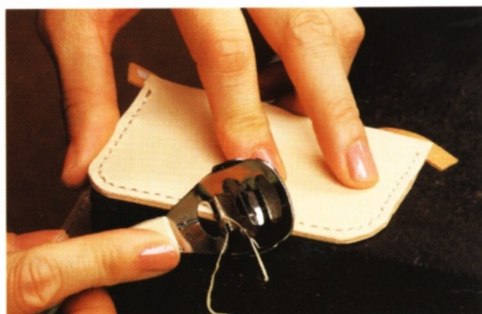
22 用削邊器削去零錢夾層的皮革邊緣。除了表面，也別忘了背面。
