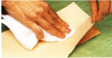
8 接著黏合主體的兩片皮革。黏合後，一樣緊壓皮革，使其稍微往內彎曲。
