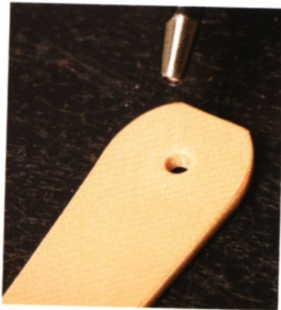
6 用圓斬鑽出安裝原子釦的孔位。在皮帶和主體塗上橡皮黏膠，再將皮帶輕輕置於主體。
