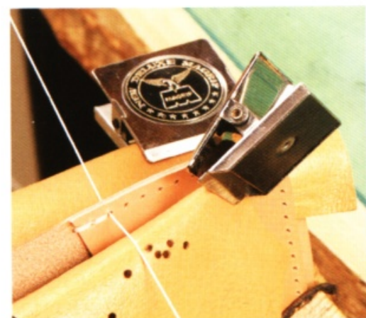
9 縫合前先墊張保護用皮革，以免損傷到其他部位。前兩針重複縫合兩次，之後恢復一般的平針縫。和剛才縫好的邊皮的重疊部分用雙線繞縫，另一邊的邊皮也是。縫到最後再往後回縫 1 針半，另一邊的邊皮也比照辦理。
