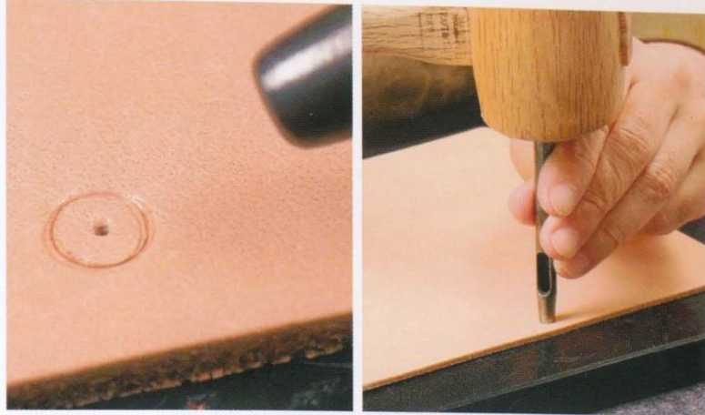
2 將符合環釦尺寸的工具鑿孔，圖中使用的工具是12號。先輕壓工具，使其在皮革上留下記號之後，再以木槌敲打。
