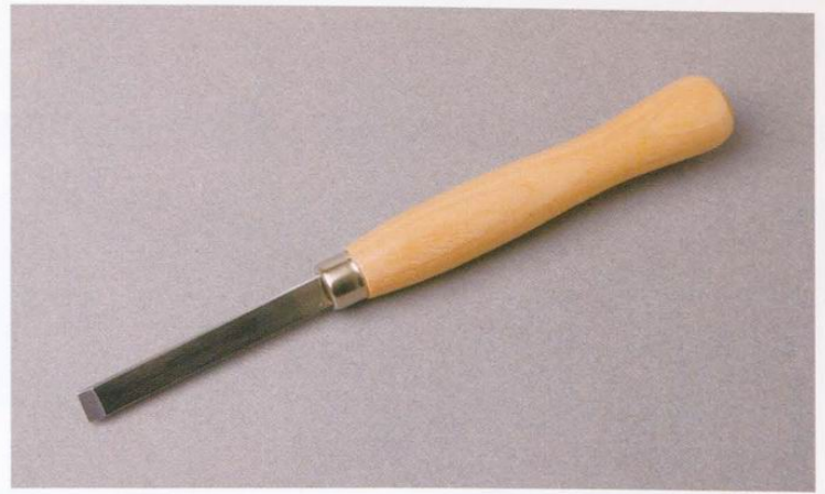
6mm寬的平錐 在圓斬所鑿出的孔與孔之間，切出一條開口時使用。
