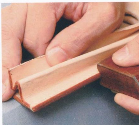
37 接著以木製磨緣器等工具打磨。需要打磨的位置包括內側、外側與側邊。經過充分的打磨之後，皮革邊緣便會出現光澤感。因為本作品的邊緣比較厚，如果使用三用磨緣器時，則必需將磨緣器橫著拿才能順利打磨。
