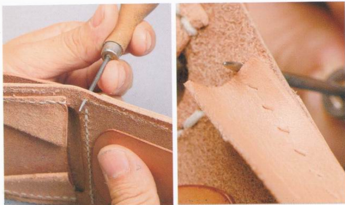
44 將袋身側邊的第2個縫線孔，與邊皮3的第1個縫線孔重疊。
