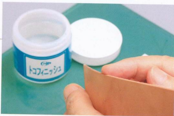
1 將床面處理劑塗在皮革側邊上。如果皮革比較薄，要注意別讓處理劑從邊緣溢出。
