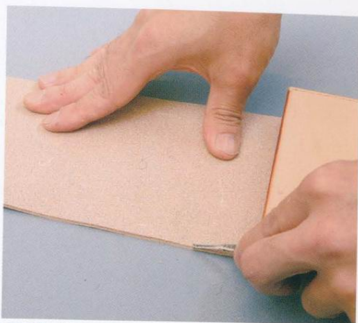
49 將與袋蓋縫合的部位與袋蓋本身的邊緣，以削邊器將邊緣削下。皮革正面與背面的邊緣都需要以削邊器處理。
