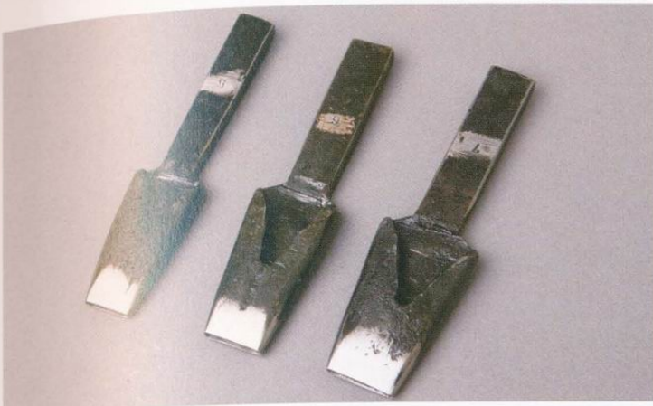
皮帶斬 (5號、6號、7號) 用以為皮帶上鑿出裝置皮帶扣的孔。
