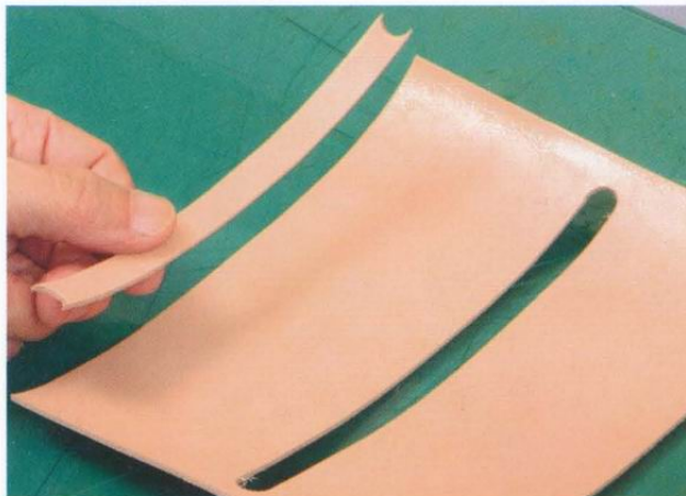
5 圖中為裁切出開口的零錢袋皮革。接下來將四個邊角也裁成圓弧狀。
