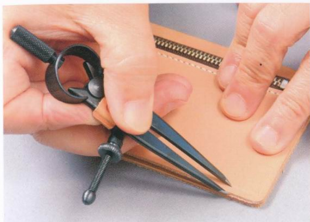
7 在零錢袋的皮革表層，以間距規拉出寬3mm的縫線溝槽。
