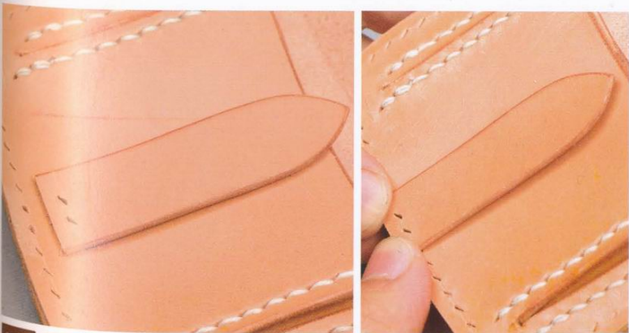
52 將開闔帶與帶身1、邊皮3一起縫合。先將黏合開闔帶的位置以研磨器磨粗，塗上橡皮黏膠後黏合。
