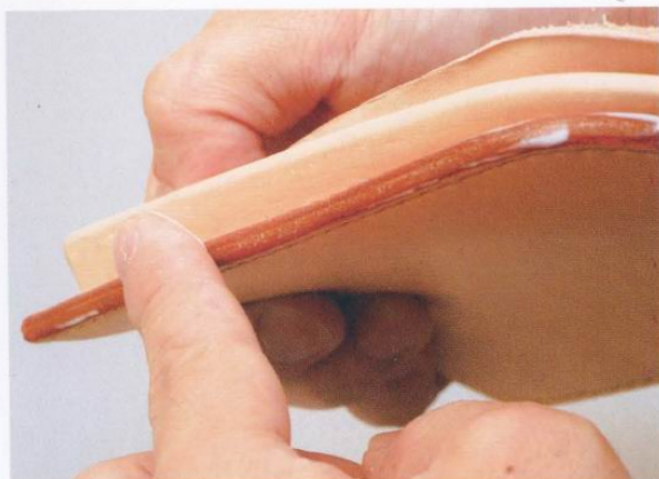
36 先在邊緣塗上染劑後，再塗上床面處理劑。
