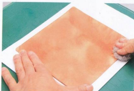
2 以畫圓的方式，將牛腳油均勻塗上。
