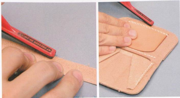
42 將邊皮3的兩側與袋身1的周圍，以研磨器磨粗，使得橡皮黏膠可以比較容易附著其上。
