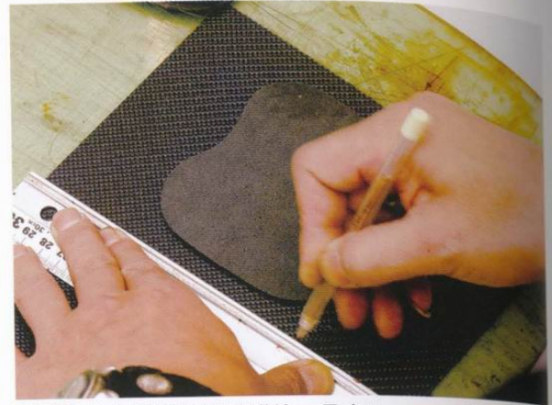
8 此處選擇的碳纖維片，是由Hasepuro公司所生產的。自由度大，使用方便。接著在碳纖維片上描出窗口的形狀。
