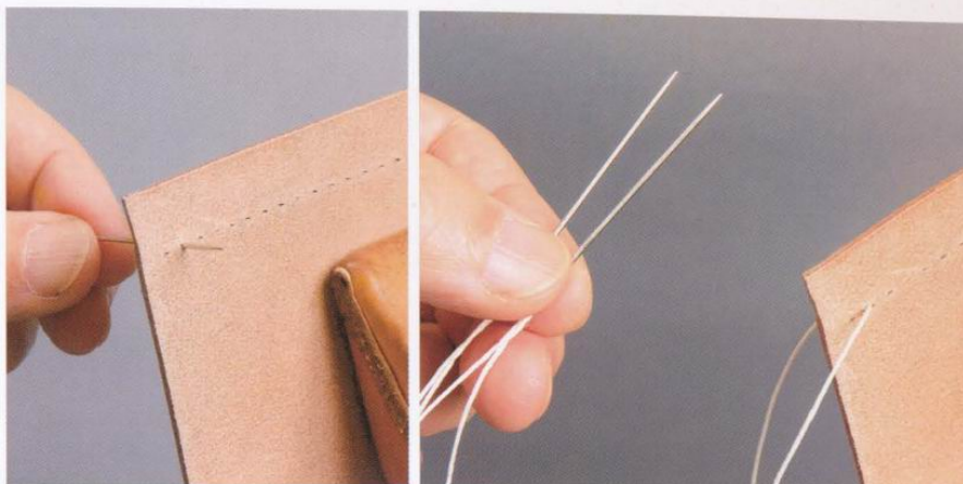
2 第一針由第二個縫線孔穿過，將縫線兩端的針往旁邊拉，以確定縫線兩端等長。
