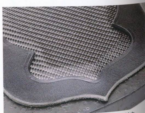
36 由於將拉溝器垂直握著，所以可以不削去皮革就在皮革上拉出溝槽。
