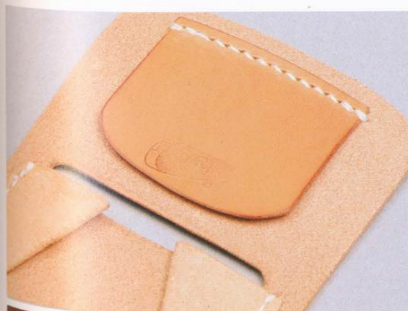
30 將邊皮1、2與袋身1縫合之後，接著縫上隔片。縫製的方式與縫製邊皮時的方式一樣。
