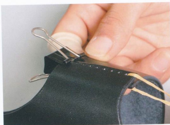
22 將托帶1與2縫合。以夾子將側邊夾住後，會比較容易縫合。
