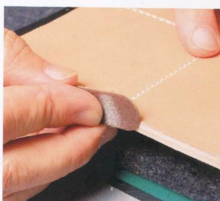
4 將黏合完畢的側面，以小型刨刀或磨砂棒磨平。使用小型刨刀削去皮革時，刨刀移動的方向如圖中箭頭所示。
