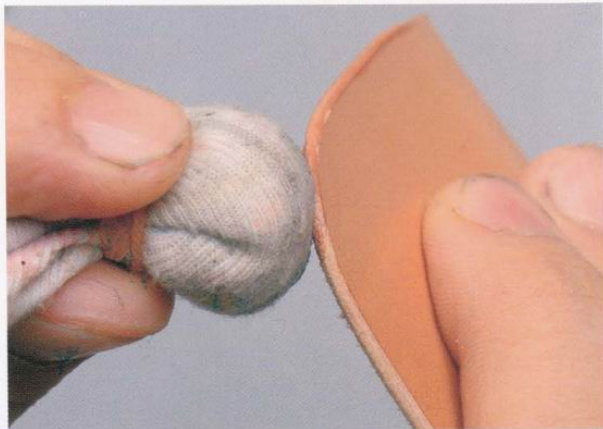
8 打磨好側邊之後，以棉布沾取海藻膠塗在側邊上。
