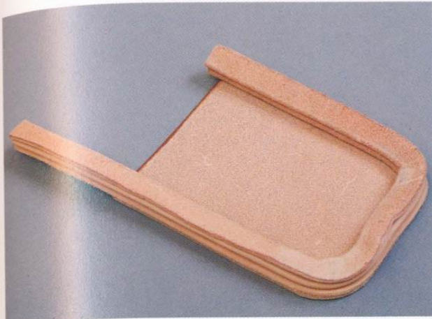
18 圖為將袋身2與邊皮黏合之後的狀態。因為使用的是快乾膠，所以很快又可以繼續進行下一個步驟。
