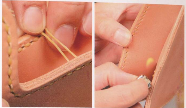
40 縫製到尾端後，一樣採用回針縫來加強尾端縫線強度，並以打火機燒灼後固定。
