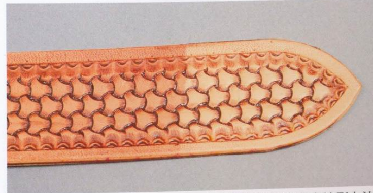
11 與右側相較，左側沒有先塗上皮革亮光乳液便直接刷上油性染劑。可以發現，右側的陰影部分比左側明顯的多。油性染劑在乾燥之前，可以用濕布擦掉。
