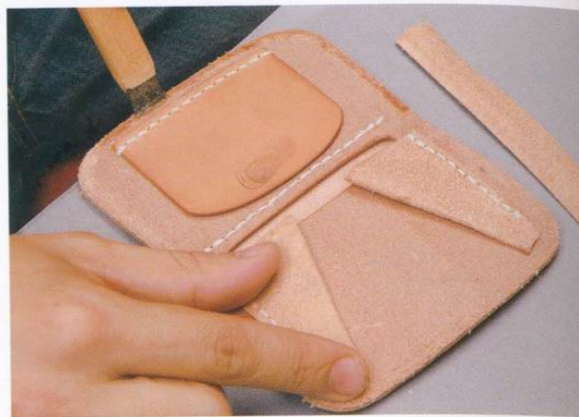
43 將橡皮黏膠塗在袋身1的名片夾層的四周，還有邊皮3的兩側上。
