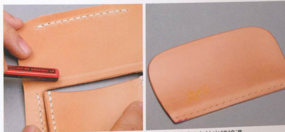
31 在零錢包的開口上方，以研磨器磨粗。接著在袋身2上拉出縫線溝槽並以菱斬鑿孔。此為零錢包的袋蓋部分。
