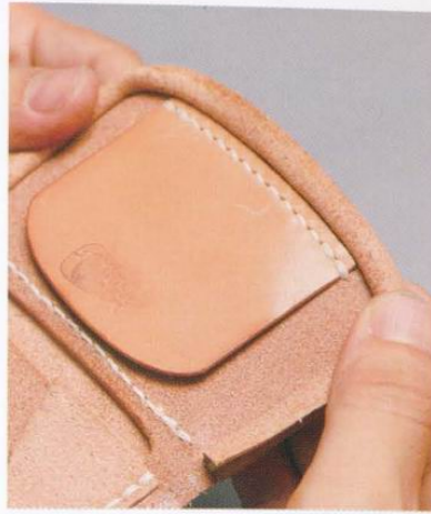
49 彎曲邊皮3直到呈現固定的弧度，再將邊皮3塗上橡皮黏膠後與袋身黏合。黏合時一定要對齊縫線孔。
