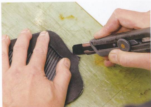
31 由於裡層袋身皮革比較大塊，以美工刀將突出邊緣的部份削掉。
