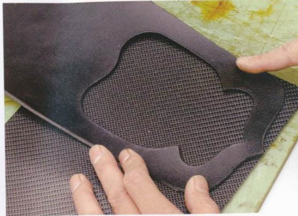
7 將碳纖維片與窗口的部份重疊，決定碳纖維片必須裁下的大小。
