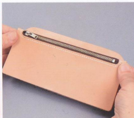
5 在零錢袋的周圍，薄薄地塗上一層約寬5mm的接著劑。接著再將零錢袋對折黏合。
