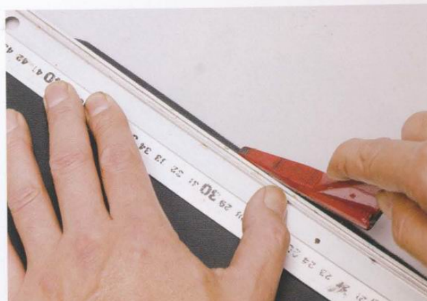
52 為了避免在磨粗表面時傷到其它部位，可以規尺與三角研磨器來磨粗表面。
