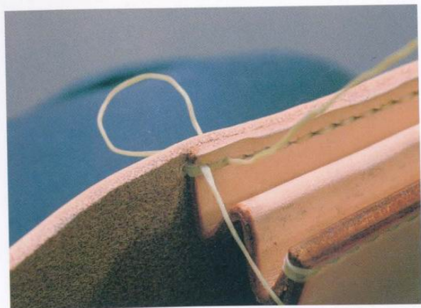
46 縫製結束時，一樣先進行2圈繞縫，再由外側進行1針回縫，使縫線回到皮革背面。
