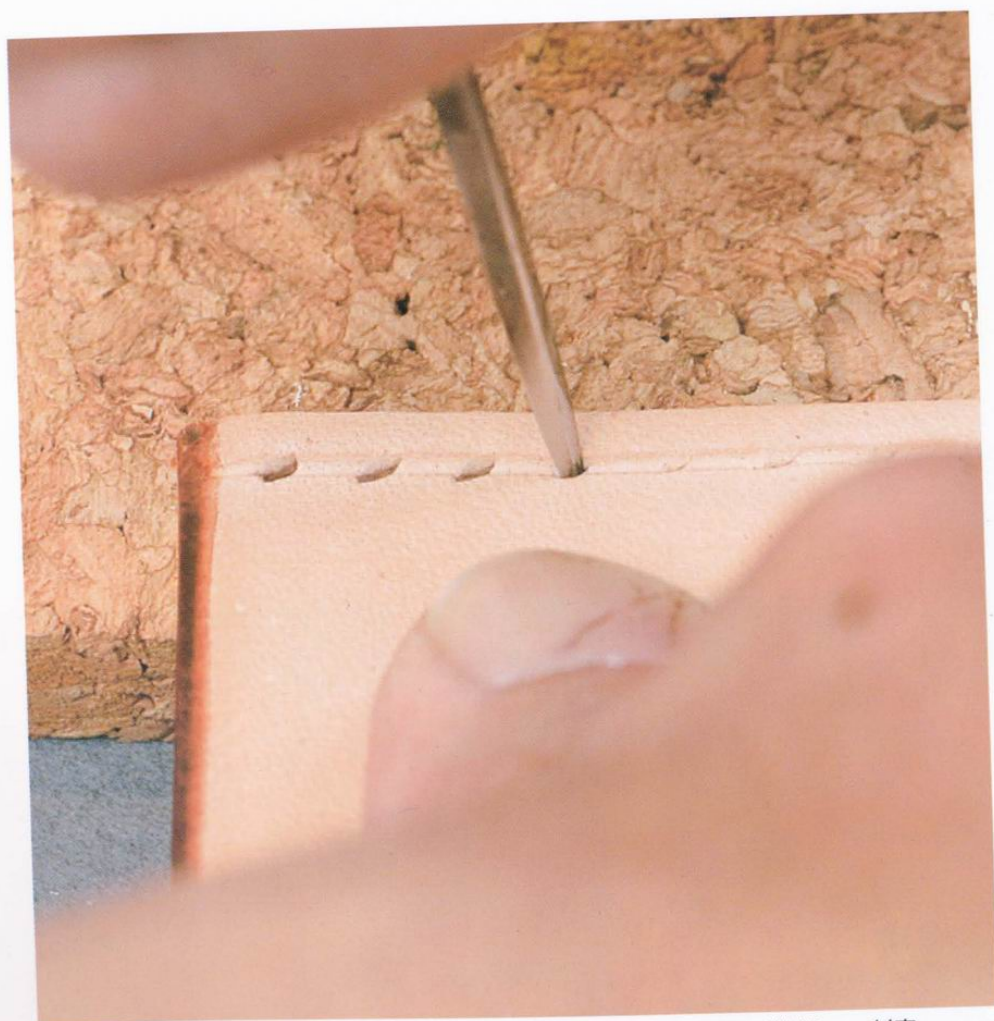
25 將邊皮拉開，在其中墊上隔板後，將之前菱斬鑿開一半的孔以菱錐一一刺穿。由於菱錐比零斬細，所以不會讓孔洞越開越大。
