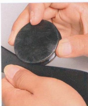
8 使用磨緣器打磨各片皮革的側邊。打磨時不要太過用力，只要能抑制側邊毛躁並讓乾燥的表面透出光澤感即可。
