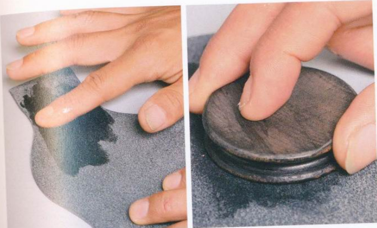
3 以水溶解CMC後，塗在托帶1與2和釦帶的皮革背面(床面)上，再使用上膠片或玻璃板來打磨。
