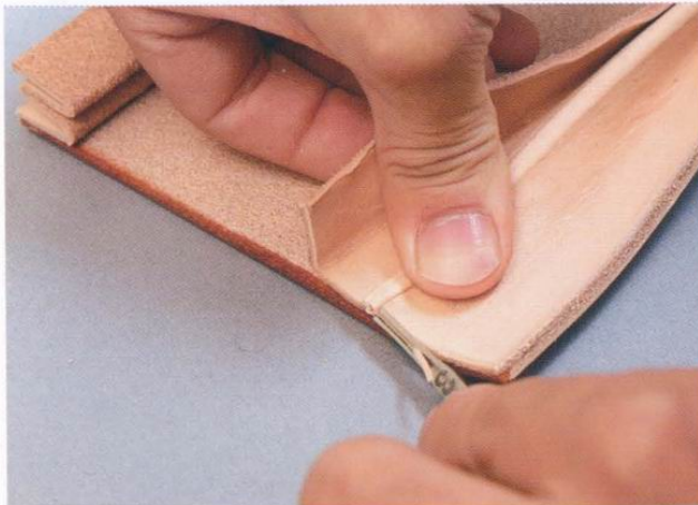
21 將邊皮拉開來，將上端的邊緣削掉。皮革表面與背面的邊緣，都要仔細地削下來。
