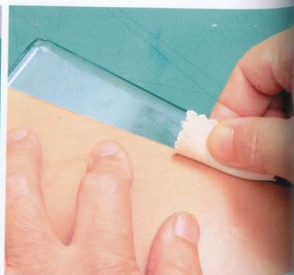
2 在床面處理劑完全乾燥之前，以磨緣器或棉布摩擦邊緣。如果用力不當，在摩擦的過程中有可能傷到皮革。唯有小心的打磨，才能突顯出皮革的光澤來。
