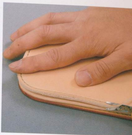
49 將與袋蓋縫合的部位與袋蓋本身的邊緣，以削邊器將邊緣削下。皮革正面與背面的邊緣都需要以削邊器處理。
