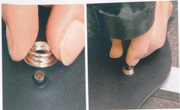
19 將牛仔釦的腳部由托帶1的皮革背面插入，接著由皮革表面裝上牛仔釦的凸釦，並以牛仔釦工具敲打固定。
