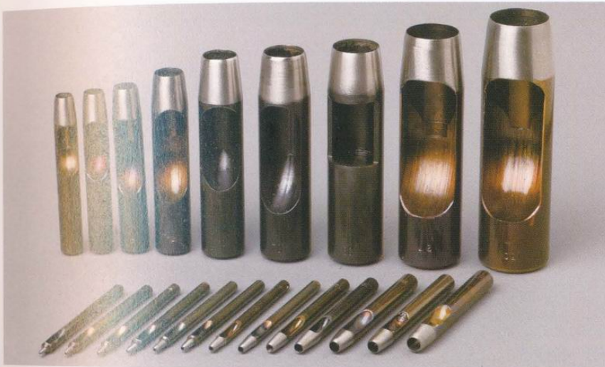
圓斬 從直徑0.6mm的2號圓斬到直徑30mm的100號圓斬為止，有許多不同的尺寸。可在裝置牛仔釦、固定釦、四合釦、銀釦等金屬零件時使用。
