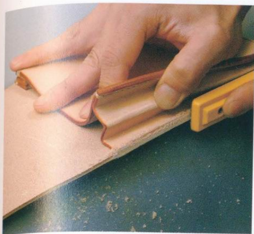
48 將縫合後的側邊以三角研磨器打磨。
