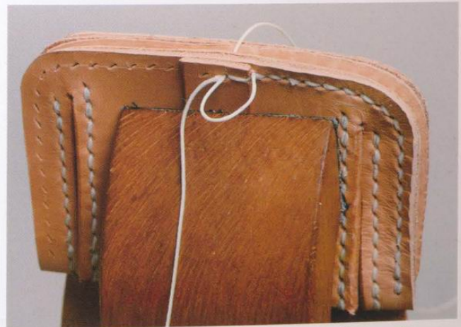
53 縫合邊皮與袋身。開始縫合開闔帶時，在同一個縫線孔重複縫製2次來增加強度。
