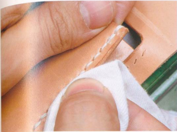
26 塗上海藻膠，趁海藻膠乾燥之前以乾的棉布打磨側邊。
