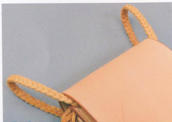
63 確定左、右兩邊露出的編織皮繩長度一致。如果長度不一的話，穿過皮帶後會產生傾斜的情形。
