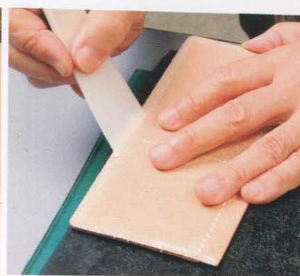
2 在袋身皮革、零錢袋與名片夾層等需要黏合的部位，薄薄地塗上一層寬約5mm的接著劑。
