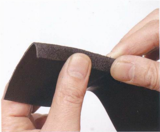
17 將皮革充分弄溼後，順著溝槽將邊皮折起。
