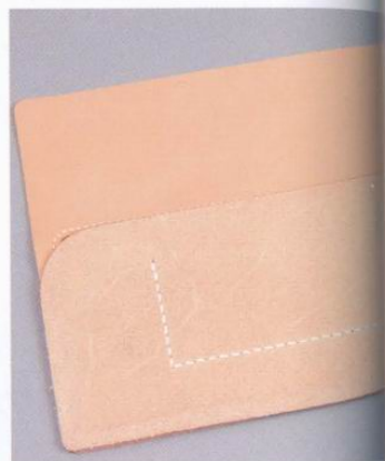
4 鑿好縫線孔之後，依照之前的說明將皮革縫合。
