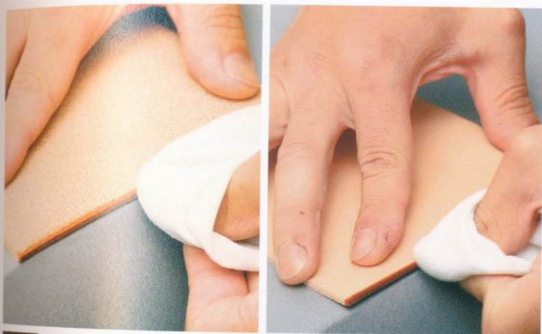
12 利用書桌等邊緣，如圖中一般，以棉布打磨塗上床面處理劑的部位。先打磨內側，再接著打磨外側。
