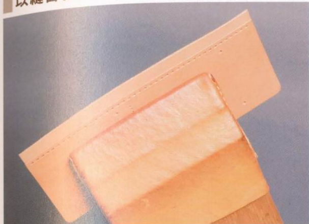
1 以手縫固定夾或大型手縫固定夾將皮革固定住。如果沒有類似的工具，也可以用膝蓋夾住皮革。
