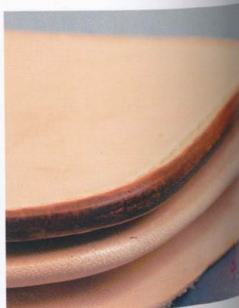
37 接著以木製磨緣器等工具打磨。需要打磨的位置包括內側、外側與側邊。經過充分的打磨之後，皮革邊緣便會出現光澤感。因為本作品的邊緣比較厚，如果使用三用磨緣器時，則必需將磨緣器橫著拿才能順利打磨。
