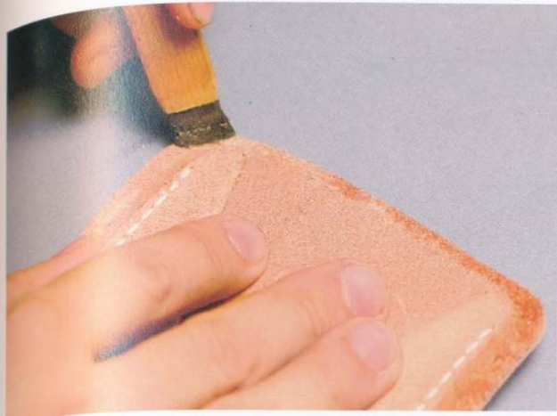
48 接著將袋身1上的零錢包那一側，塗上一層薄薄的橡皮黏膠。
