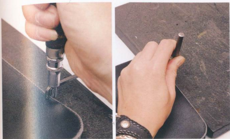
48 以拉溝器拉出縫線溝槽，並接著以菱斬鑿孔。鑿孔時要當心不要傷到邊皮。
