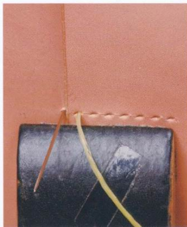
31 將名片夾層1與2縫合。開始時以1針回針縫起針，縫製完畢時也以回針縫來收尾。
