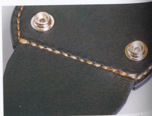
33 將袋身的下方與托帶1重疊之後縫合。起針與收尾，都需要以2針回縫來增加縫線的強度。
