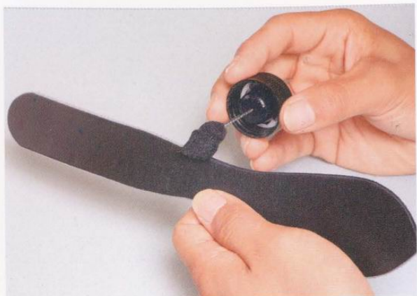
6 在進行過削邊作業的釦帶和托帶1與2的側邊，塗上黑色的染劑。
