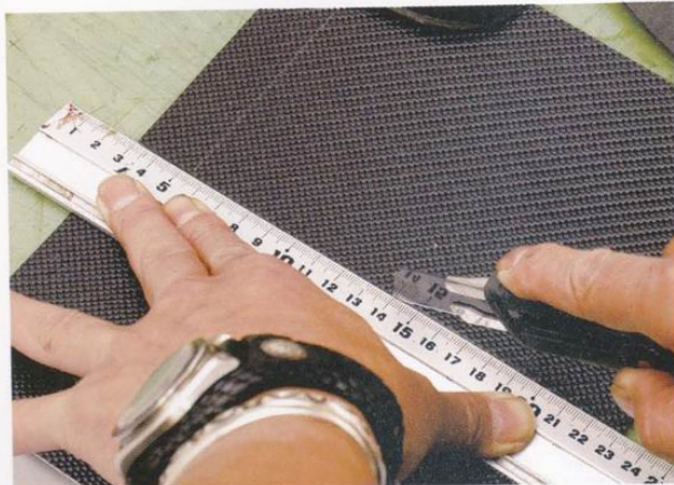
9 此處所選用的碳纖維片，可以用美工刀切割。將需要的大小切下。
