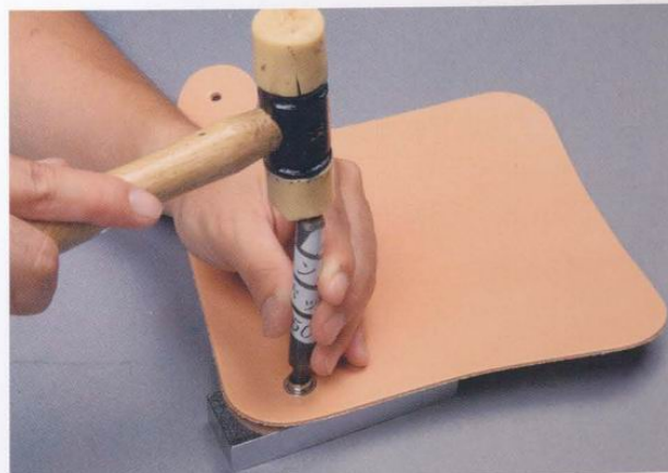
33 再將萬用環狀台墊在下方，並使用牛仔釦工具敲打以固定牛仔釦。
