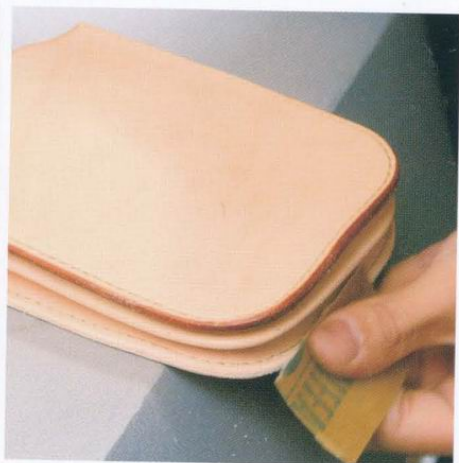
50 將削邊器處理過的邊緣，以240號的砂紙磨圓。彎角的部份必須呈現均勻的彎度。
