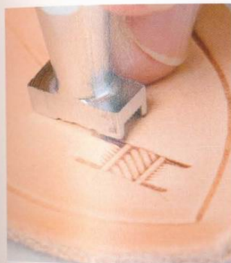
5 打印出一個圖樣之後，重疊1/3後繼續打印第二個圖樣。
