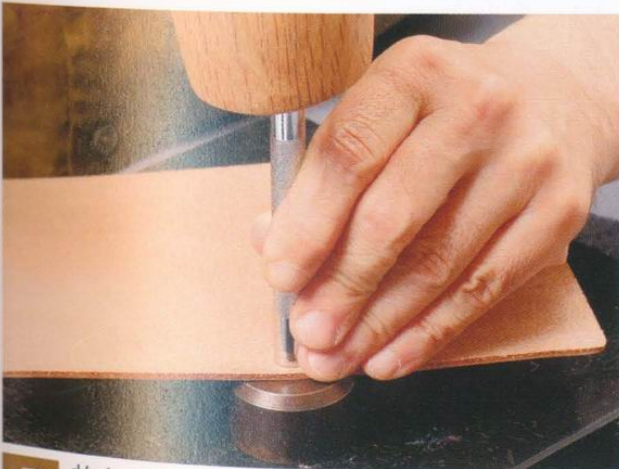
5 放上環釦工具，再以木槌將環釦的頭部敲彎。
