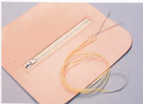
9 在拉鍊的四周鑿好縫線孔之後，接著便輪到準備皮革針與縫線了。縫線的長度，大約是縫合部位的3.5~4倍。
