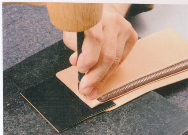
8 在零錢袋與皮革F的中間墊著一片薄薄的橡膠板，先以菱斬鑿出縫線孔後再縫合。
