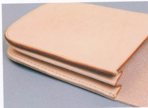
47 留下2mm長的線尾之後，將縫線切斷。再以打火機燒灼線尾後固定。
