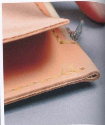
24 縫製到尾端時，再進行1針回針縫，將縫線統一由內側拉出。線尾留下2mm後剪斷，再以打火機燒一下以固定線尾。
