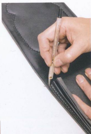
50 接著進行染色、打磨等工序。之前曾說明過，如果皮革上殘留著快乾膠，會使得皮革無法染色，所以如果有膠殘留在邊緣，需以削邊器將它削掉。
