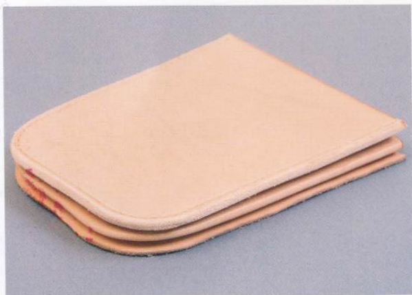
34 圖中為處理完邊角的狀態。彎角的部份，必須能呈現出順暢的彎曲線條。但是，如果以砂紙打磨時太過用力，很可能會磨到縫線針腳，不可不多留意。
