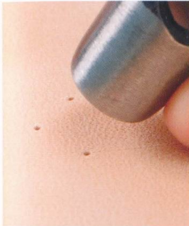
3 將圓斬的外圓對齊3個孔，以木槌敲打圓斬，以鑿開皮革。不要忘記在鑿孔前，要先墊上橡膠板。
