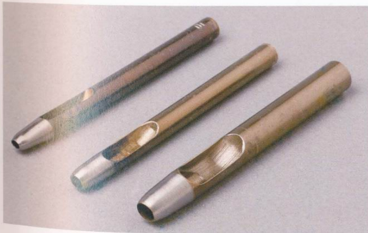
皮帶孔斬 (10號、12號、15號) 可以在皮帶上鑿出固定皮帶扣針的孔，屬於橢圓形的圓斬。
