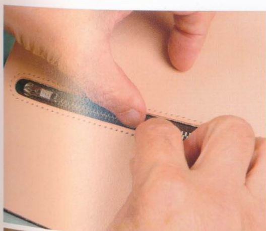
4 將皮革放在拉鍊的上方，對準中間部位以確定黏合的位置。
