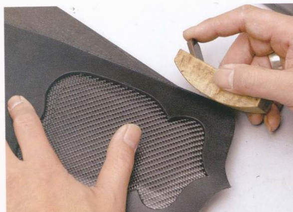
34 等到快乾膠乾燥後，開始打磨袋身四周的邊緣。裡層與表層的邊緣都要打磨。
