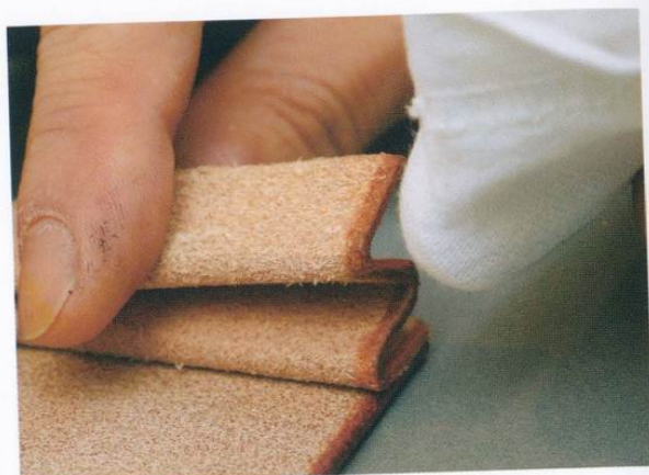
24 打磨皮革內側邊緣。即便是看不見的部位也要仔細打磨，可以讓成品的整體質感一起獲得提昇。
