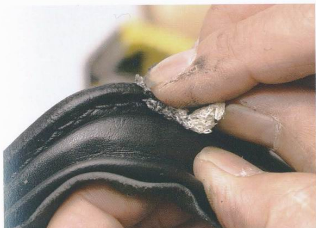
50 接著進行染色、打磨等工序。之前曾說明過，如果皮革上殘留著快乾膠，會使得皮革無法染色，所以如果有膠殘留在邊緣，需以削邊器將它削掉。
