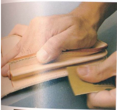
50 將削邊器處理過的邊緣，以240號的砂紙磨圓。彎角的部份必須呈現均勻的彎度。
