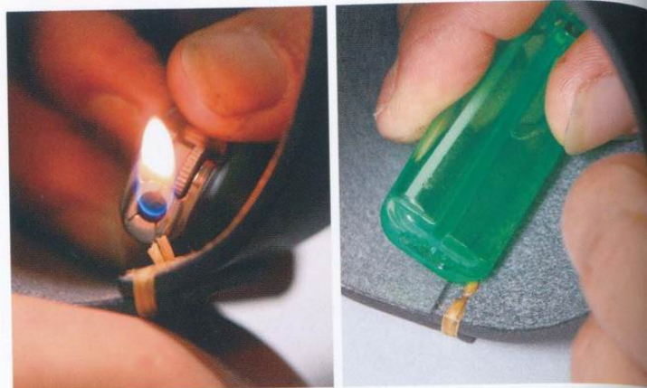
29 以打火機燒一下線尾，等縫線稍微溶解後，以打火機的側面將縫線壓緊固定。
