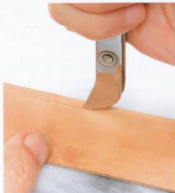
2 以邊線器拉出寬3mm的外框線。
