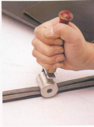
18 將皮革折好之後，以滾輪來回滾壓以固定皮革形狀。
