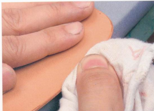
9 在海藻膠乾燥之前，以棉布摩擦至側邊出現光澤為止。
