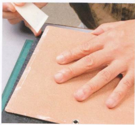
2 在袋身皮革、零錢袋與名片夾層等需要黏合的部位，薄薄地塗上一層寬約5mm的接著劑。
