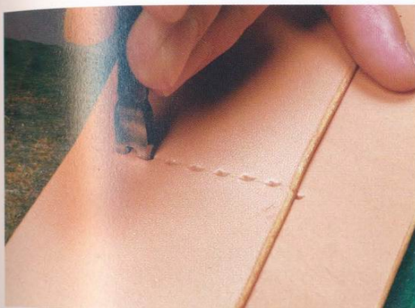
30 在名片夾1與2的高低差處，如圖一般，先以菱斬在低處鑿出一個縫線孔後再繼續鑿孔。
