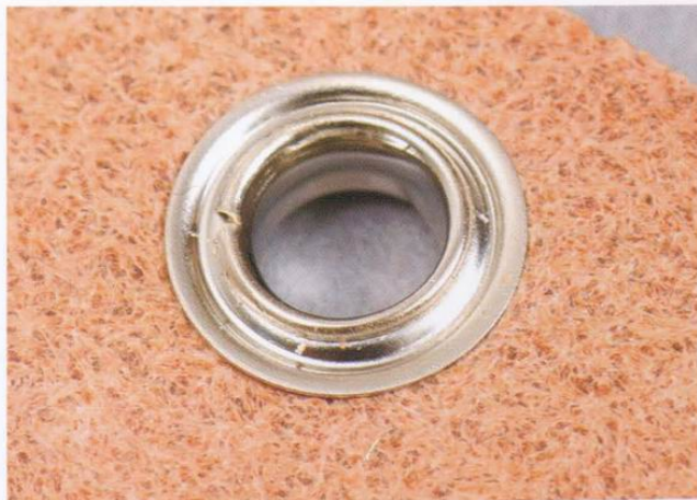
6 被敲彎的環釦頭部便會將座金固定住。如果敲打的太大力，有可能使環釦變形，這一點需多注意。
