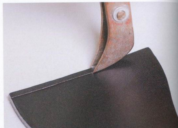
9 使用邊線器在托帶1與2和袋身上，拉出寬3mm的縫線溝槽。
