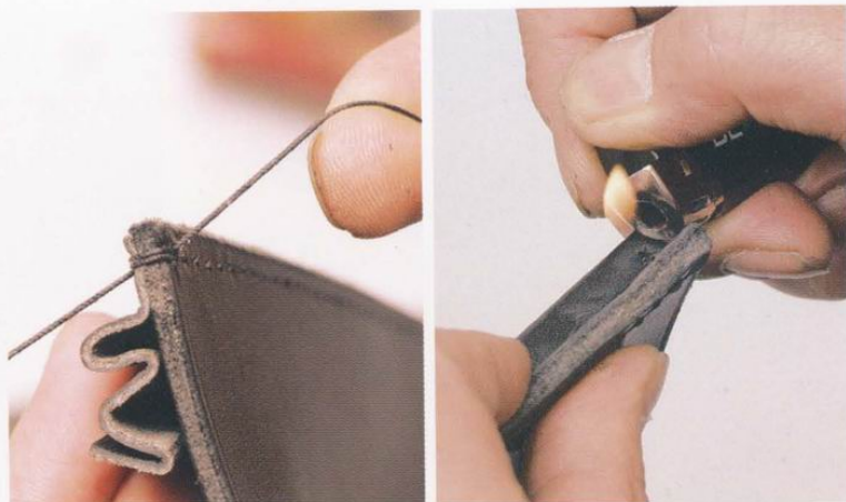
49 縫合時，在起針與收尾的部位都向外繞縫2圈，以加強皮革縫合的強度。縫合完畢後，以打火機燒灼線尾以固定縫線。
