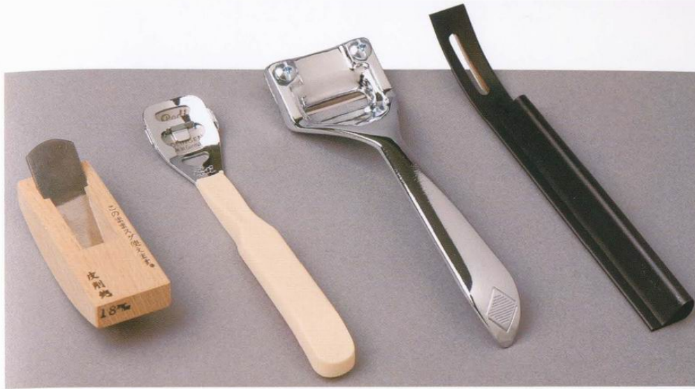
小型刨刀／德式削薄刀／ 美式削薄刀／美式安全削薄器
