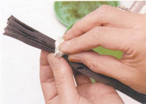
20 為了加強折線部位的強度，塗上CMC後打磨。但是左、右兩邊與袋身的黏合面不可打磨。
