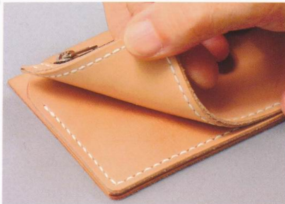
14 接著縫合紙鈔夾層。由於紙鈔夾層位在其它皮革中間，縫製上會覺得比較礙手礙腳，縫製時要多點細心與耐心。
