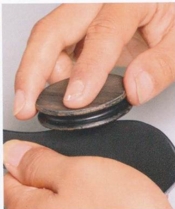
8 使用磨緣器打磨各片皮革的側邊。打磨時不要太過用力，只要能抑制側邊毛躁並讓乾燥的表面透出光澤感即可。
