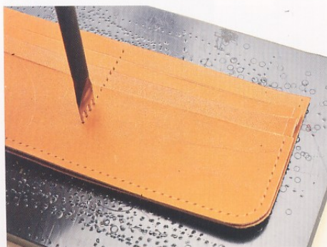
24 沿著在步驟21和22中所劃的引導線，在距離上方5mm處至距離下方27mm處之間，以四菱斬鑿出菱形縫線孔。
