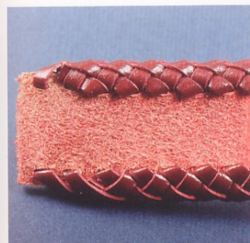
21 也在起縫處的剩餘皮線上塗上接著劑，固定後剪斷。
