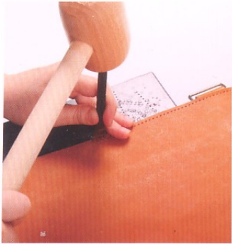
45 從②~④的起點開始與另一邊，在下方的線條也同樣鑿出菱形縫線孔。在此必須讓縫線孔數完全一致。
