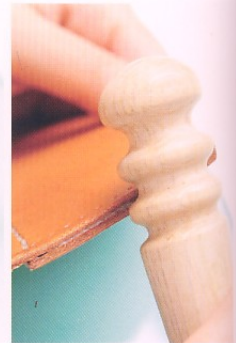
56 接下來是處理在照片 56 所標示的紅線部分，打磨邊緣。以削邊器削除邊角，沾些許清水後，塗抹上背面處理劑，以木製修邊器仔細打磨。
