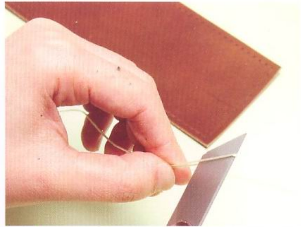
17 雖然也可使用剪刀將線剪斷，但若是以美工刀割斷蠟線，線容易滑動，需特別小心。
