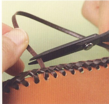
56 將縫製好的皮線調整成一致後，約留10mm的長度，以剪刀剪斷皮線。
