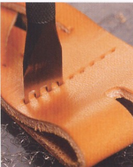
24 折疊皮革，以錐子鑿孔。不需完全鑿穿，從下方皮革的毛面鑿孔，會更美觀。
