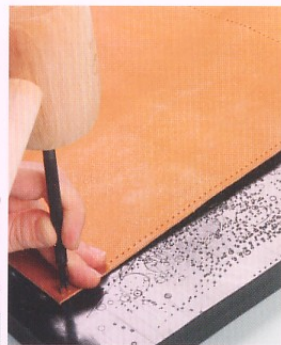
49 以四菱斬在照片 III 中所標示的線條⑤上鑿縫線孔。此處的縫線孔間距為一致，這也是在設計時就事先設定好的。
