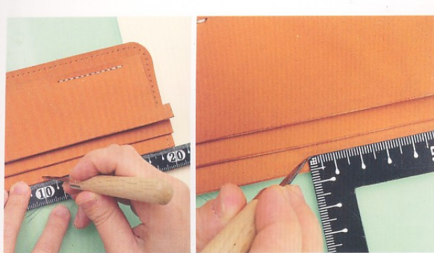
20 首先在剛好一半的100mm的位置上輕輕做出記號，在寬100mm的位置和距離邊緣5mm的位置上確實的做出記號。
