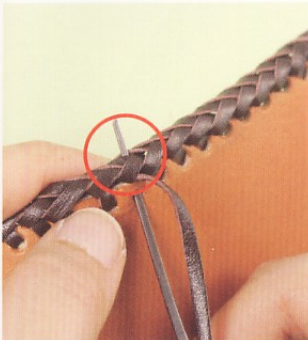
55 將針穿過最後的孔，如照片般穿過另一邊的皮線之間。
