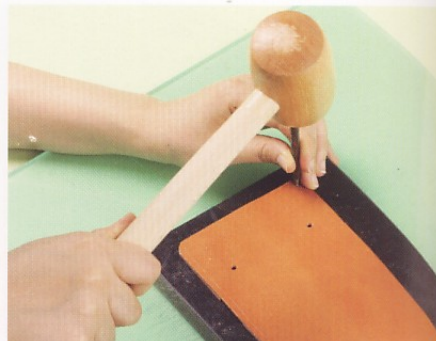
13 以木槌敲打三圓斬，鑿出縫製皮線的孔。沿著確認過的位置，鑿孔。
