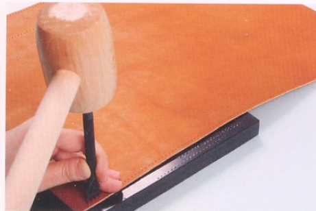
52 以中央位置為起點，開始在照片 41 的線條 ⑨ 和 ⑩ 上鑿縫線孔。因為只有一片皮革，所以鑿孔的作業進行起來應該會相當順利。
