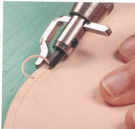
5 換上刀刃的拉溝器，即可如照片般，在皮革上鑿出縫線溝槽。
