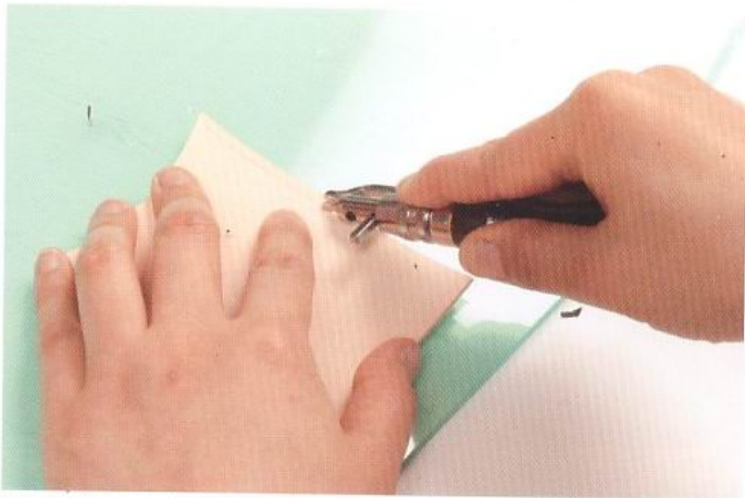
3 將劃引導線的尖頭對準記號，抵住皮革邊緣往身體方向拉動，在皮革上劃出引導線。
