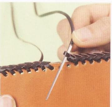
49 待剩下2個縫線孔後，將針穿過剛才解開皮線所形成的圈圈。
