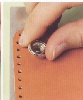
16 裝上牛仔釦。確認各零件的正反面，以手指暫時壓合。
