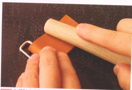
5 為了防止皮革脫落，建議在橡膠板上以木製修邊器來回用力壓合。
