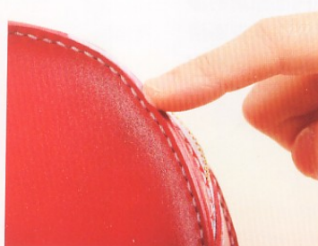
22 待染料乾燥後，以手指沾取適量的背面處理劑，塗抹於邊緣。
