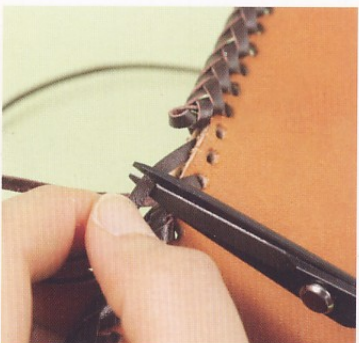
46 用剪刀剪斷多餘的皮線尾端，約留30mm長。
