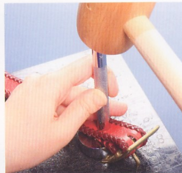
22 最後以固定釦固定皮帶頭。固定方法請參照P120的 3 ~ 6 。
