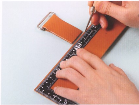
35 在距離袋身貼邊背面皮革的兩端130mm的位置上，以錐子做出記號。此處為日後接縫金屬環固定皮革的記號。
