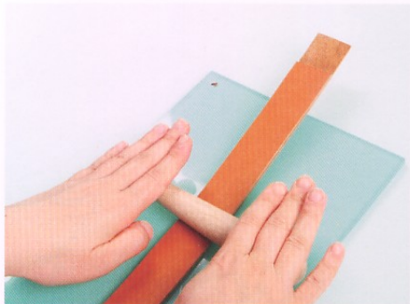
25 為了製作出提把皮革朝外側的弧度，以木製修邊器在提把的背面上來回滾動，使皮革緊密黏合。
