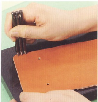
12 將三圓斬放在引導線的上方，確認鑿孔的位置。 需使轉角處的縫線孔位置一致。
