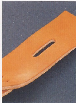
20 將皮帶斬對準引導線，確認呈垂直狀態後，以木槌敲打鑿孔。
