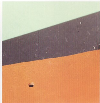
12 將三圓斬放在引導線的上方，確認鑿孔的位置。 需使轉角處的縫線孔位置一致。
