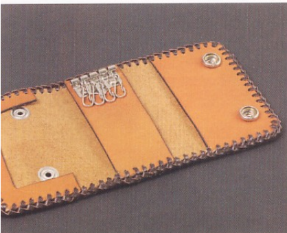
58 待固定皮線的接著劑完全乾燥後，即大功告成。藉由使用縫製皮線，製作出與手縫不同風味的作品。此外，因可在市面上購得色彩繽紛的皮線，所以大家可自行搭配皮革，享受配色的樂趣並營造出獨具個人風格的組合。
