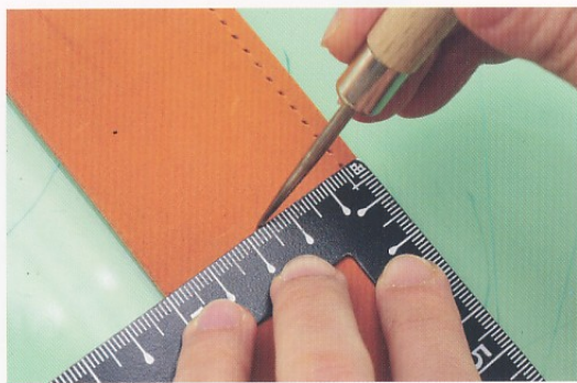
22 在卡片夾層4的寬100mm處和距離下方27mm的交接點上，以錐子做出記號。
