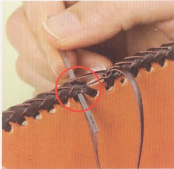
52 將針穿過照片中以○框起的部分，三條皮線的下方。
