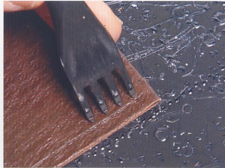
13 在四菱斬刀峰前方的小圓點就是錐子壓出的記號。以此記號為準，在引導線上鑿出縫線孔。
