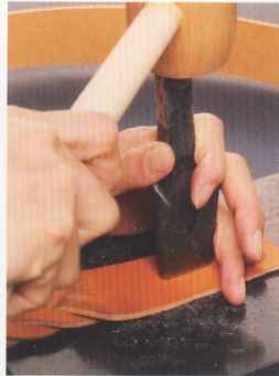
20 將皮帶斬對準引導線，確認呈垂直狀態後，以木槌敲打鑿孔。
