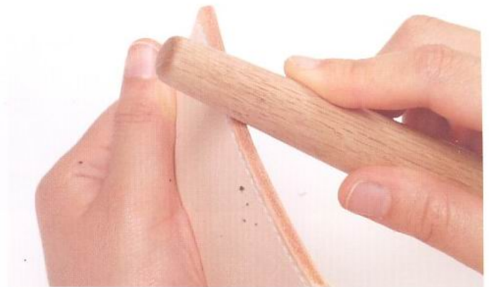
6 用木製修邊器在邊緣上下滑動，打磨邊緣，磨至邊緣出現光澤。
