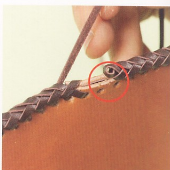
48 將在 48 中暫時停止作業的皮線，穿入已解開皮線的起縫的孔中。
