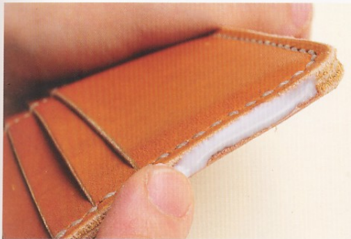
38 在邊緣上塗上清水後，接著塗抹上一層薄薄的背面處理劑，此時需注意勿讓背面處理劑沾到皮面。
