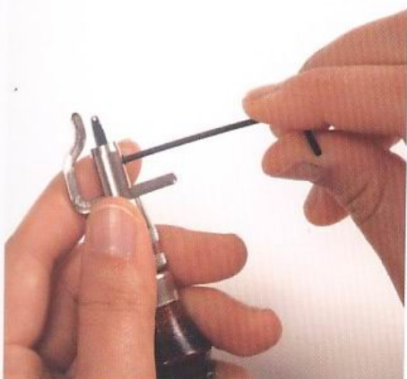
4 以六角扳手將原本在本體上的螺絲拴緊，固定刀刃。
