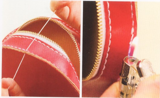
19 縫好後，往回縫2針，剪斷多餘的線。線尾以打火機輕燒，融化固定。
