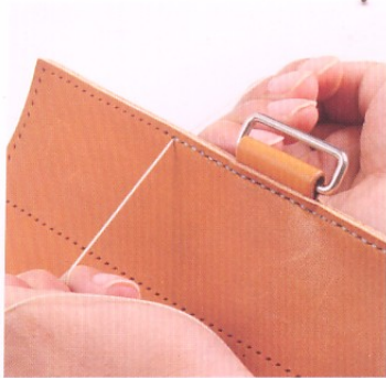
55 縫合①~④的部分。因為皮革厚度較厚，在縫合時可使用鉗子輔助。
