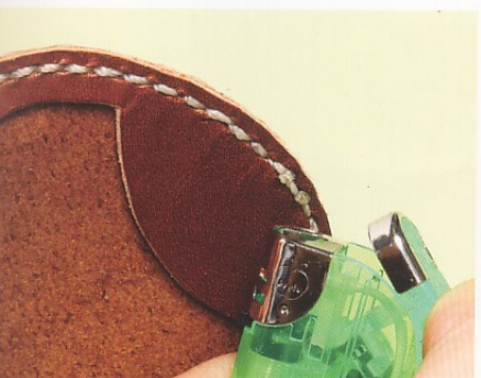
19 縫至終點後，為了避免綻線，需往回縫2針。縫好後剪斷線，以打火機輕燒線尾，使其融化固定。
