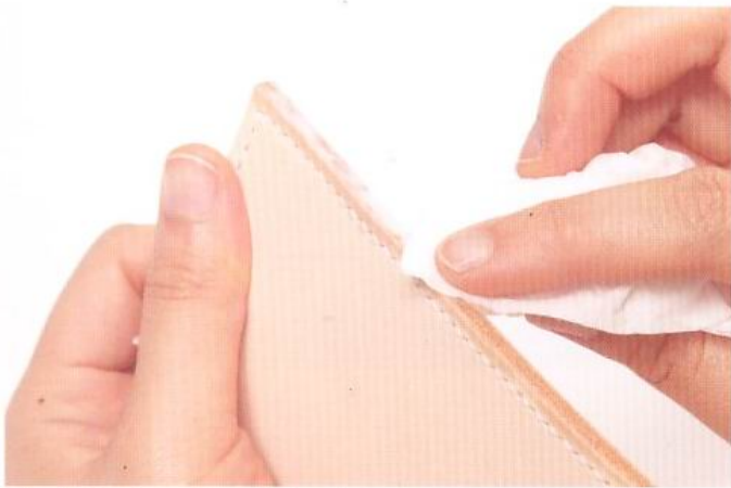
5 靜置約5分鐘，待背面處理劑呈半乾的狀態後，以面紙擦拭掉多餘的背面處理劑。
