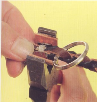
20 用老虎鉗將金屬套環夾緊。為了避免傷及套環，建議在中間夾入一小片皮革，再施力夾合。
