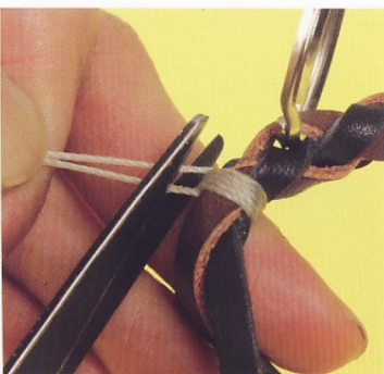
17 用剪刀剪斷多餘的線，留約5mm長。以打火機輕燒，使其融化固定。
