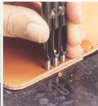
14 在兩片皮革重疊的部分，需特別用力敲打。圓斬必須對準引導線的中心。
