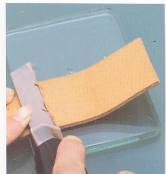
17 在要裝上皮帶頭的部分，以美工刀或裁皮刀削薄（約 0.5 mm）。
