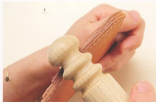
39 以木製修邊器仔細打磨。像是長夾般相當具有存在感的作品，若沒有仔細打磨邊緣，粗糙的邊緣會更加明顯。
