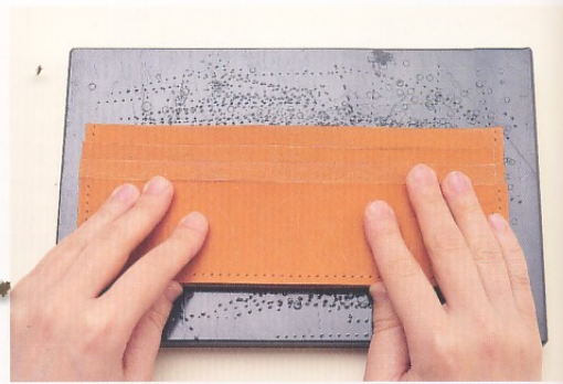
23 將卡片夾層4的皮革與卡片夾層1、2、3確實地對齊重疊。移至卡片夾層3的下方10mm處，底邊則與卡片夾層1對齊。
