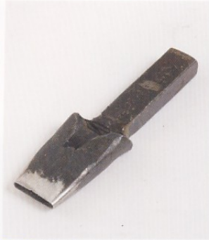
19 鑿細長形洞孔時，使用稱為皮帶斬的專用工具。
