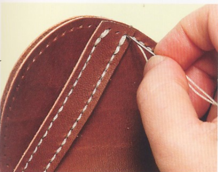
17 縫至本體的寬度最寬的位置時，放上固定皮帶，和本體一起縫合。
