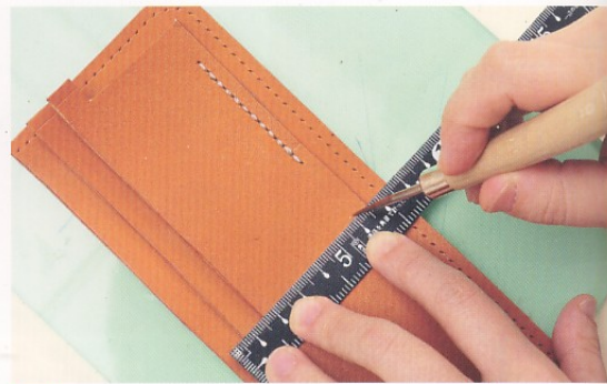
21 另一邊也在100mm處做出記號，連接在步驟20中所做的記號，以錐子劃出引導線。
