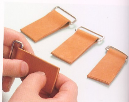
4 對齊角度，摺成一半，用力壓緊黏合。以相同方式做出4個。
