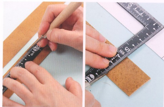
22 在提把和背面皮革的中央位置，以錐子做出記號，接著在距離提把的左右兩端35mm處，個別劃出一條水平線。
