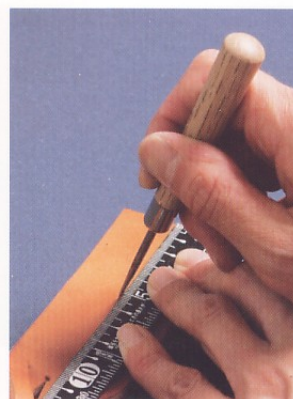
18 一開始保留的 100mm 處就是安裝皮帶頭的部分。在距離邊緣 50mm 的位置，以錐子做出記號，在中間劃出即將穿過皮帶針的細長形洞孔的引導線。
