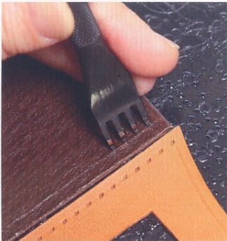
14 將隔層用皮革同樣平行放在皮革1或2的旁邊，目視確認位置後，開始鑿縫線孔。
