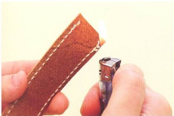
20 以打火機輕輕燒過剩下的線尾，待線融化後立刻熄火，進行此作業時需注意勿燒及皮革。
