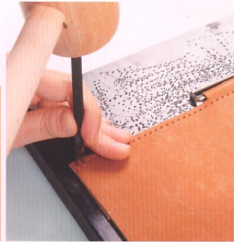
45 從②~④的起點開始與另一邊，在下方的線條也同樣鑿出菱形縫線孔。在此必須讓縫線孔數完全一致。
