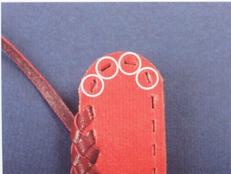
15 縫至轉角處。照片中以4個○標示的縫線孔，為了將邊緣隱藏起來，和直線的縫製方法有些許不同。
