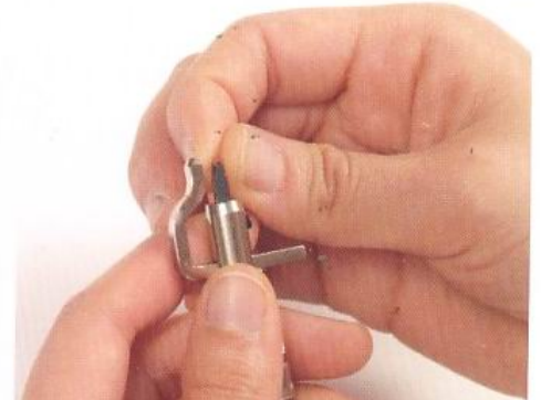
3 安裝上刀刃。注意刀刃上的小洞方向。
