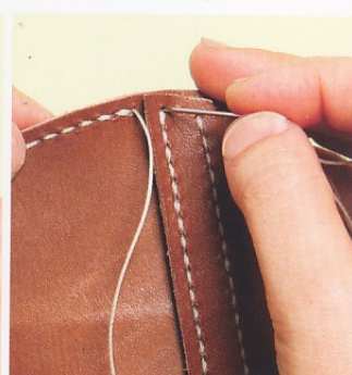
18 以相同的方式縫合另一邊。特別注意勿使固定皮帶歪斜，留意左右兩邊的菱形縫線孔位置，使固定皮帶呈平行狀態縫合。
