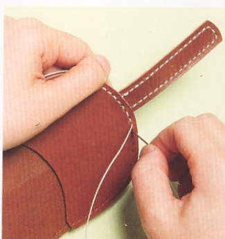
18 以相同的方式縫合另一邊。特別注意勿使固定皮帶歪斜，留意左右兩邊的菱形縫線孔位置，使固定皮帶呈平行狀態縫合。
