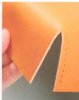
50 照片 III 中的⑥就如同左側照片般，為了和線條⑤的折角部分縫合，從起點開始的縫線孔數必須一致。
