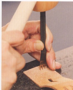
24 折疊皮革，以錐子鑿孔。不需完全鑿穿，從下方皮革的毛面鑿孔，會更美觀。
