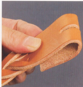
22 為了防止折疊部分鼓起，以木槌輕敲此處，使其固定。敲打時，將小片皮革放在上方，以避免造成損傷。
