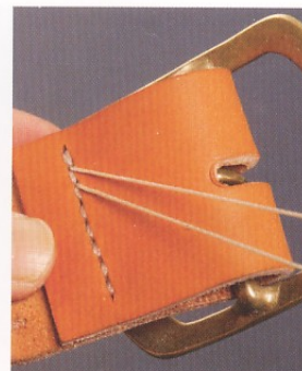
25 裝上皮帶頭，縫合。縫好後再往回縫2針。最後以打火機輕燒，使線尾融化固定。
