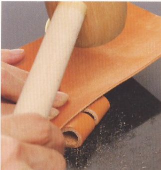
22 為了防止折疊部分鼓起，以木槌輕敲此處，使其固定。敲打時，將小片皮革放在上方，以避免造成損傷。
