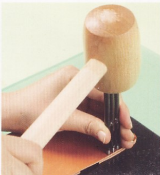
14 在兩片皮革重疊的部分，需特別用力敲打。圓斬必須對準引導線的中心。
