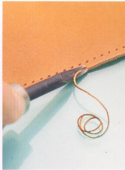
56 接下來是處理在照片 56 所標示的紅線部分，打磨邊緣。以削邊器削除邊角，沾些許清水後，塗抹上背面處理劑，以木製修邊器仔細打磨。
