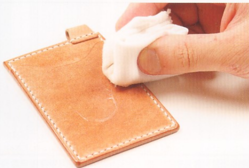
1 用乾燥的布沾取適量的皮革保養乳，塗抹在皮革表面。因為不會留下顏色，所以可使用於皮件全體。
