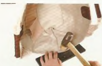
10 因為貼合部份變得相當厚， 所以在縫合前先用槌子敲打 緊實，盡量減少厚度。
