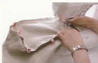
16 以7mm寬縫合底布一圍。與06相同，最後多縫3針，並進行回縫。
