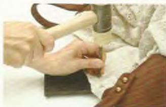
13 連結式包側的兩側鑿開安裝四合釦用的圓孔，共4個。
