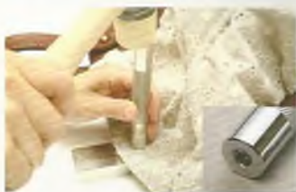
17 以塑膠錘敲打公釦用衝錘器來固定公釦。分成數次敲打為佳。
