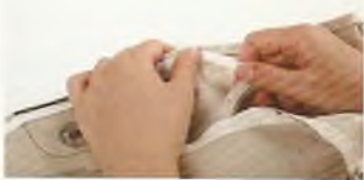
08 在內袋（或表袋）的折線處 3mm內側，貼上8mm寬的雙面 膠帶。
