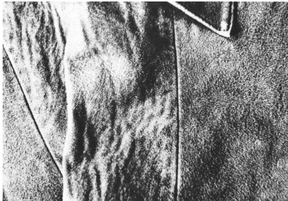
Рис. 14. На одной из панелей кожи была слабая связь между зерном и кориумом, что привело к рыхлости этой панели после химической чистки.
