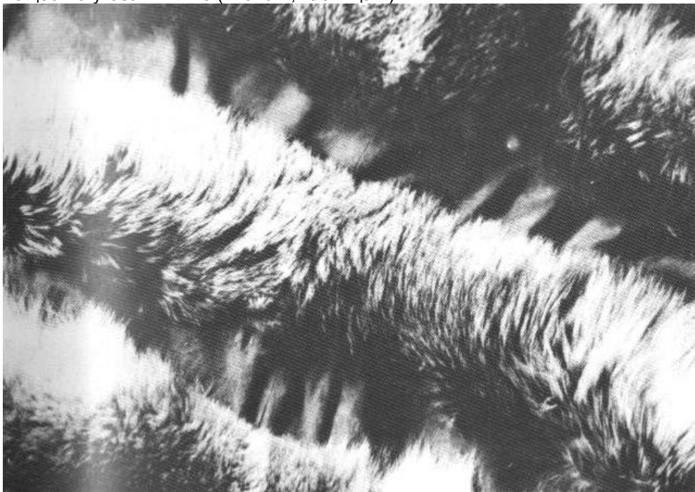
Рис.21. Мех сжался при сухой чистке и сморщил кожу.
