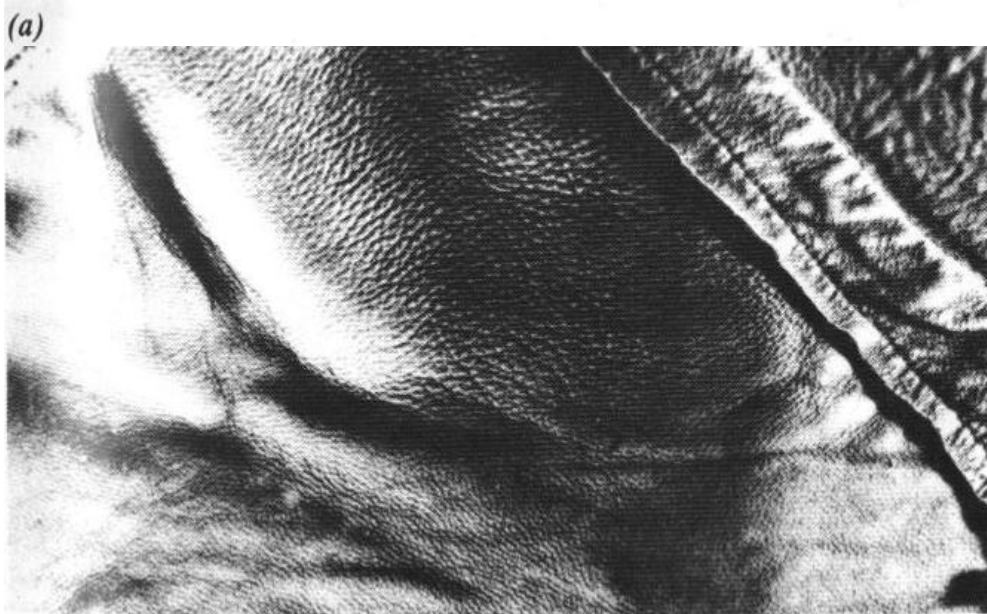
Рис. 14. На одной из панелей кожи была слабая связь между зерном и кориумом, что привело к рыхлости этой панели после химической чистки.
