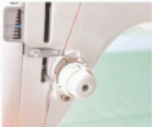
**07** 再次將車線往下拉，並將車線纏在呈鉤型像手臂型狀的穿線導引。
