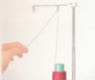
**03** 將車線從線輪柱抽出來，然後將車線穿過穿線導引尖端的環。
