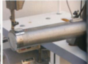
照片中的是許多專家堅持沒有這台縫紉機就無法進行縫製工作，被業界稱為17種的工業用縫紉機。SEIKO製的TE-5已經成為現行品上一代的機種，但是獨特的手轉大釜所產生的超群束線功能，可以在縫製厚物時發揮強大的威力。
