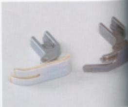
**01** 在這裡要使用鐵氟龍製的壓布腳，與可以沿著高低差來進行縫製的鉤子壓布腳。另外為了要讓鉤子壓布腳比較好滑動，所以要在鉤子壓布腳上貼上鐵氟龍膠帶。
