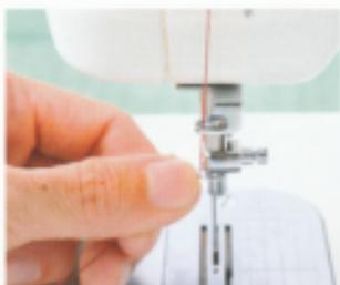
**10** 再次將車線穿過08所穿過的穿線導引，然後將車線穿過針軸前方的穿線導引。
