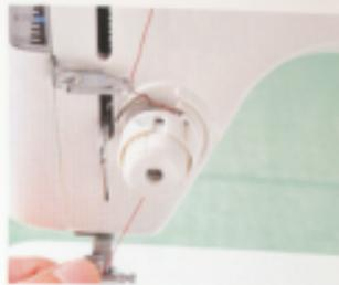
**05** 穿過穿線導引之後將車線往下拉，並將車線纏上上線張力調節鈕。
