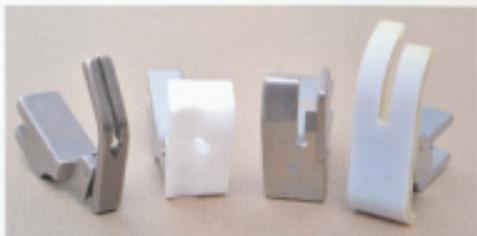
照片右邊開始是鐵氣龍製的自由壓布腳，使用在沿著高低差縫製的鉤子壓布腳，使用在縫製高低差部分的段差壓布腳，以及拉鍊用壓布腳。金屬製的壓布腳如果貼上鐵氣龍膠帶的話，就會變得格外容易滑動。
