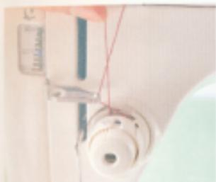
**06** 將車線纏上上線張力調節鈕之後，再將車線回轉180度，然後將車線穿過從上線張力調節鈕伸出來之鋼絲再穿線導引。
