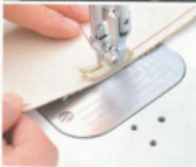
印象中直線縫製基本上是依賴縫紉機來進行縫製工作，但是布料卻不一定會筆直地前進。如果有歪曲的話，可以用右手來稍微調整方向。感覺上好像車子往筆直的方向前進時是一樣的，有時候需要稍微的修正。針板上通常會有導引線，所以請以針板上的導引線為基準來確認有沒有歪曲。
