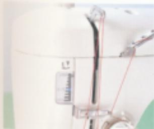
**09** 挑線桿要設定在最頂端的狀態下再來進行工作。將車線穿過挑線桿孔之後，就這樣往下拉。
