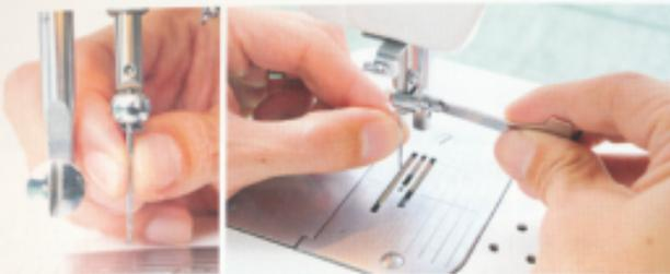
一邊注意車針的方向一邊將車針插入，然後壓住車針，並使用附屬工具確實地將螺絲拉緊來固定車針。如果螺絲拉得不够緊，車針就會脫落。
