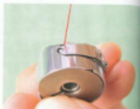
**02** 將車線穿過梭殼側面的穿線口，往彈簧拉片送去並拉出10cm左右的車線。
