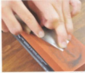
**02** 將刀頭尖端傾斜的部分調整為緊貼著磨刀石表面的角度，並將手指貼著刀頭尖端部分，將皮革裁刀往前後移動來進行研磨工作。如果這個角度弄錯的話，皮革裁刀的鋒利度就會大幅下降，所以請小心注意。
