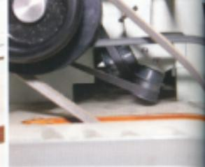
皮革削薄機與縫紉機一般是使用同機種的馬達，而馬達的迴轉力則是透過皮帶來傳送。NP202與NP-2的不同之處，是在於承接皮帶的飛輪。NP-2的結構是由前置的輪來支撐（中間照片），右邊照片中央的皮帶在要替換時，會比NP-202來得費力。
