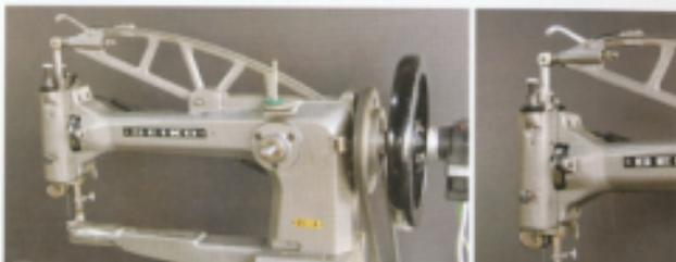
照片中的八方縫紉機並沒有送布齒，所以需要用手推動布料。但是它的優點是可以進行各種方向的縫製工作。壓布腳與車針的部分也設計成可以360度旋轉。
