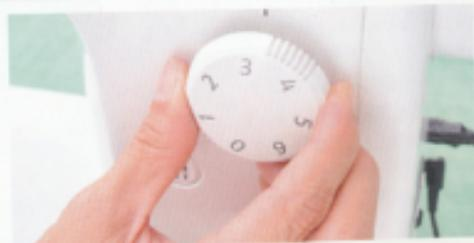
除了一部分的縫紉機之外，針目的長度也可以利用調節器來調整。這需要配合皮料或縫製位置來調整。一般來說，薄皮料要設定成短針目，厚皮料則是要設定成長針目。
