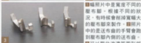
■照片中是寬度不同的壓布腳。根據不同的狀況，有時候會削掉寬幅大的壓布腳來製作。■照片中的是送布齒的手臂會跑到壓布腳內側的送布齒。■可以壓住滾邊等圓形部分的送布齒。
