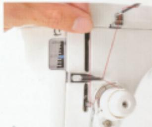
**08** 將車線就這樣往上拉穿過環狀的穿線導引，再往挑線桿方向拉。
