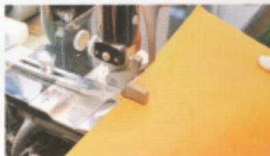
設定削薄機厚度，將四個邊依照左邊解說的數據來進行削薄工作。沒有削薄機的話，也可以用手動來進行削薄工作。
