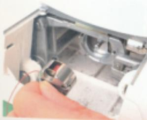
**04** 打開側蓋，一邊拉出線頭一邊將梭殼安裝在縫紉機上。在進行這個工作時，為了防止事故發生，請先將縫紉機的電源關掉。
