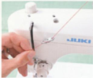
**04** 將車線穿過照片位置上的穿線導引。這個機種的話要像照片一樣地穿過車線。
