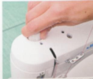
**03** 因為有壓布腳壓力調整扭，所以如果推動困難的話，可以先調整壓布腳的力道。
