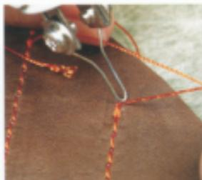
**07** 車線的處理工作如果是使用照片中的電子筆的話就簡單多了。只要打開電源，就會馬上加熱。如果是可以烤熔固定的塑膠線或尼龍線的話，只要一灑拉線一邊將電子筆壓貼上車線，就可以從根部剪下車線了。
