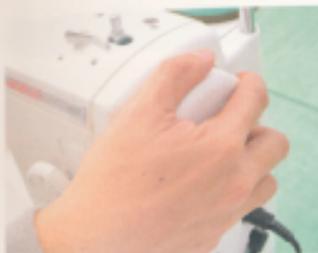
**05** 為了要讓大蓋可以勾取車線，需要一邊拿著車線的尖端，一邊轉動手輪讓車針穿過針板的孔，再次將車針升起並操作到車線可以從針板孔出來為止。
