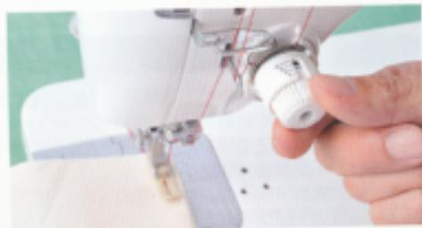
車線張力狀態可以像照片這樣，旋轉張力調整扭來調整上線的張力，以調整出適當的車線張力狀態。
