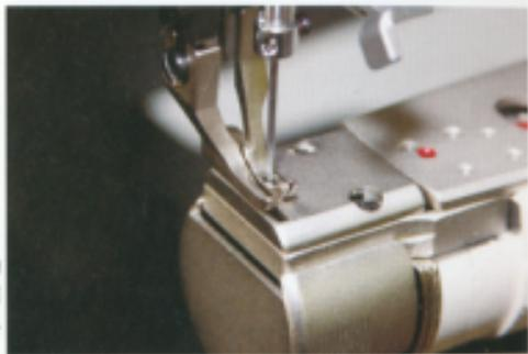
照片右邊的是中壓腳，左邊的則是負責在上方推動的外壓腳。壓腳與壓布腳相同，可以配合縫製物品來做替換。
