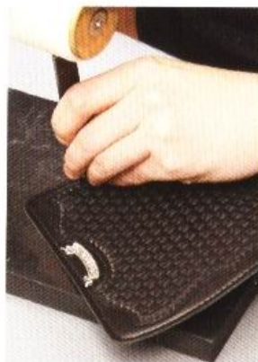
8 沿著拉出的縫線溝槽，使用菱錐製出縫線孔。不過，為了避免讓縫線孔貫穿皮革，鑿孔時輕輕敲打菱錐即可。
