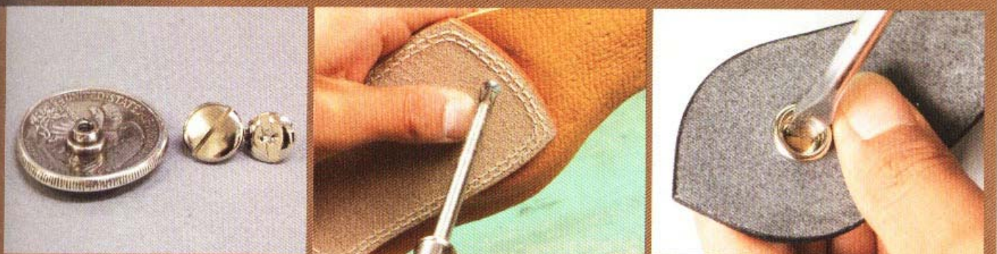
本作品所使用的銀釦，是以麻線通過背面圓環來固定的。但是，也有另一種的銀釦是以螺絲來固定。這些螺絲有十字型也有一字型，也可當做牛仔釦的陰釦，與牛仔釦一起組裝使用。
