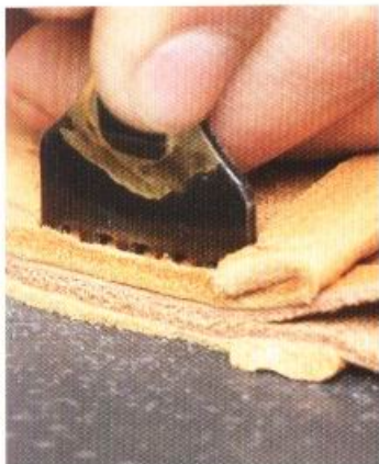
7 接著沿著縫線溝槽以菱斬鑿孔。轉角處則使用2孔的菱斬來鑿孔。由於皮革相當柔軟，鑿孔時須注意不要鑿歪了。
