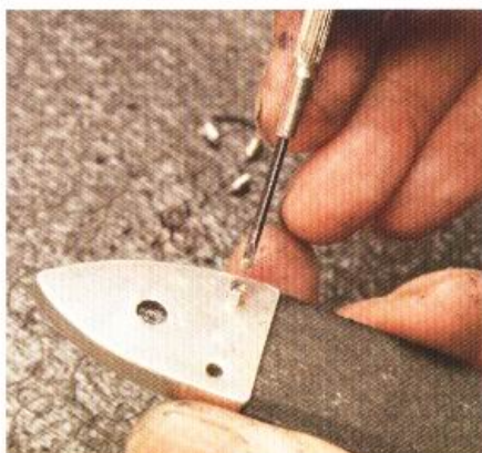
17 將開關帶尾端塞進金屬薄片之中，並將螺絲拴上。
