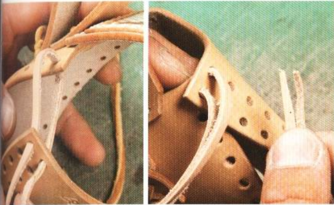
11 由上方開始，以皮線來編織組合袋身。將有兩排洞的皮革當做上層，穿過鹿皮皮線並將皮線拉至左右等長。
