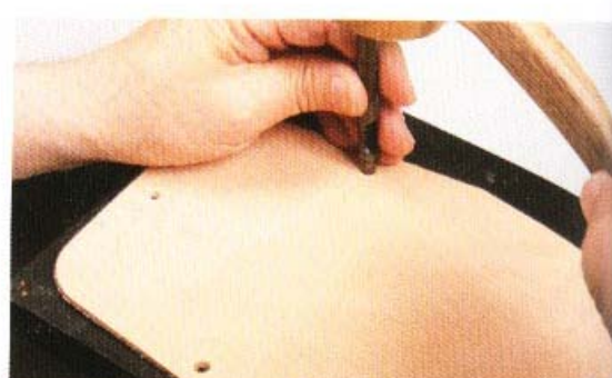
4 裝置銀釦的孔，需要以12號圓斬（2.4mm）來鑿孔。讓鹿皮皮繩通過的孔，則必須以15號圓斬（4.5mm）來鑿孔。
