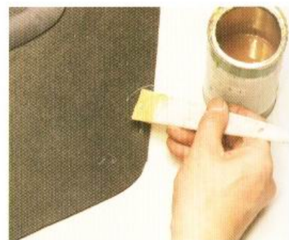
3 將接著劑塗在銀筆所描出的線條內側上。
