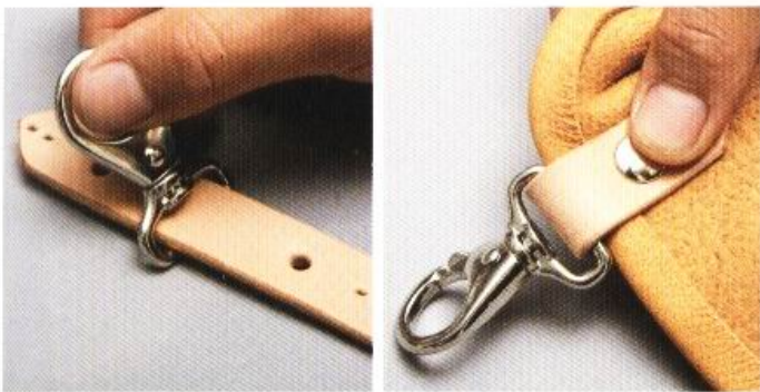
1 將彈簧鉤穿過固定皮，並裝上固定釦。固定皮比較短的那一頭，必須固定在袋身內側。
