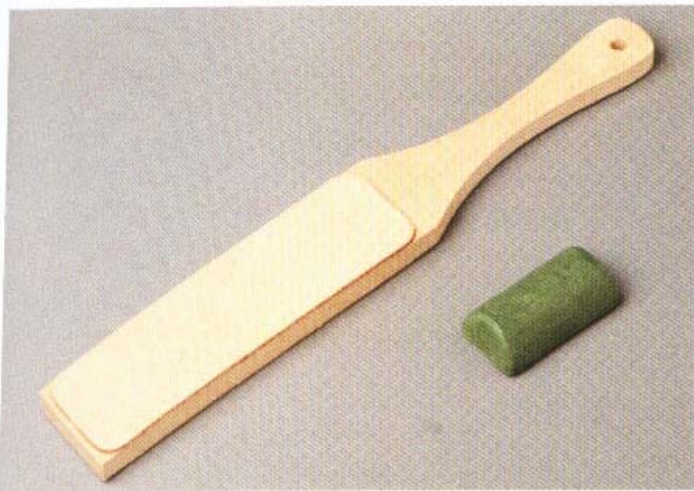
青棒 青棒為刀刃研磨專用的研磨劑。先將磨刀油倒在研磨台上，再將青棒擦在研磨台上後便可以開始研磨刀具。圖中為附有研磨台的青棒。
