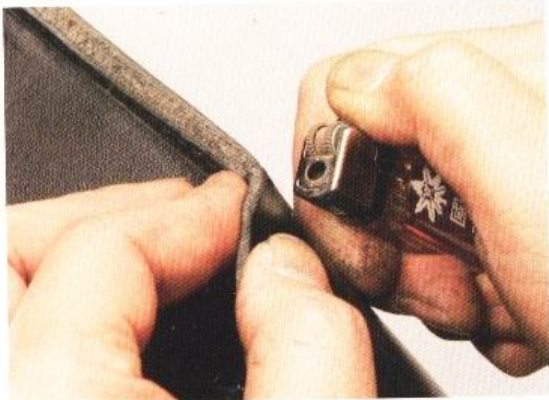
11 縫製完成後留下約2mm長的縫線，再以打火機將縫線燒融後壓平。
