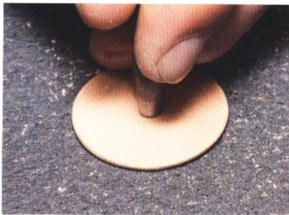
10 使用8號圓斬在銀釦墊皮的的中心鑿孔。墊皮的大小需要配合銀釦的尺寸。
