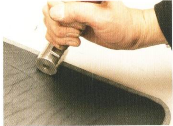
13 將內裡與袋身黏合後，使用滾輪來回滾動。即便是邊緣的部份，都必須以滾輪確實按壓固定。
