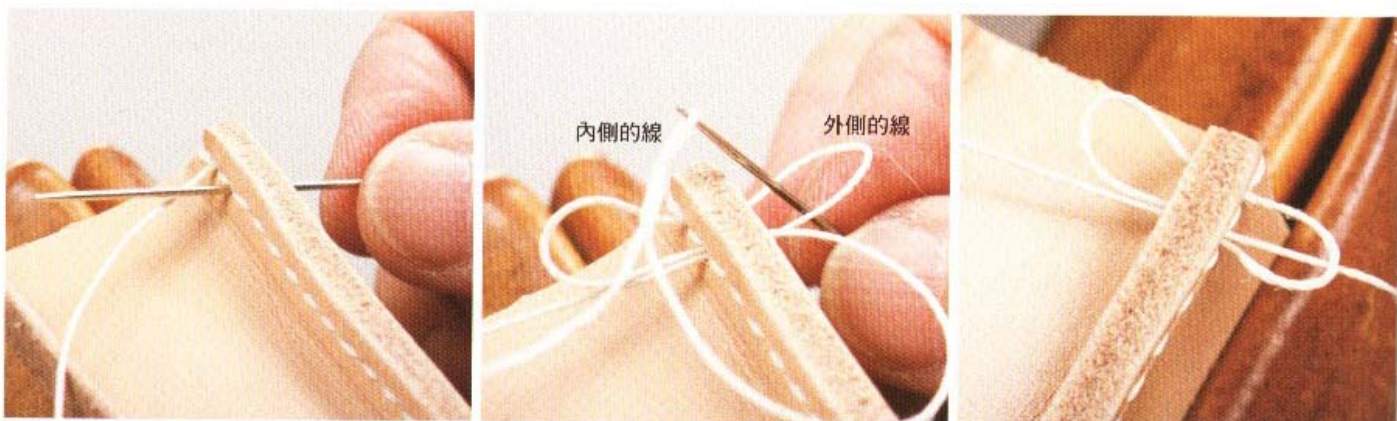
21 接著向後回縫一針。將外側的針穿過縫線孔後，將縫線挑起形成一個圈。將內側的針也穿過縫線孔，並將針穿過線圈。便會呈現最右邊的圖中的情形。如此一來，縫線孔中的縫線便會打成一個結。
