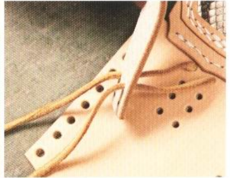
2 由袋身的內側將鹿皮皮線（細）穿過孔洞，將左右兩邊的皮線拉至等長之後，便可穿過上方皮帶環的孔。
