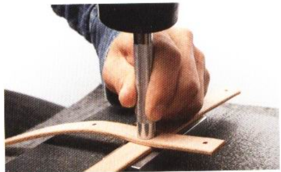
6 接著將皮革放在萬用環狀台上，以固定釦工具(大)敲打固定釦(母釦)。
