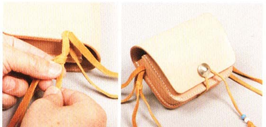
12 最後，將平結的尾端向袋身的方向拉緊即可。如果覺得皮繩太長，可將皮繩修剪至適當的長度。
