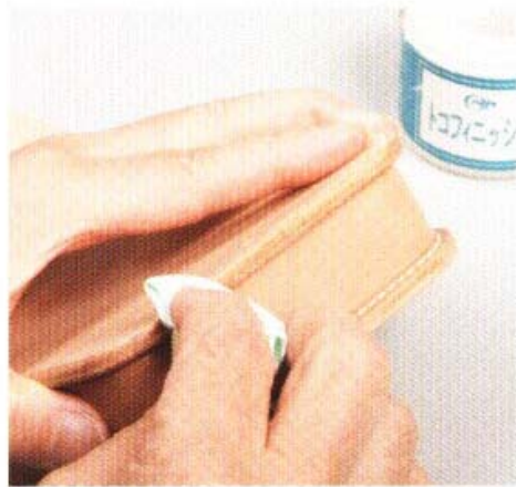
12 以削邊器削去邊緣銳利的線條後，再塗上背面處理劑。
