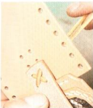
3 將鹿皮皮線（細）以十字交叉的方式穿過皮帶環下方的孔，再由皮帶環的內側穿過上排的孔。
