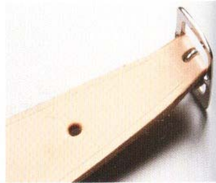
3 如圖中所示，一開始做出記號的那一端，便是開始縫製的起點。而縫線的另一端，便是縫製的終點。
