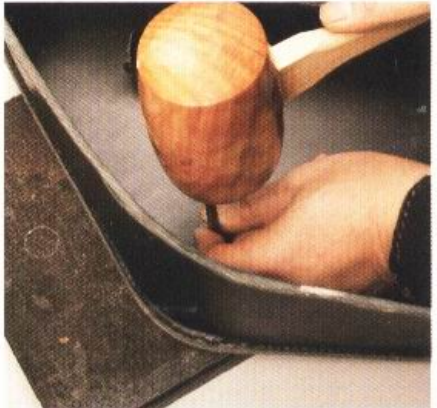
13 決定好裝置皮帶的位置之後，在皮帶與袋身上鑿出裝置固定釦的孔洞。
