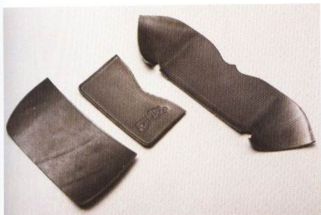
15 圖中為打磨完畢的狀態。其餘的卡片夾層與零錢夾層，也同樣使用步驟8~14的工序來處理。
