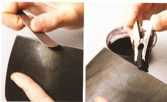
9 使用磨砂棒打磨皮革邊緣，並塗上染劑。使用磨砂棒時，重複來回拉動即可。
