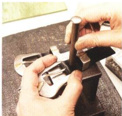
10 在皮帶上裝上固定釦，以固定皮帶扣的位置。裝置固定釦的位置，不能太鬆或太緊。
