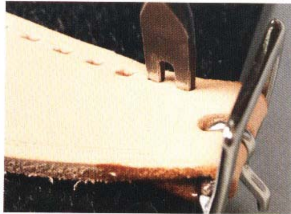
7 鑿孔至轉彎處時須特別小心。為了讓菱斬的刀刃能剛好碰到轉角，鑿孔到轉角時須稍微暫停一下。
