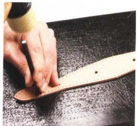
10 接著繼續沿著側邊的縫線溝槽鑿孔。鑿到尾端時，需再一次調整鑿孔的距離。
