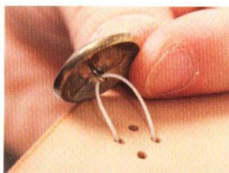
2 經麻線由皮革正面拉出後，穿過銀釦的圓環，再穿進對角的洞。
