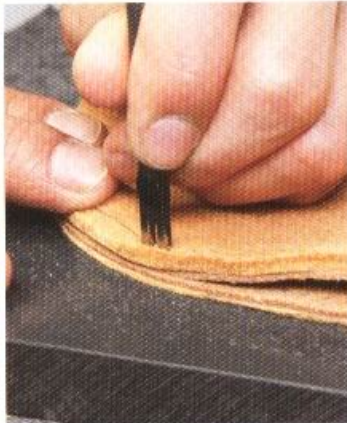
7 接著沿著縫線溝槽以菱斬鑿孔。轉角處則使用2孔的菱斬來鑿孔。由於皮革相當柔軟，鑿孔時須注意不要鑿歪了。
