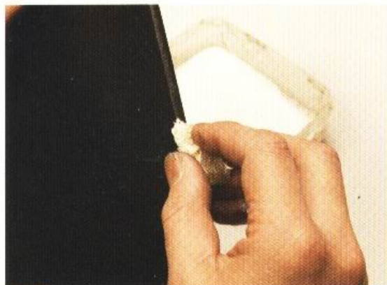
9 塗上背面處理劑後，以絲瓜布來打磨毛邊。塗抹處理劑時須注意勿過量。
