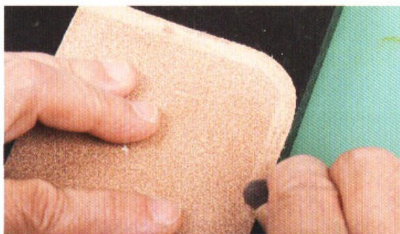
1 以磨砂棒前端1cm的長度，將袋身B的側邊與下緣，也就是預計縫合的部位磨粗。
