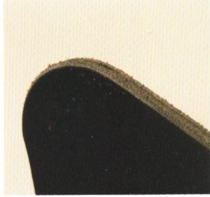
8 使用砂紙或研磨器將邊緣打磨至上圖的狀態即可。
