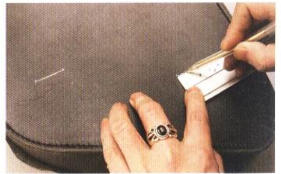
5 為了讓皮帶扣到兩端的距離相等，必須確定左、右兩個皮帶扣裝置的位置是否等距。
