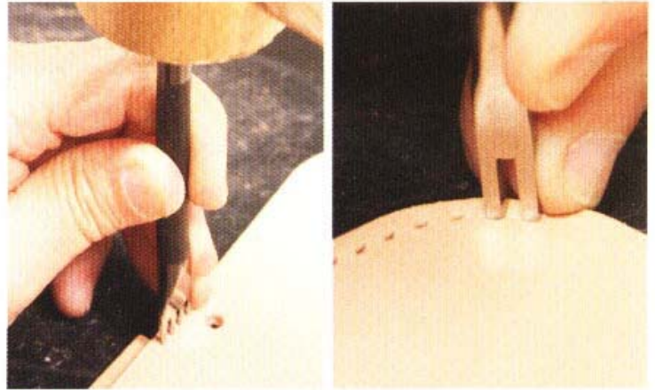
8 以手開間距規沿著邊緣拉線，再以菱斬鑿孔。轉彎處，需使用2孔的菱斬來鑿孔。
