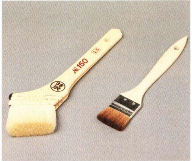
排刷 扁頭油染刷 排刷使用於刷上水性染劑，而扁頭油染刷，則可用於刷上皮革亮光乳液等皮革保護劑。
