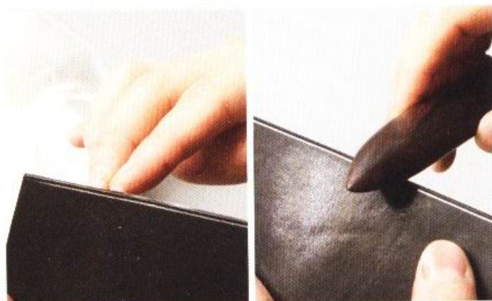
14 接下來在邊緣塗上背面處理劑，並使用木製磨緣器來打磨。第一次打磨此部位時使用的是CMC，第二次打磨時使用的則為背面處理劑。
