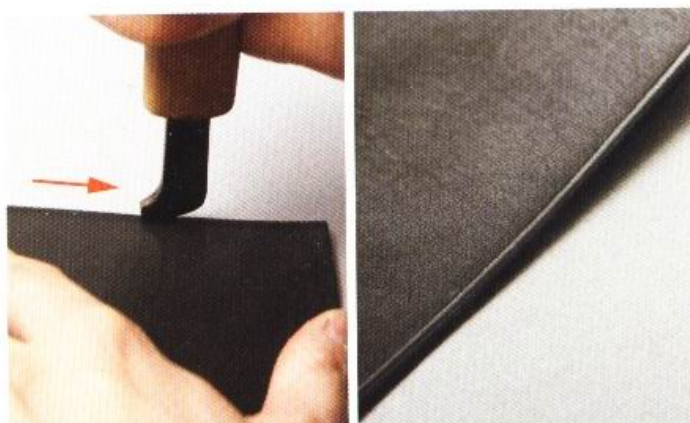
12 與使用拉溝器的方式相同，沿著邊線拉溝。由於裝飾線條拉溝器上的熱度，能讓皮革的纖維凝聚在一起，可以增加皮革的強度。
