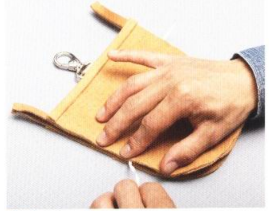
4 一面將袋身邊皮與袋身B黏合，一邊把雙面膠上的紙撕下。
