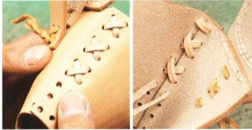
12 將皮線左右交叉編織。由於此處不以線縫製而使用皮線編織，相對之下是較輕鬆的工序。
