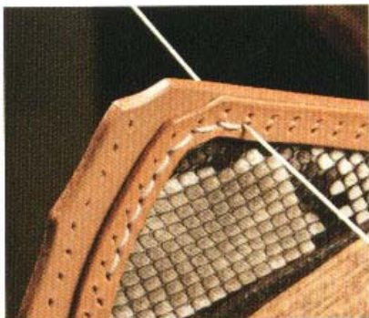
1 因為尾端的三個孔必須重複縫製兩次，為了讓針腳更美觀，起針時由中間點之前的一個孔開始縫製。
