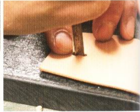
7 固定打火機套的孔，需使用8號原斬（直徑2.4mm）來鑿孔。袋身B上用來穿過原子鉤的孔，則是以8號圖斬與5號圖斬（直徑1.5mm）鑿孔後，再將兩個孔中間以平錐裁開。由5號圖斬所鑿出的孔，是為了避免穿過原子鉤的孔裂開才開鑿的。
