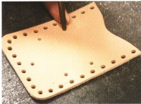
7 固定打火機套的孔，需使用8號原斬（直徑2.4mm）來鑿孔。袋身B上用來穿過原子鉤的孔，則是以8號圖斬與5號圖斬（直徑1.5mm）鑿孔後，再將兩個孔中間以平錐裁開。由5號圖斬所鑿出的孔，是為了避免穿過原子鉤的孔裂開才開鑿的。
