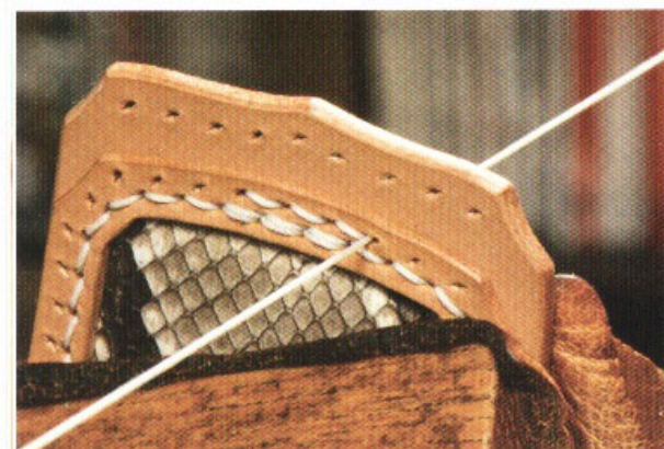
5 接著縫製外圍那一圈。縫製到內圈重疊縫製三個孔的上方時，使重複縫製兩個孔，可增加作品的整齊與美觀。
