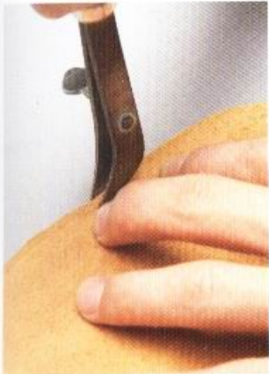
5 以邊線器在離邊緣3mm處拉出縫線溝槽。由於在鹿皮上不容易看清楚拉出的溝槽，可以使用原子筆將溝槽描得清楚一點。
