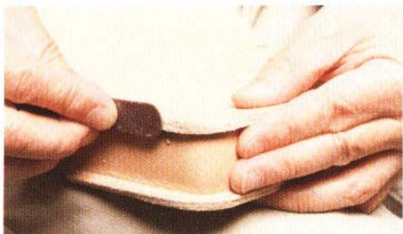
5 使用磨砂棒，打磨黏合後的皮革邊緣。
