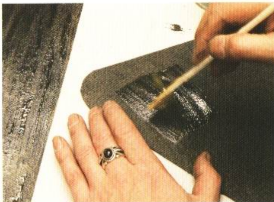
12 由於袋身皮革的背面需要與袋身內裡黏合，所以兩片皮革的背面都需要塗上接著劑。
