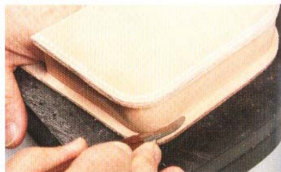
4 將剩下半邊的袋身A與邊皮黏合，再以壓插器壓緊。如果白膠由邊緣滲出，要記得擦掉。
