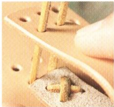
3 將鹿皮皮線（細）以十字交叉的方式穿過皮帶環下方的孔，再由皮帶環的內側穿過上排的孔。
