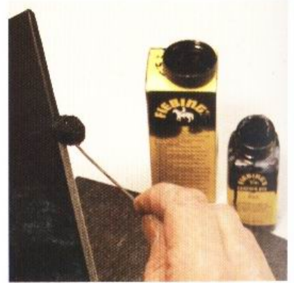
8 使用砂紙或磨砂棒打磨邊緣，再塗上染劑。
