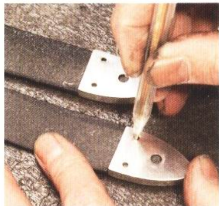
15 將裁切好的開關帶尾端塞進薄片之中，並以銀筆將裝置螺絲的位置標出來。
