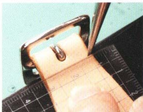
1 在離側邊邊緣3mm處且離對折部位大約1.5cm的部位，也就是反折黏合時重疊的部位上，做出記號。
