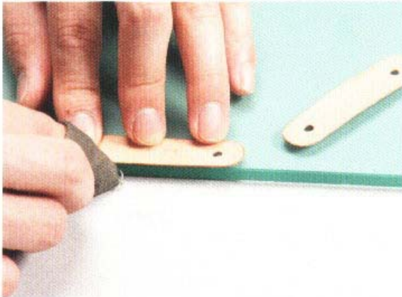
5 以同樣的方式打磨用來固定錶面的皮革。而為了讓邊緣變薄，也必須要進行削邊的工作。
