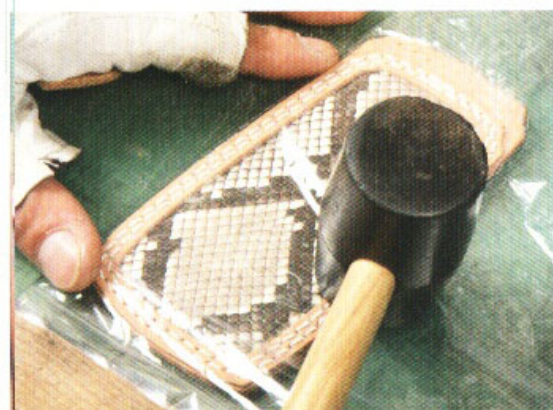
7 墊上一塊塑膠布保護後，再以槌子敲打針腳。
