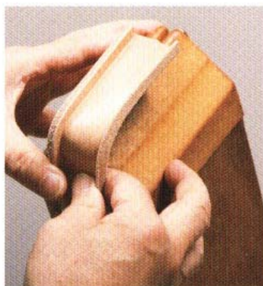
5 以手造木夾或大型手縫固定夾，將袋身夾住固定。
