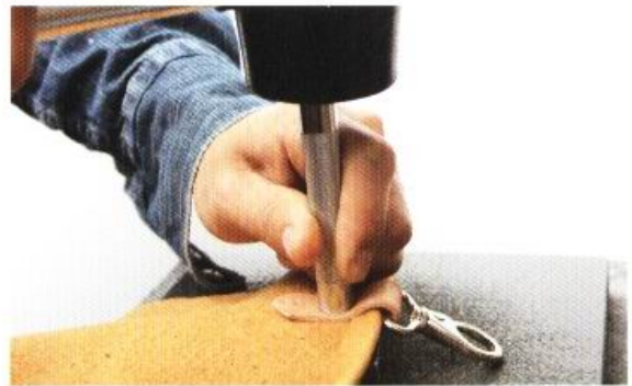
2 在袋身下墊著環狀萬用台，以固定釦工具敲打固定釦。
