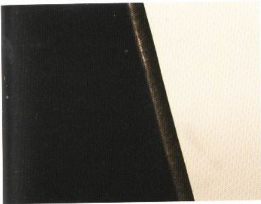
11 圖中為毛邊打磨完成後的狀態。不但看不見皮革黏合的痕跡，而且還呈現出與皮革表面相同的光澤感。
