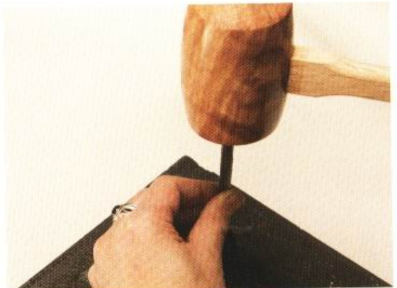
14 使用木槌垂直地敲打菱斬。如果孔鑿歪了，縫線的針腳便會跟著歪斜。
