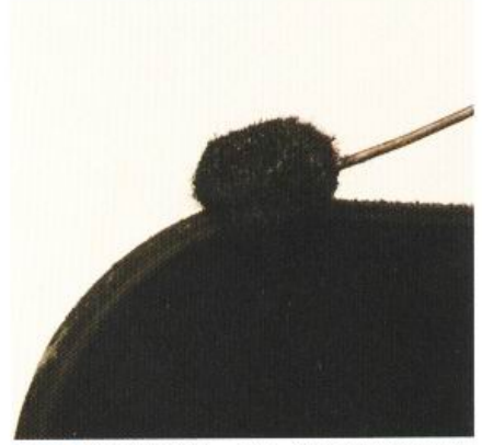
9 將邊緣染色、塗上背面處理劑以打磨皮革。
