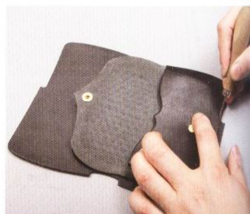
5 將零錢夾層放在袋身B上，在零錢夾層下方做出記號。
