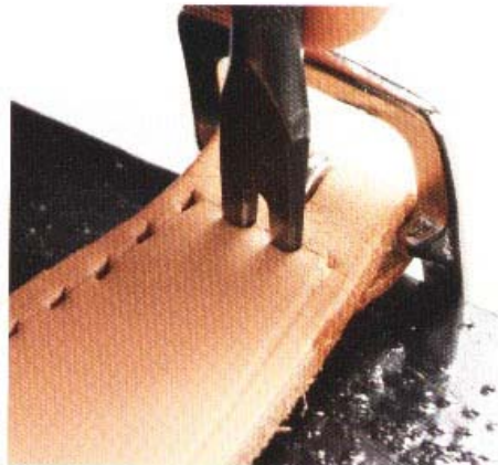
9 決定好位置之後，再確實鑿出縫線孔。由於此處的皮革是兩片皮革重疊在一起，鑿孔時要注意是否確實鑿穿。
