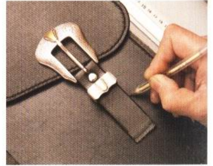
3 決定好皮帶扣的位置之後，使用銀筆在裝置的位置上做記號。
