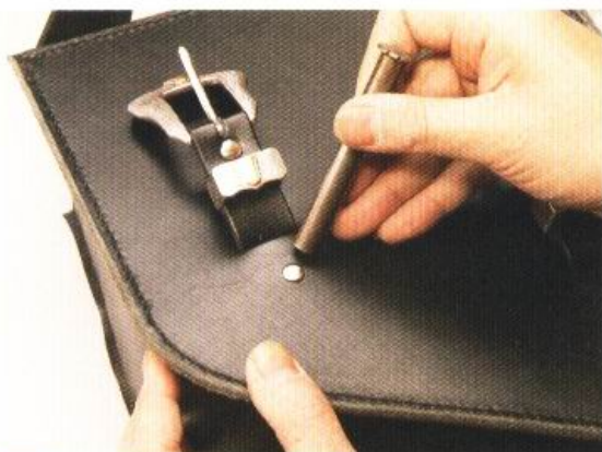
14 將固定釦穿過鑿好的孔，以固定釦工具敲打固定。敲打之前，可以先調整一下工作檯面的高度。
