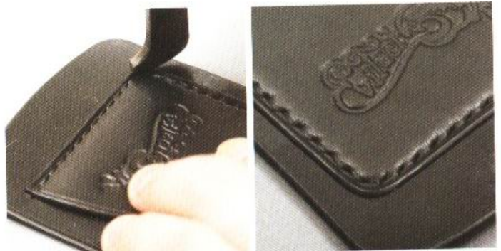
14 與P119的方式相同，使用裝飾線拉溝器將線條拉出。經過裝飾線拉溝器的修飾後，外側的皮革會下沉，讓內側的皮革呈現出立體感。
