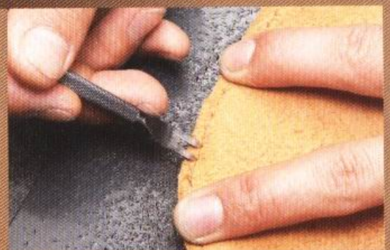
8 在尾端調整菱斬鑿孔的距離時，可以使用2孔的菱斬，慢慢地調整需要鑿孔的位置。
