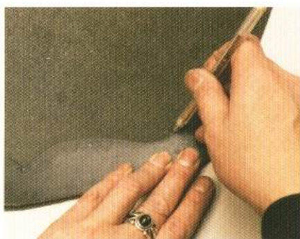
2 將袋緣皮放置在袋蓋上，以銀筆描出袋緣皮的位置。
