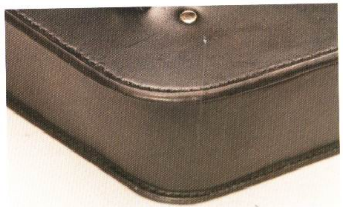
14 圖中為邊緣修飾完成後的狀態。如此一來，袋身的製作便大致完成。接下來，便剩下裝置皮帶等作業了。
