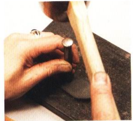
15 將固定皮背面朝上放在橡膠板上，敲打固定釦工具以固定銀釦。
