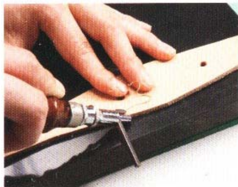
2 接著使用拉溝器，在離側邊邊緣3mm的位置上，繞著整片皮革拉出縫線溝槽。
