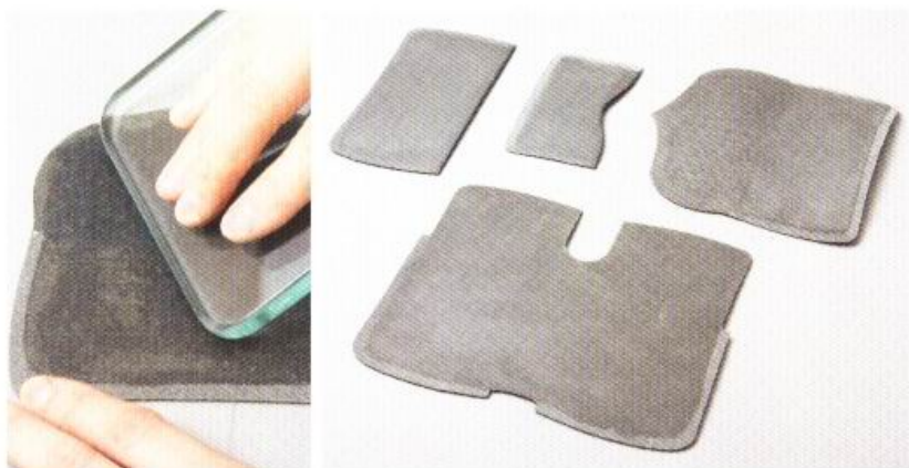
17 塗上背面處理劑之後，以玻璃板沿著皮革的纖維走向打磨。右邊圖片中，除了縫合的位置之外，其餘的皮革背面都已經打磨完畢。
