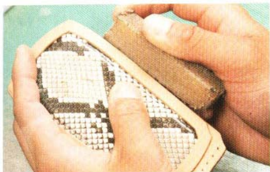
23 使用去膠片（也可使用凝固的橡皮黏膠塊）來摩擦皮革邊緣，將滲出的接著劑刮去。
