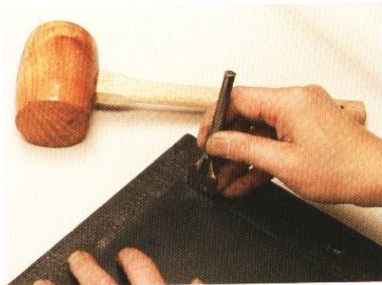
13 將菱斬對齊縫線溝槽之後，沿著溝槽鑿孔。
