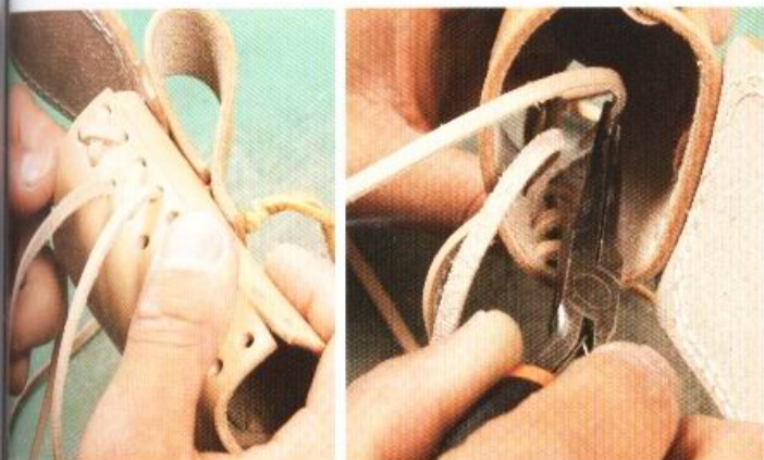
14 由於一側的皮革已經閉合，所以在編織組合另一側的皮革時，皮線會變得不容易穿過。這時便可以使用尖頭鉗等工具來幫忙了。
