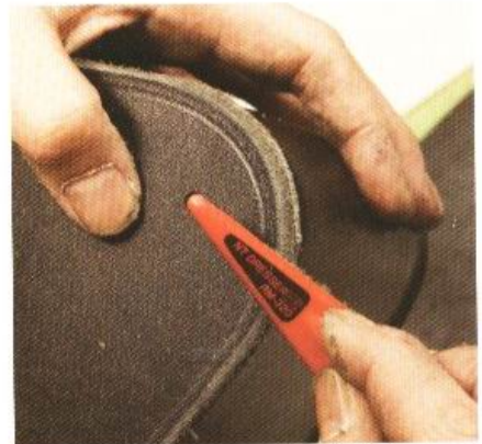
12 此處是以研磨器來打磨邊緣。無論是染色或打磨的工序，都應該在皮革縫合之後再進行。
