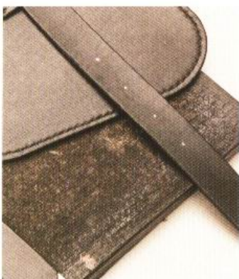
24 由作為基準的孔洞開始，等距離地將鑿孔的位置標示出來。
