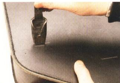
7 在袋身上鑿出一個與皮帶寬度相符的長形孔洞。為了避免鑿歪，一定要確實對齊描線。
