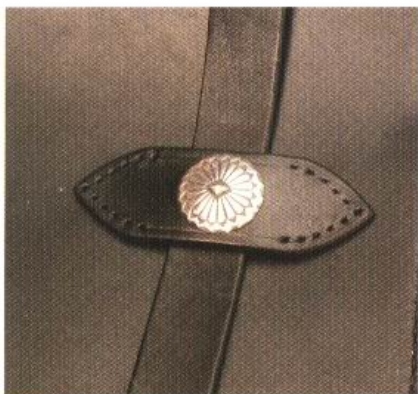
21 圖中為鑿完縫線孔的狀態。由於不需要將開闔帶縫在袋身上，鑿孔時必須避開開闔帶。
