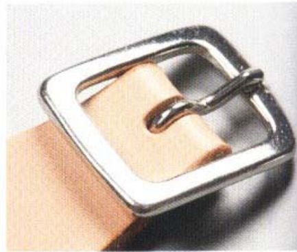
10 裝上帶扣時，要注意方向有沒有顛倒。皮帶鉤需朝向外側。
