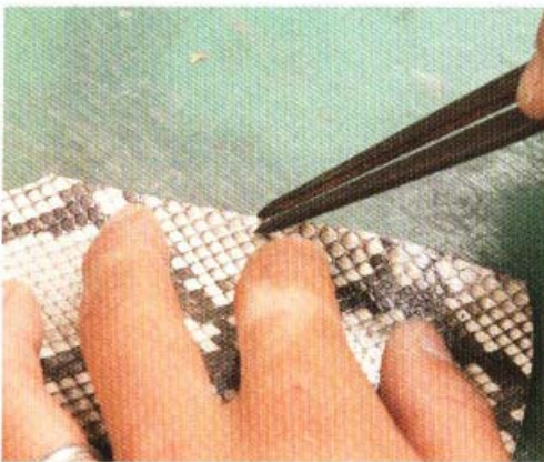
9 由邊緣到外框的中間（約為4mm）的距離，定為手開間距規的寬度，再以手開間距規在蛇皮的邊緣描出線條。
