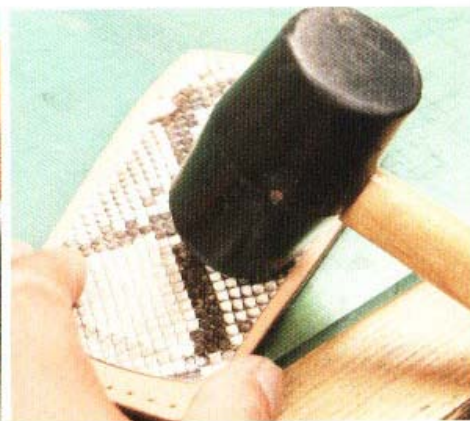
16 使用木製磨緣器摩擦內襯的邊緣，讓蛇皮的凸起變得更明顯。最後，使用槌子確實壓緊黏合部位即可。
