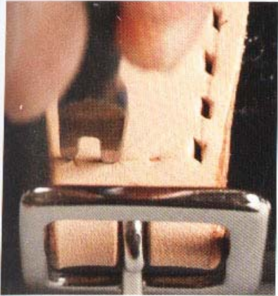
8 鑿孔至這個部位時，可用菱斬在皮革上輕壓出記號，先確定好鑿孔的位置。
