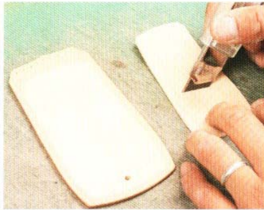
5 將剛剛以錐子刮粗的範圍內側，使用研磨器磨粗。接著再使用美工刀的背面，確實將已經磨粗的區域再刮一遍。內襯的背面則全部刮粗。
