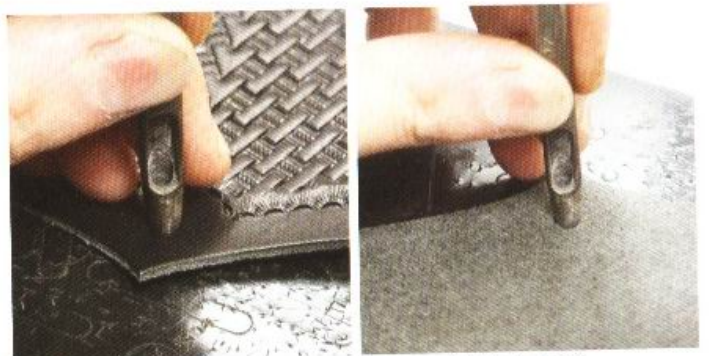
2 在零錢夾層A上以8號圓斬、夾層B上以12號圓斬鑿孔。使用12號圓斬在夾層B上鑿孔時，皮革的正面與反面都需要鑿孔，以求確實鑿穿孔洞。
