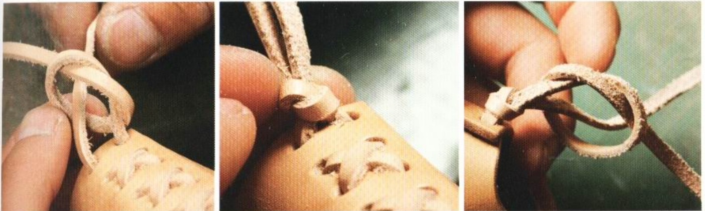
13 最後的處理方式與皮帶環上的皮線相同，拉著一條皮線後以另一條皮線繞行打結。此種編織法，會讓皮線分別交叉於皮革的正面與背面。而為了讓袋身皮革不會繃開，打結的時候需緊貼著皮革。
