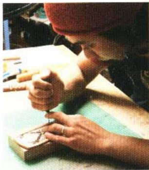
26 做好記號之後，以菱錐將孔洞鑿開。鑿好洞之後，接著準備縫製外周與內周的兩條縫線。
