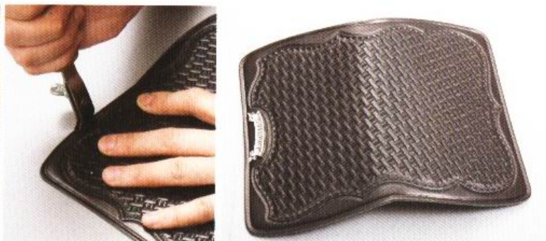
7 在袋身上，離邊緣3mm處做記號，將邊緣到記號的寬度定為邊線器的寬度後，沿著皮革邊緣拉出縫線溝槽。
