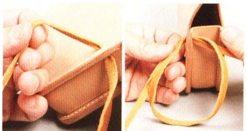
10 將當做背繩的鹿皮皮繩，來回兩次穿過袋身A與邊皮上的孔，以形成一個圈。這個圈圈之後便是背繩的固定圈。
