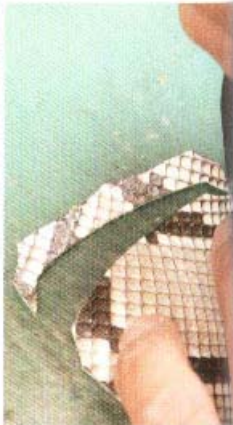
8 因為以袋蓋的紙型來裁切的蛇皮會比外框大，所以接著以錐作出記號，再以裁皮刀將多餘的蛇皮裁下。
