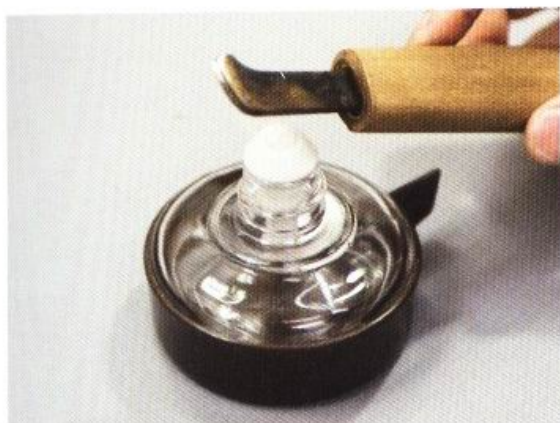
11 將酒精燈點火之後，加熱裝飾線條拉溝器。但加熱過頭會讓皮革出現燒焦的情形，不得不注意。
