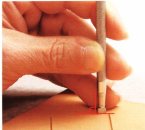
1 將想要呈現立體感的地方移到面前，打邊印花緊緊地貼合在切割的線上。
