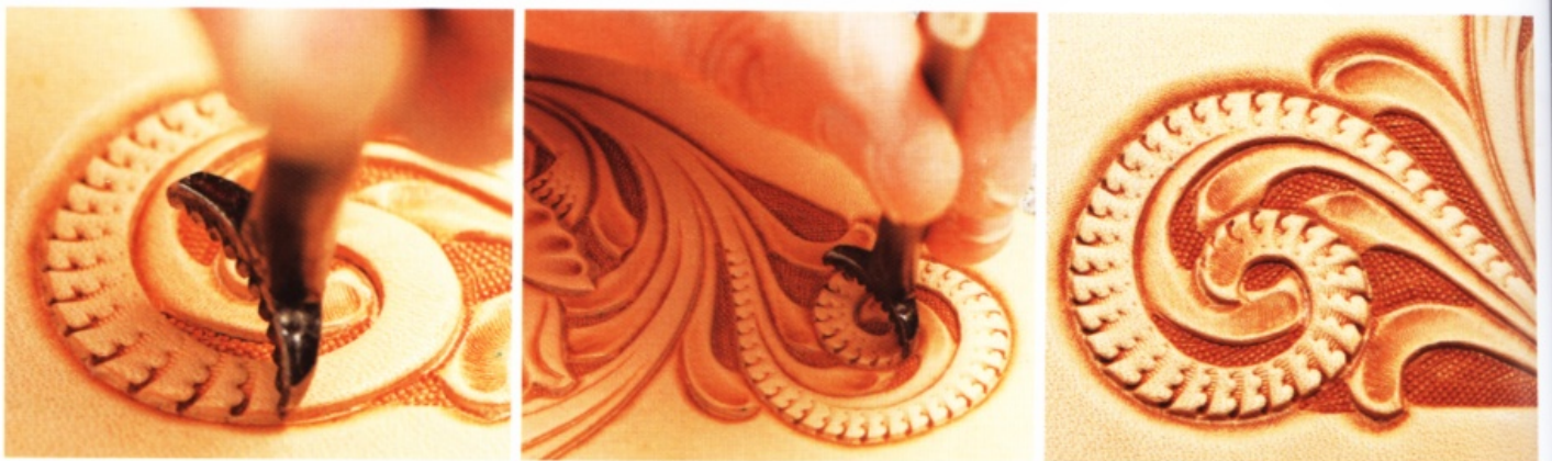
3 在渦卷形裝飾打上葉脈印花，印花要稍微傾向外側，等間距地敲打葉脈印花。因為曲線比較狹窄的關係，所以要一邊一點一點地改變皮革的方向，一邊打上印花。
