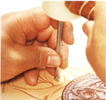
4 在下面線條也打上打邊印花，線條重疊的部分打上F941印花。
