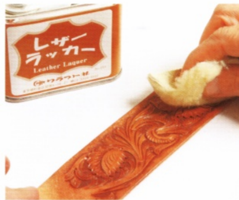
油料確實地浸透之後，在油料上面塗上皮革亮光漆，如果塗太厚的話容易龜裂，所以請小心塗抹。
