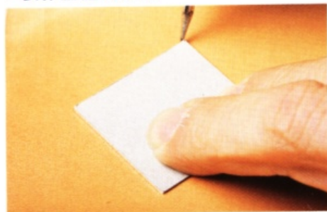
1 在大理石上放置含有大量水分的皮革和紙型，利用描寫筆畫出紙型的輪廓線。
