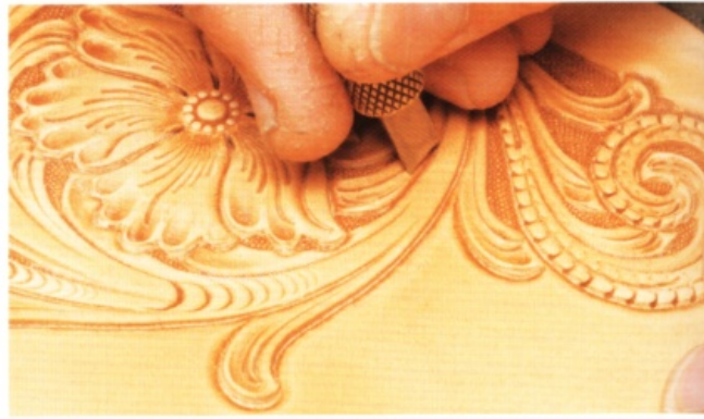
6 花莖的尖端配合線條來切割出長長的線條，再配合長線條切割出短線條。因為切割的地方比較硬，所以刀頭會不容易切入。
