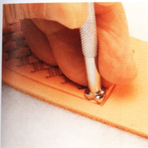
邊框印花要配合輪廓筆直地敲打，請小心不要和輪廓的線重疊到。
