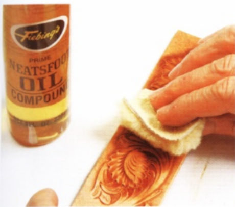
使用羊毛片確實地塗上牛腳油。
