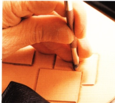
2 用網狀花紋的打邊印花在刻印的部分打上網狀花紋的陰影印花，表現出統一感。和平紋的陰影相比，更可以強調陰影並呈現出立體感。
