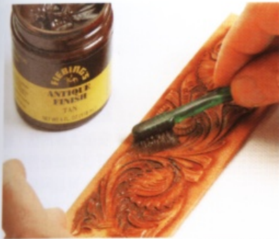
4 在皮革亮光乳液的上面，用牙刷塗上油質染料。
