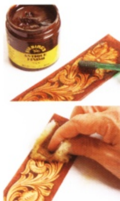
用牙刷塗上油質染料，在油質染料乾掉之前，再用廢布料擦掉油質染料即可。這裡也可以用羊毛片來擦。
