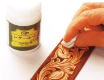
3 塗上染料之後，再用廢布料沾上皮革亮光乳液，將皮革亮光乳液確實地塗在皮革上。
