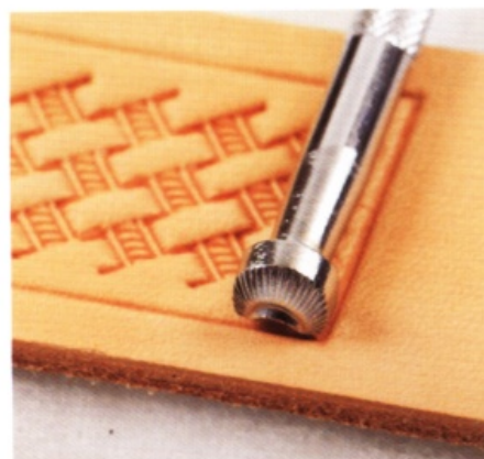
18 為了要淡化邊緣，在輪廓的內側打上D435印花的邊框印花。
