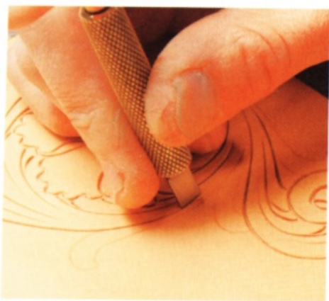
16 花卉四周的花莖切割完畢之後，再將剩下來的花莖全部切割。必要的時候，改變皮革方向，就可以切割出滑順的線條。
