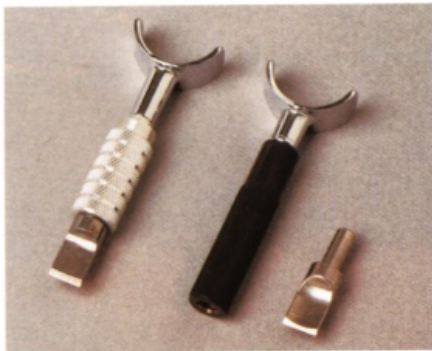
初學者用旋轉雕刻刀／專家用旋轉雕刻刀柄／ 專家用旋轉雕刻刀的替換刀頭 切割輪廓時所使用的雕刻刀，是皮雕的基本工具。
