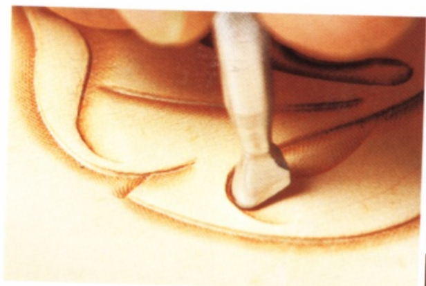
這個打邊印花是沿著R線的內側，在打上基本打邊印花的地方做敲打的動作。
