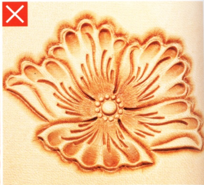
4 左邊是完成最後修飾的花卉，右邊的花卉是最後修飾失敗的例子。失敗的每條切割線的方向變得很凌亂；若是切割線全部往中心方向切割的話，就可以漂亮地匯集起來。
