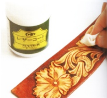
5 擦乾油質染料之後，再次塗上皮革亮光乳液。
