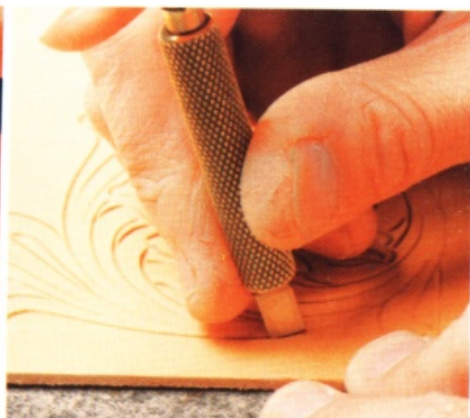
16 花卉四周的花莖切割完畢之後，再將剩下來的花莖全部切割。必要的時候，改變皮革方向，就可以切割出滑順的線條。
