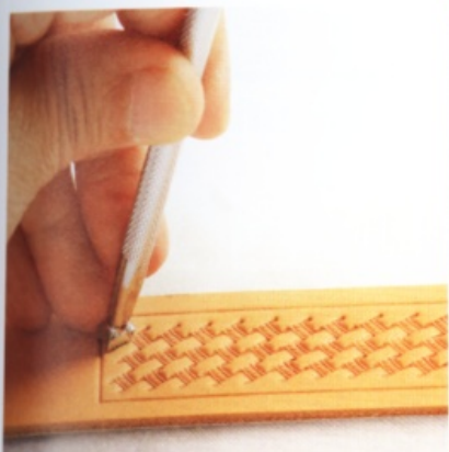
17 如果印花和邊線交集到的時候，請盡量不要重疊到印花和邊線，這時需將印花工具傾斜，只用半邊的印花工具敲打。
