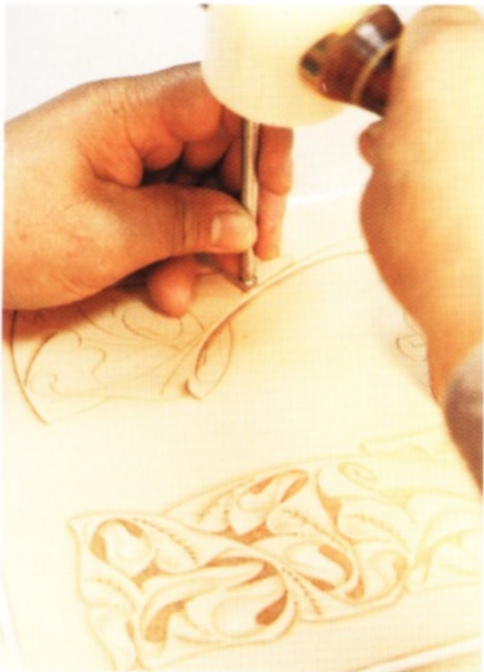
2 在用旋轉雕刻刀切割出來的線條上打上打邊印花。
