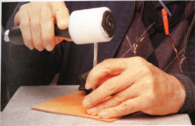
2 打邊印花每次滑動1~2mm，用Pu頭木槌垂直地敲打。Pu頭木槌不需要太用力，用相同的力氣連續敲打之後就可以漂亮地完成了。
