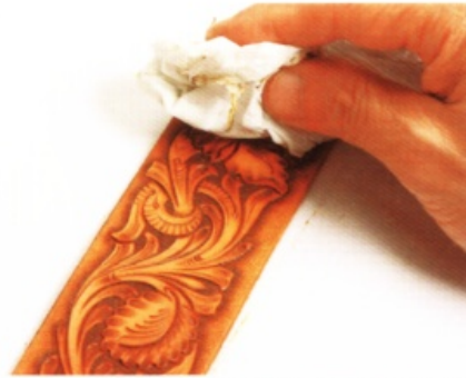
5 在油質染料乾掉之前，用廢布料或羊毛片擦掉油質染料。
