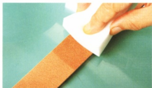
1 濕潤要施行敲打的皮革光滑面。
